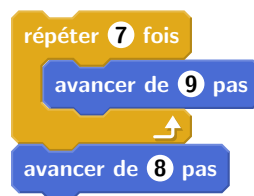
FIGURE 4.11 – Code d'une boucle d'addition en Scratch.
