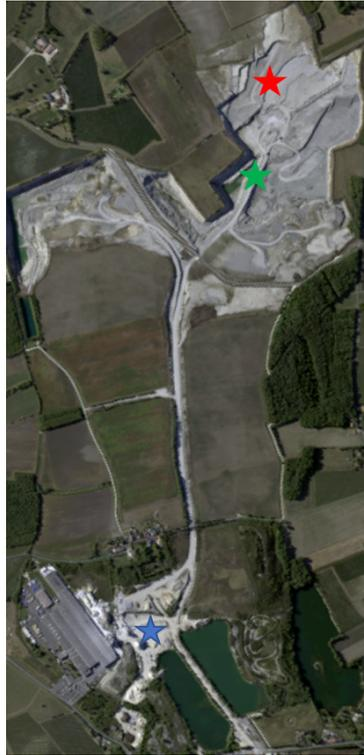
FIGURE 7.1 – Image HySpex acquise au-dessus de la carrière de Cherves-Richemont (composition colorée à partir des canaux spectraux associés au rouge, au vert et au bleu). Les étoiles indiquent la localisation des pixels dont les spectres sont analysés Sect. 7.3 : gypse (rouge), calcite (bleu), mélange gypse-calcite (vert).
