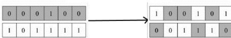
FIGURE 2.11 – Croisement uniforme : Pour sélectionner les gènes de chaque parent pour former une progéniture, l'opérateur lance une pièce de monnaie équitable à chaque position du chromosome.
