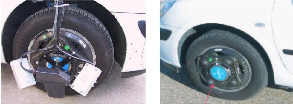
**Figure 1.2.** Exemples des méthodes de mesure directe des paramètres d'état du véhicule. [Gauche] Capteur pour la mesure de la vitesse latérale développés par l'ENSEEIH. [Droite] Capteur de force installé dans la roue [Doumiati et al. \(2010\)](#).
