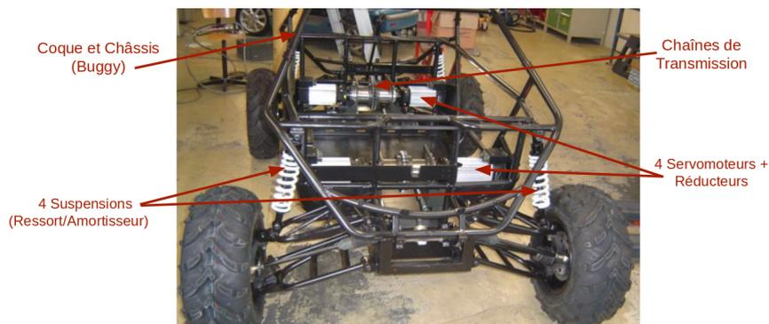
**Figure A.5.** L'architecture mécanique de la plateforme expérimentale “*SPIDO*”.
