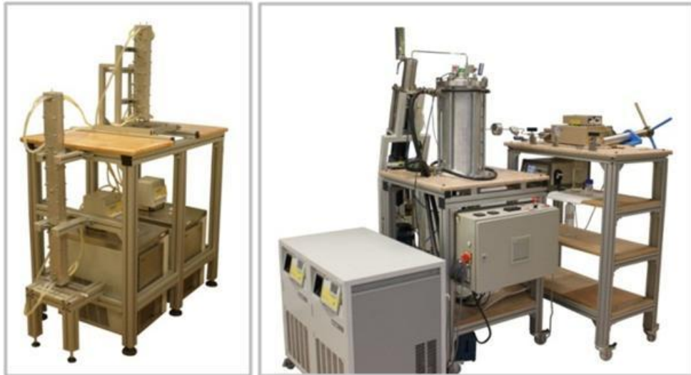
Figure 3.10: TGC parallélépipédiques (à gauche) et cylindrique haute pression (à droite) toutes équipées avec cinq points d'échantillonnage.
