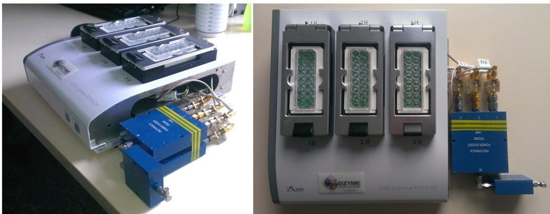
**Figure 17** : Vue de face et de côté du système XCelligence modifié afin de permettre de délivrer des CEM aux différentes plateformes de mesure.
