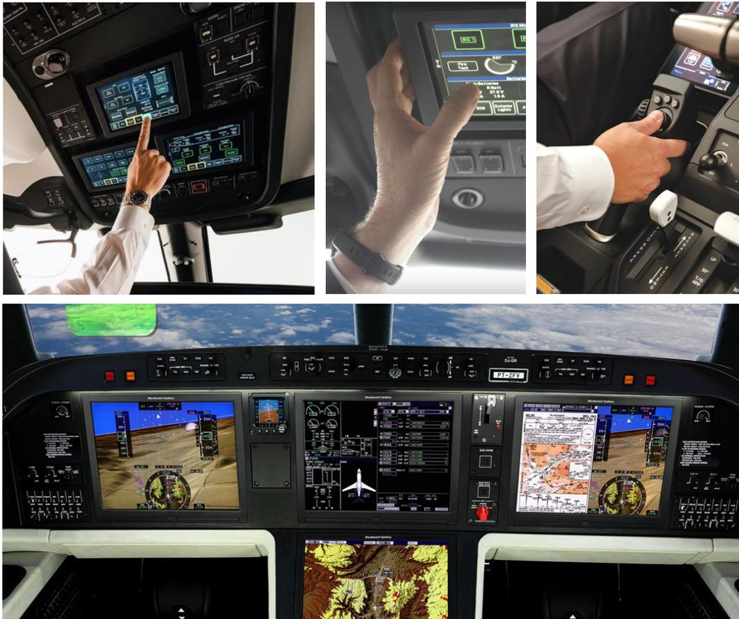
Figure 18. Rangée du haut, Symmetrie Flight Deck par Gulfstream basé sur la série Primus Epic de Honeywell, certifié en 2014 par la FAA pour le Gulfstream G500, un avion d'affaire à deux pilotes (à gauche, une vue d'ensemble ; au milieu, détail sur les rebords pour saisir la surface ; à droite, une commande de contrôle physique des MFD). Rangée du bas, Pro Line Fusion par Rockwell Collins, certifié en 2014 par la FAA pour le Legacy 500, un avion d'affaire à deux pilotes.
