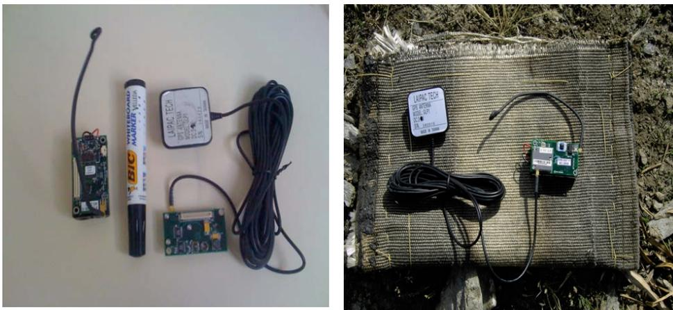
*Figure 22 : Capteurs MicaZ de la société MEMSIC / Capteurs avec protection thermique Zetex et laine céramique*
