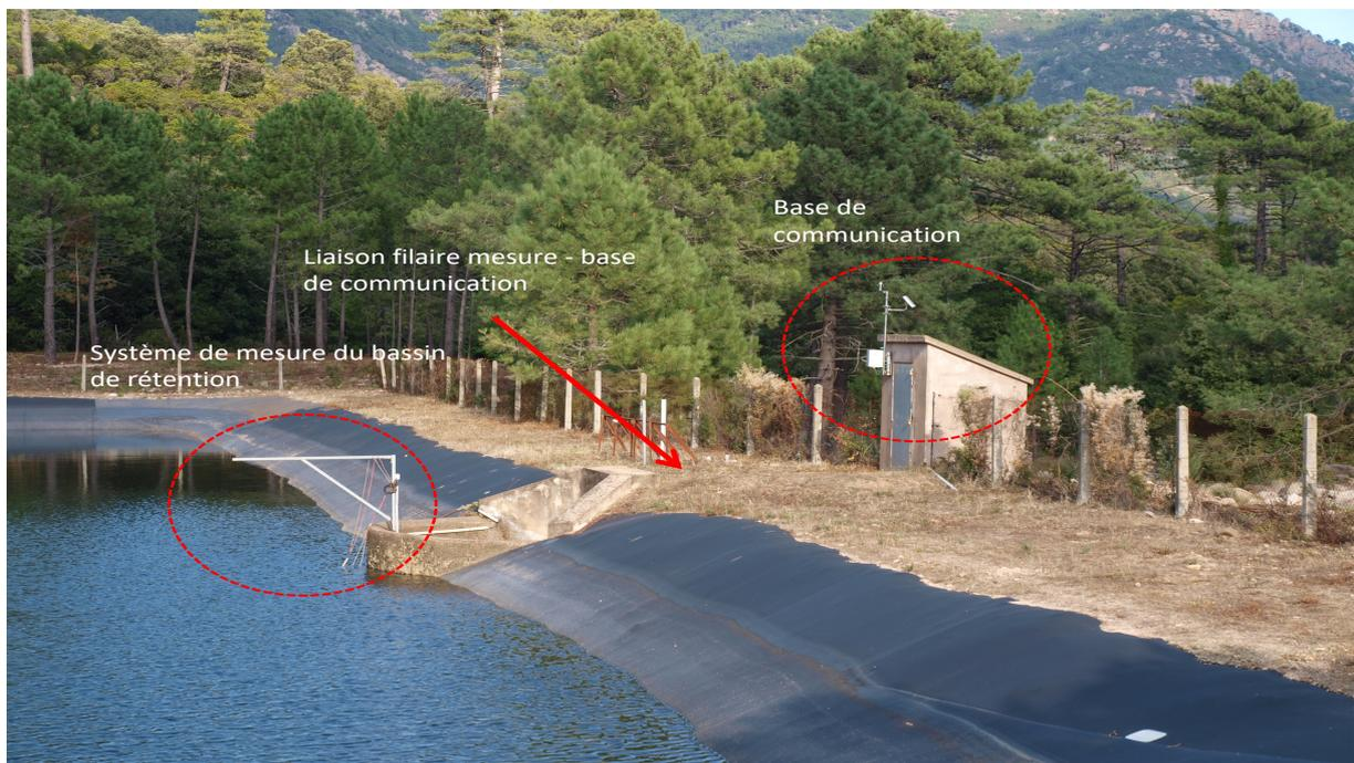
Figure 33 : Point de mesure de niveau et de qualité de l'eau dans bassin
