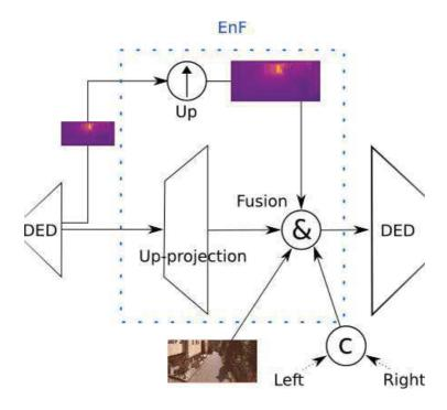
FIGURE 7.8 – Détails du module Expand and Fuse (EnF)
