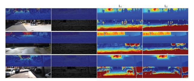
Figure 6.9 – Prédictions de confiance  $\mathbb{L}_1$  et  $\mathbb{L}_2$ . Les deux colonnes de gauche contiennent les données d'entrée : vérité terrain, scan LiDAR, masque binaire. L'image RGB est également affichée comme un support visuel mais elle n'est pas utilisée dans nos réseaux ici. Les deux colonnes de droite contiennent les prédictions basées sur les normes  $\mathbb{L}_1$  et  $\mathbb{L}_2$  : estimation de profondeur en haut et estimation de confiance en dessous
