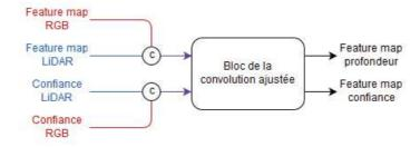
FIGURE 6.7 - Schéma de la fusion par concaténation des descripteurs RGB et LiDAR
