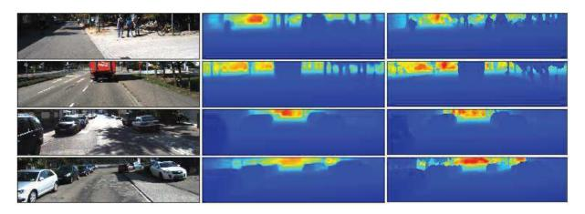
FIGURE 6.14 – Comparaison qualitative des résultats d'estimation de profondeur monoculaire avec ceux de la complétion simple. L'image RGB correspondante aux prédictions à gauche, l'estimation de profondeur monoculaire au milieu et la complétion de profondeur issue d'un scan LiDAR à droite
