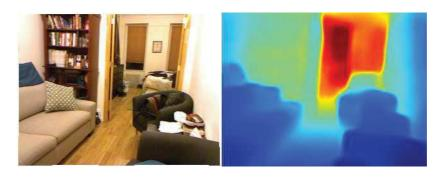
FIGURE 4.1 – Exemple d'inférence de profondeur monoculaire au niveau de l'état de l'art, entraînée avec un CNN multiéchelles.
