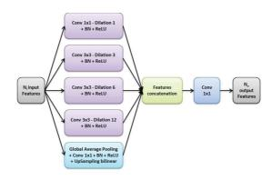
FIGURE 4.10 – Le bloc 'ASPP' (adapté de (Chen et al., 2017)), avec une pyramide de 1, 3, 6 et 12 convolutions dilatées. BN dénote la 'Batch Normalization'.
