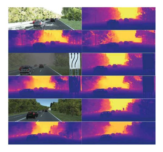
FIGURE 7.10 – Illustration des résultats de notre meilleur modèle sur Virtual KITTI. Pöur chaque image de test on trouve : en haut à gauche une des images RGB donnée en entrée; en haut à droite la vérité terrain de profondeur plafonnée à 80m; en bas à gauche la prédiction par le réseau de Laina et al. (2016); en bas à droite la prédiction de notre modèle
