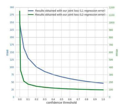
Figure 6.10 – Évolution de l'erreur en fonction du seuil de confiance choisi. La rmse est calculée pour l'implémentation entraînée avec une  $\mathbb{L}_2$  dans la fonction de coût jointe et la MAE pour l'implémentation basée sur la  $\mathbb{L}_1$
