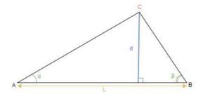
Figure 2.3 – Principe de triangulation. Pour connaître la distance d du point C observé, il suffit de connaître la distance L entre deux points A et B connus ainsi que les angles  $\alpha$  et  $\beta$  qu'ils forment avec C. On calcule par trigonométrie que  $L = \frac{d}{\tan \alpha} + \frac{d}{\tan \beta}$  et il est alors facile de déduire d
