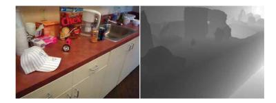
FIGURE 1.2 – Exemple d'une paire d'images  $\mathcal{RGB}$ - $\mathcal{D}$ . À gauche l'image  $\mathcal{RGB}$  et à droite la carte de profondeur  $\mathcal{D}$  correspondante. On peut la considérer comme une image en niveau de gris ou les valeurs des pixels correspondent à leur distance au capteur. Ici plus la distance est grande plus l'intensité lumineuse du pixel est élevée.
