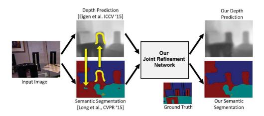
FIGURE 2.9 – Schéma de l'algortithme de fusion proposé par Jafari et al. (2017) pour améliorer conjointement l'estimation de profondeur et la segmentation sémantique d'une image
