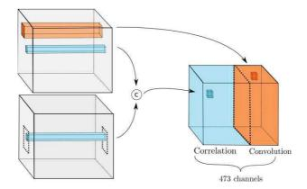
FIGURE 7.7 – Détail de la couche de corrélation constituée du produit scalaire entre les descripteurs des deux images. Le nombre de descripteurs de sortie est arbitrairement fixé à 473, quelle que soit la taille de la corrélation; les descripteurs supplémentaires sont monoculaires et proviennent du résultat d'une convolution sur les descripteurs d'une des deux branches.
