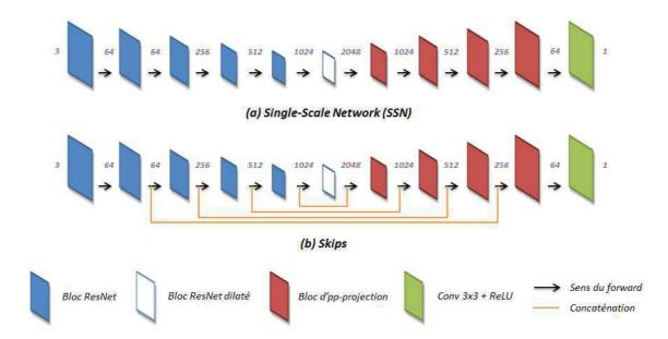
FIGURE 4.6 - Schéma des architectures SSN et Skips.
