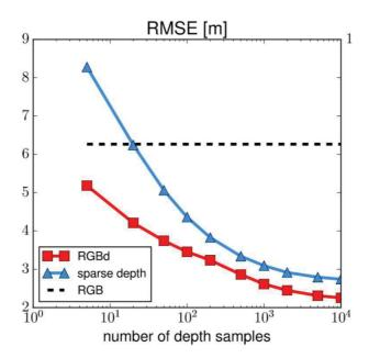
FIGURE 6.13 – Erreur rmse en fonction du nombre de points de profondeur pris en compte pour un réseau avec des entrées RGB seules (en pointillés), un réseau avec des entrées RGB+D (en rouge) et un réseau avec des entrées de profondeur uniquement (en bleu)
