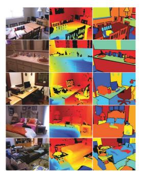
FIGURE 2.10 – Exemples d'image RGB, de carte de profondeur brutes et de labels sémantiques issus du dataset NYU Depth v2.
