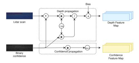
FIGURE 6.5 – Notre convolution ajustée. Nous schématisons ici la première convolution ajustée du réseau qui prend donc en entrée un scan LiDAR et un masque binaire indiquant l'emplacement des pixels valides du scan LiDAR
