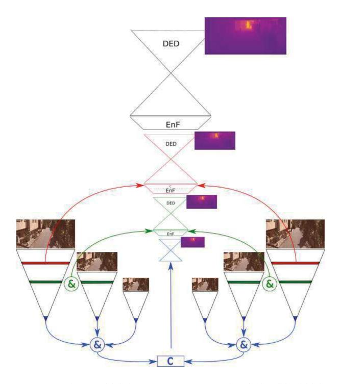
Figure 7.6 – Architecture globale du réseau MSDOS : estimation de profondeur d'abord globale puis locale à l'aide d'un encodage pyramidal. Des opérations de corrélation sont effectuées à plusieurs résolutions (en bleu, vert et rouge sur la figure) et intégrées successivement dans les modules EnF (Expand and Fuse) correspondants. Le symbole '&' est utilisé pour représenter la concaténation des descripteurs et 'c' est utilisé pour représenter l'opération de corrélation
