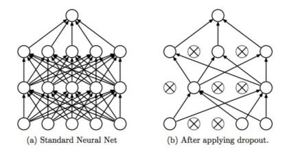
Figure 3.8 – Régulation par 'dropout' avec la méthode proposée par Srivastava et al. (2014)
