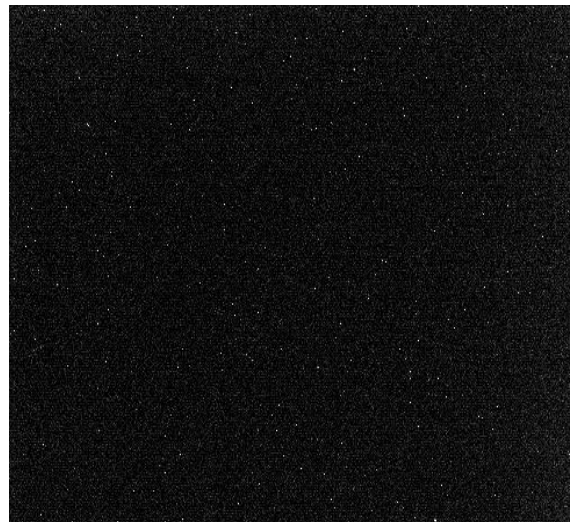
Figure 17 : Exemple d'image prise dans l'obscurité à une température de 252 K et un temps d'exposition de 20 s. Les points blancs sont les pixels chauds [Wid02].
