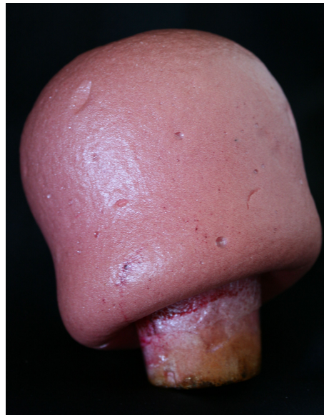
Fig. 5.1 – Photographie de la mousse de polyuréthane fabriquée au Palais de la Découverte. Contrairement aux échantillons sur lesquels nous travaillons, fournis par FoamPartner, cette mousse est très inhomogène (grande variabilité des tailles de bulles, défauts de surface) en plus d’être très rigide. Le mélange d’isocyanate et de polyol dans le gobelet en plastique a moussé puis s’est solidifié dans cette forme champignonesque (tout en restant solidement fixé au gobelet que l’on voit en bas). La formulation chimique est donc essentielle pour obtenir le type de mousse désiré.
