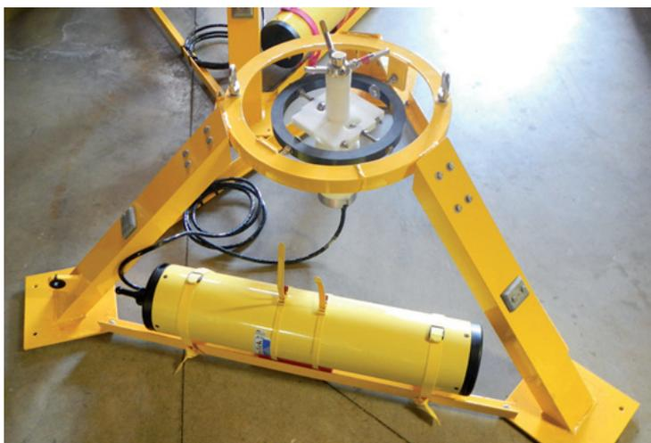
Figure 64 : L'ADV de PIGARUN utilisé pour la campagne de mesures
