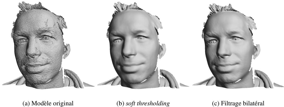
**Figure 5.15** – Débruitage géométrique d'un modèle scanné.
