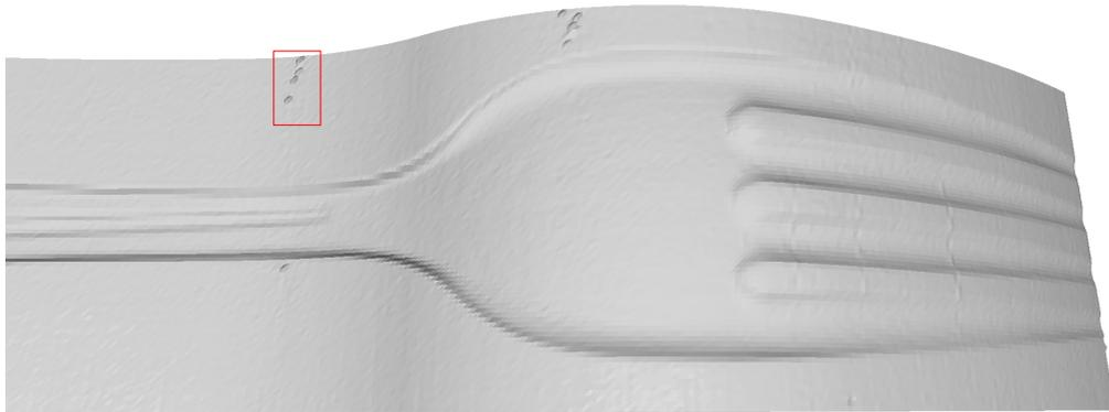
**Figure 5.2** – Exemple de modèle scanné (84 000 faces) comportant un bruit impulsif.
