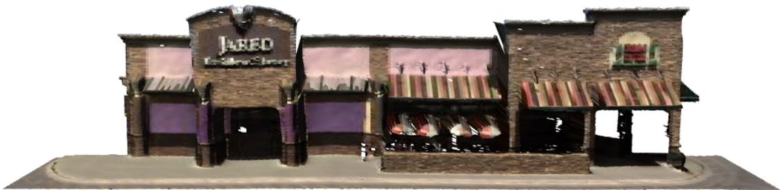
**Figure 2.12** – Un exemple de bâtiment scanné par le système RIEGL LMS-Z210.
