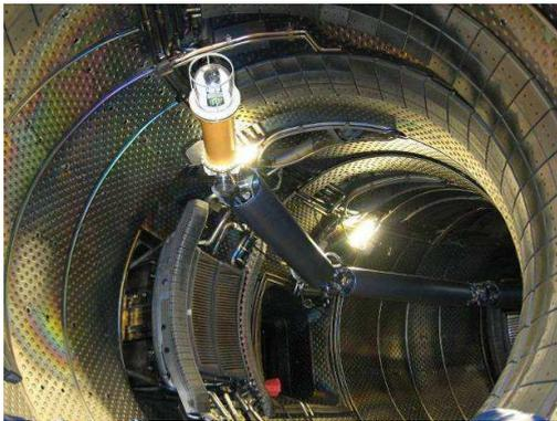
FIGURE 2.8 – Robot manipulateur flexible d'inspection nucléaire AIA GARGIULO et collab. [2008]. Ce robot mesure 8 mètres de long et possède 8 degrés de liberté pour une masse de 150kg.
