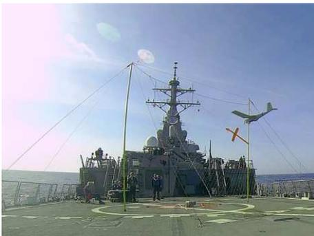
FIGURE 1.3 – Récupération d'un UAV dans un filet. Source : Business Wire.
