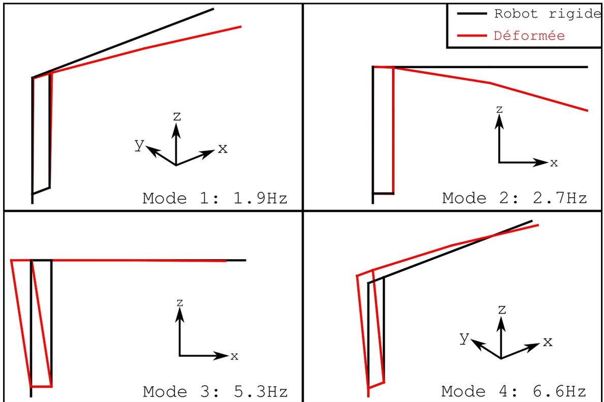
FIGURE 3.20 – Modes propres obtenus à partir des vecteurs propres et valeurs propres de la matrice  $\mathbf{M}_{uu}^{-1}\mathbf{K}_{uu}$ . Les déformées modales sont représentées en rouge, le modèle rigide équivalent en noir.
