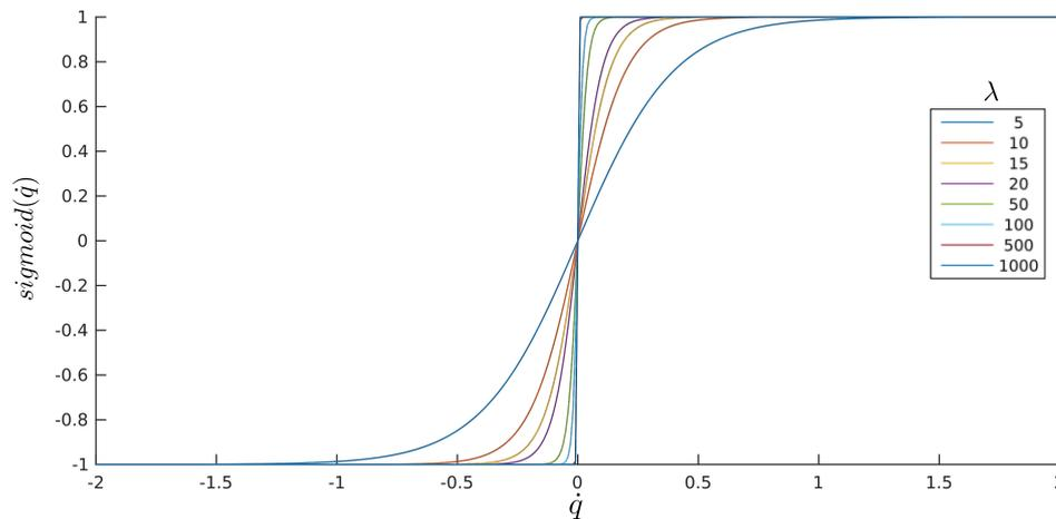
FIGURE 3.6 – Influence du paramètre  $\lambda$  sur la sigmoïde  $2 \left( \frac{1}{1+e^{-\lambda q}} \right) - 1$ . La sigmoïde s'apparente d'autant plus à une discontinuité que le paramètre  $\lambda$  est grand.
