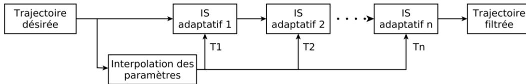
FIGURE 4.12 – Schéma d’Input Shaping adaptatif proposé : les fréquences propres sont calculées à partir de la trajectoire entrante et d’un modèle d’interpolation pour régler en temps réel les paramètres des différents blocs d’Input Shaping adaptatif.
