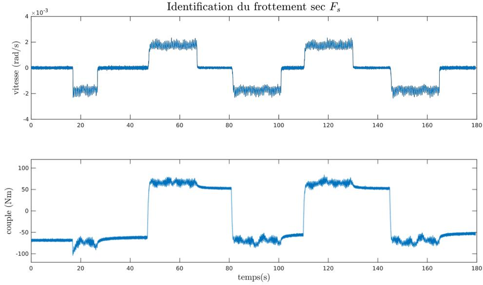
FIGURE 3.10 – Identification du frottement sec d'un actionneur du robot YAKA : l'actionneur est mis en mouvement à vitesse très faible pour isoler le frottement sec du frottement visqueux. L'opération est répétée dans les deux sens de rotation pour identifier une éventuelle assymétrie.
