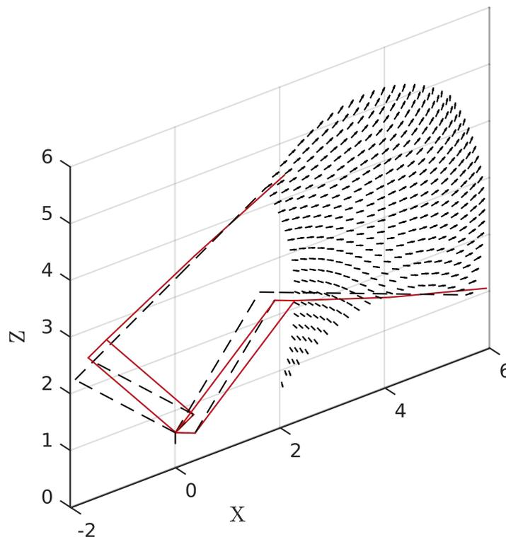
FIGURE 3.22 – Illustration des informations pouvant être issues du modèle : évolution du vecteur propre du 3<sup>ième</sup> mode propre du robot YAKA (seule la composante de déplacement cartésien en bout de bras est représentée).
