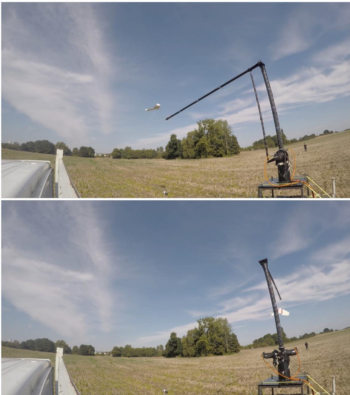
FIGURE 6.7 – Démonstration de récupération d'un **UAV** par le bras YAKA, depuis un camion fixe.
