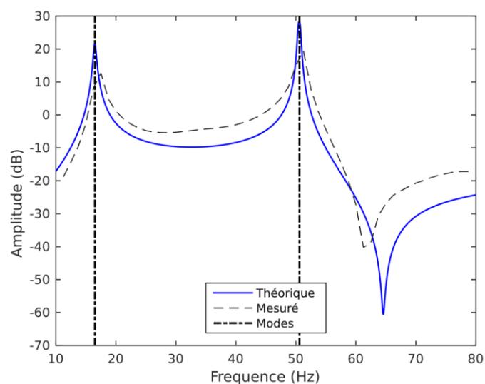
FIGURE 3.7 – Analyse vibratoire expérimentale d'un segment isolé.
