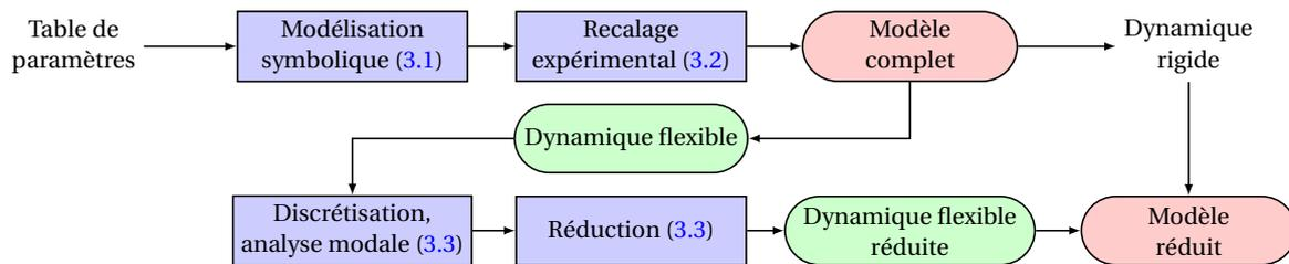
FIGURE 3.2 – Processus de modélisation systématique d'un système, permettant de produire un modèle complet (fidèle) et un modèle réduit (léger) à partir d'une table de paramètres le décrivant.
