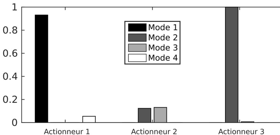
FIGURE 4.9 – Indicateur global normalisé  $\mathbf{Perf}_{a,i}$  utilisé pour la conception d'un Input Shaper pour le bras YAKA : il indique la criticité de chaque couple actionneur/mode dans le comportement vibratoire du robot YAKA. Cet indicateur met en évidence que parmi les douze couples actionneur/mode considérés, seulement cinq ont une influence significative, avec deux couples ( $a = 1/i = 1$  et  $a = 3/i = 2$ ) largement prépondérants.
