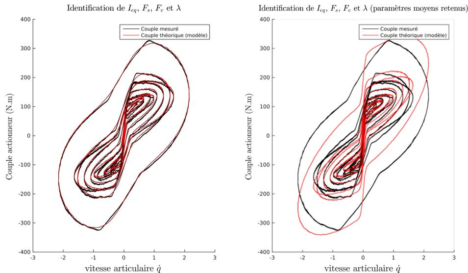
FIGURE 3.15 – Résultats d’identification sur toute la plage de fonctionnement avec la méthode d’optimisation incluant l’identification du paramètre  $\lambda$ . À gauche, les résultats obtenus en considérant pour chaque trajectoire le jeu de paramètres optimaux correspondants. À droite, on compare toutes les trajectoires avec le modèle obtenu avec les paramètres moyens.
