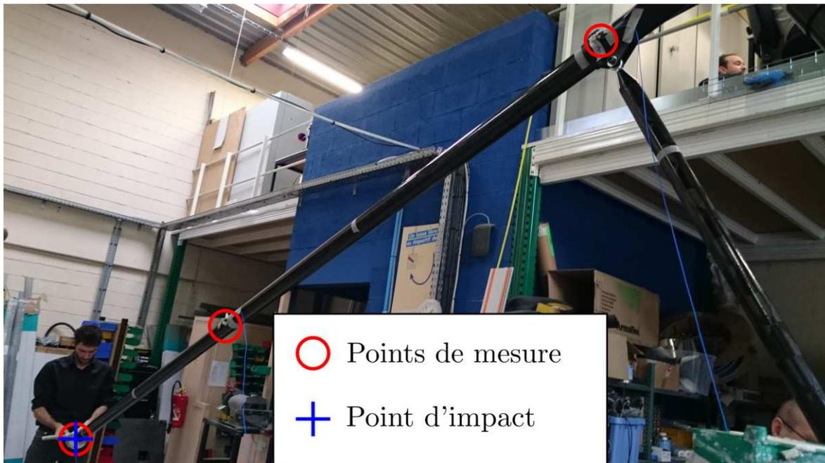
FIGURE 3.17 – Analyse vibratoire expérimentale du système complet assemblé (ici en configuration 2).
