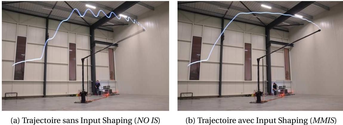
FIGURE 4.11 – Appréciation qualitative de l’amélioration de la précision en suivi de trajectoire apportée par l’approche d’Input Shaping proposée. Ces clichés sont obtenus avec une méthode de *light painting* (photographie à long temps de pause, avec un dispositif lumineux attaché à l’organe terminal du robot YAKA).
