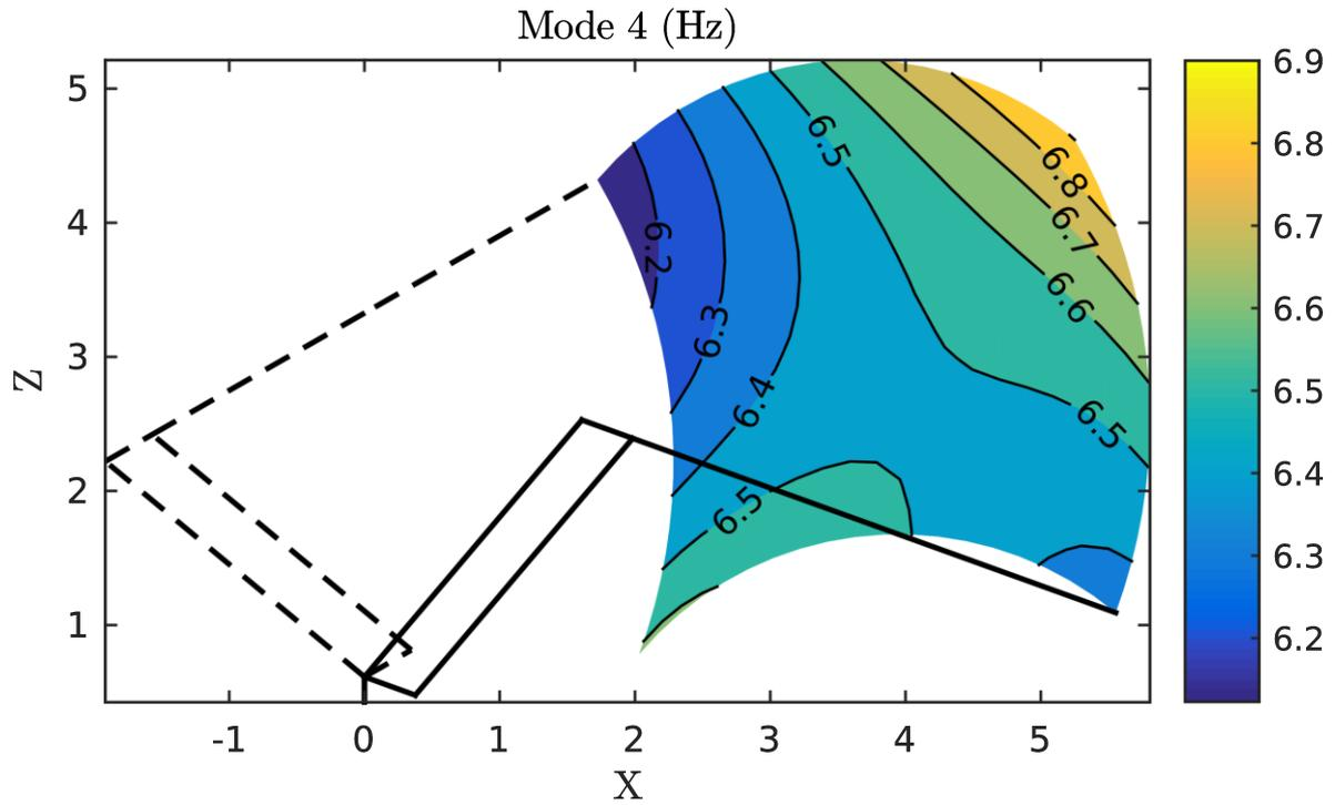
FIGURE 3.21 – Illustration des informations pouvant être issues du modèle : évolution de la fréquence propre du 4<sup>ième</sup> mode propre du robot YAKA.
