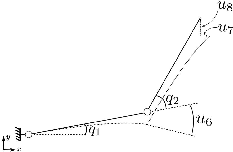
FIGURE 3.4 – Représentation de l'état d'un système 2R-plan flexible à partir de son vecteur d'état. Les variables articulaires issues du vecteur d'état  $\mathbf{q}$  décrivent le modèle rigide équivalent (ERLS), le vecteur d'état flexible  $\mathbf{u}$  représentant le déplacement cartésien de chaque nœud du robot flexible, relativement à son équivalent rigide.
