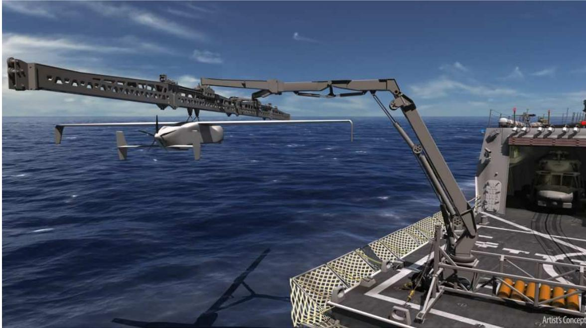
FIGURE 1.5 – Concept de système actif de récupération de drones lourds proposé par la société Aurora, doté d'une compensation de houle et d'un rail de décélération. Source : Aurora.
