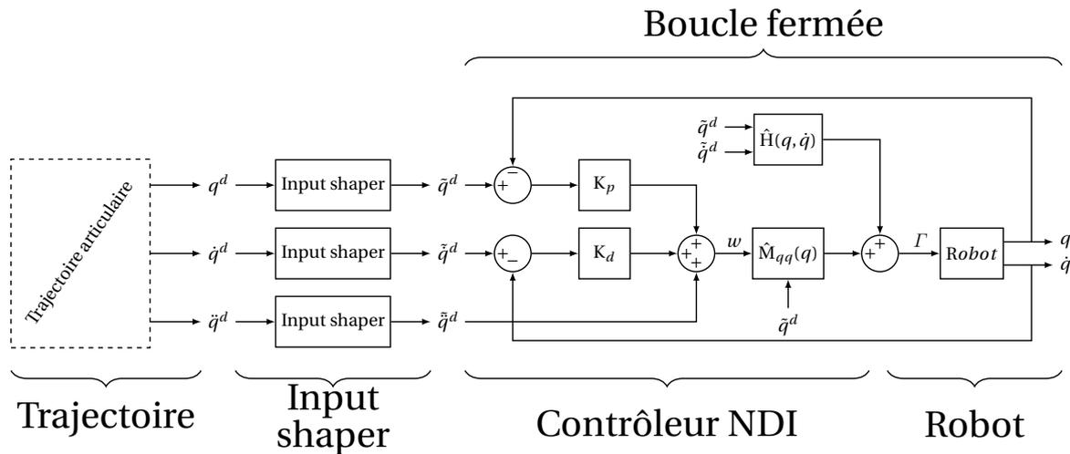
FIGURE 4.5 – Architecture de commande proposée : Linéarisation de la dynamique rigide avec un contrôleur par inversion de modèle **NDI** (asservissement en boucle fermée au niveau articulaire). L'Input Shaper développé prend en charge la maîtrise des vibrations de la structure flexible.
