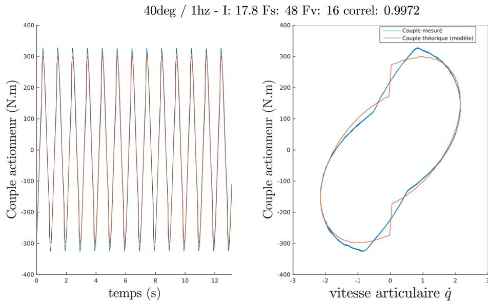
FIGURE 3.13 – Résultats d'identification à forte dynamique : les résultats temporels sont satisfaisants, mais la courbe de droite permet d'identifier une imperfection du modèle au voisinage de  $\dot{q} = 0$ .
