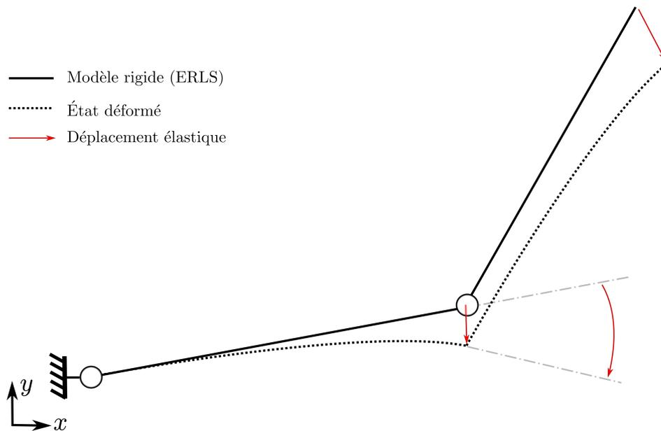
FIGURE 2.1 – Présentation du modèle rigide équivalent ERLS : l'état d'un robot flexible est décomposé en une configuration rigide équivalente (en traits pleins) et les déplacements élastiques (translation et rotation) pour décrire son état déformé complet (en pointillés).
