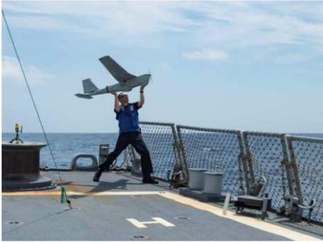
FIGURE 1.1 – Lancement d'un UAV à la main.
