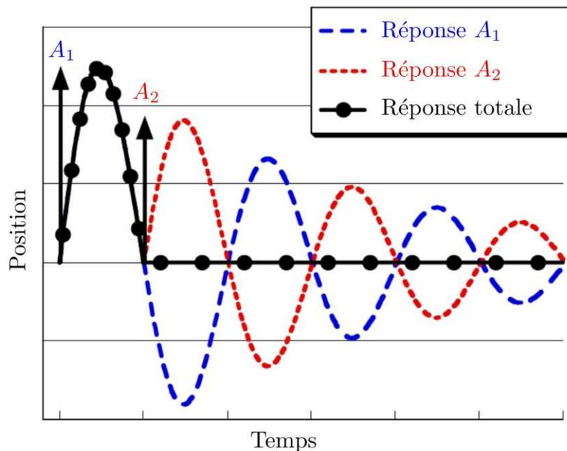
FIGURE 4.2 – Principe de l'Input Shaping illustré sur un système oscillant simple (adapté de [SINGHOSE \[2009\]](#)). Le filtre de convolution présenté fait apparaître deux impulsions séparées d'un délai  $T$  (demi-période propre d'oscillation du système). Une première impulsion d'amplitude  $A_1$  sollicite la structure et crée une oscillation qui est compensée par une deuxième impulsion d'amplitude  $A_2$ . [vidéo : input\\_shaping.mp4](#)
