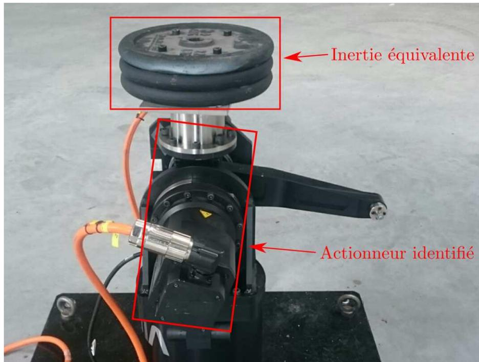
FIGURE 3.11 – Dispositif d'identification d'un actionneur du robot YAKA : une charge de masse et d'inertie connue (de l'ordre de grandeur de l'inertie des segments du robot) est placée en sortie d'un actionneur pour permettre une identification dynamique représentative, sans subir l'effet des flexibilités des segments.
