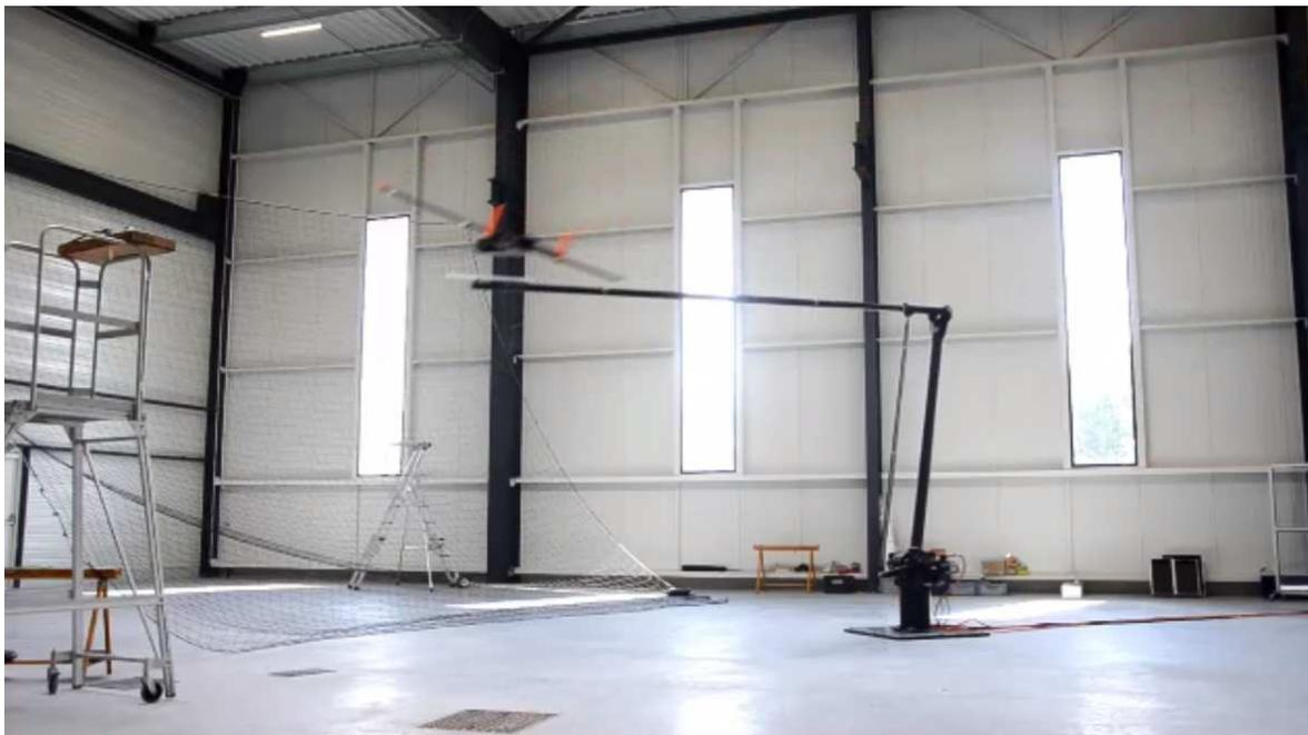
FIGURE 6.2 – Récupération d'un UAV non actionné lancé par une catapulte. [vidéo : recuperation\\_indoor.mp4](#)
