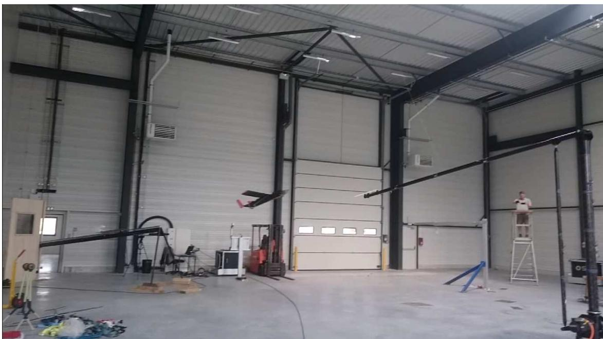
FIGURE 2.13 – Présentation du dispositif expérimental de test en intérieur : la catapulte (à gauche) lance un UAV (au centre) vers le robot YAKA (à droite) afin de recréer les conditions d’une récupération.
