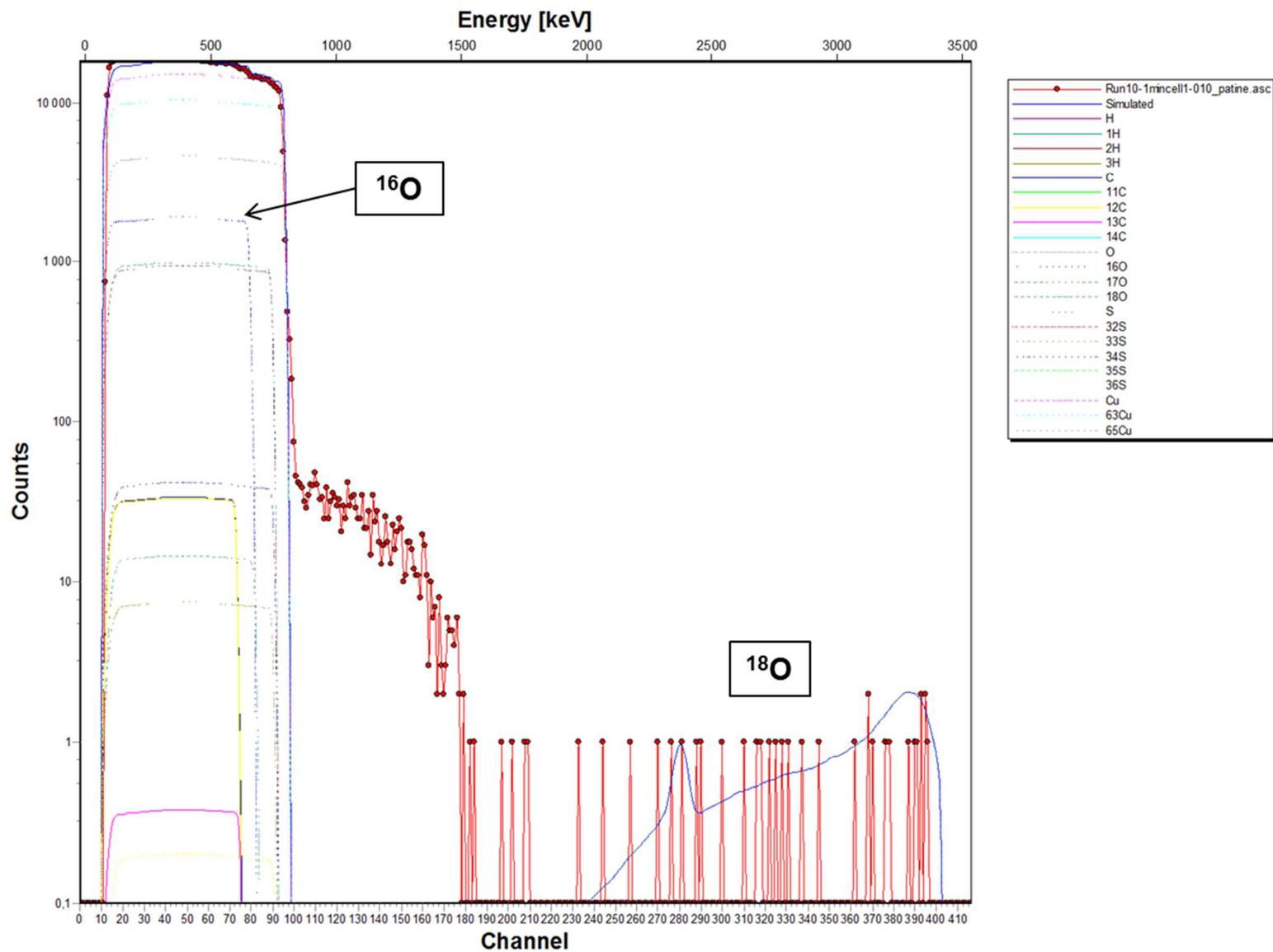
Figure XLII : Spectre expérimental et spectre simulé acquis sur la couche de corrosion de l'échantillon immergé 1 minute dans l'acide décanoïque et remis en corrosion sous  $^{18}\text{O}$ , avec les contributions du cuivre, de l'oxygène, du soufre, de l'hydrogène et de leurs isotopes naturels
