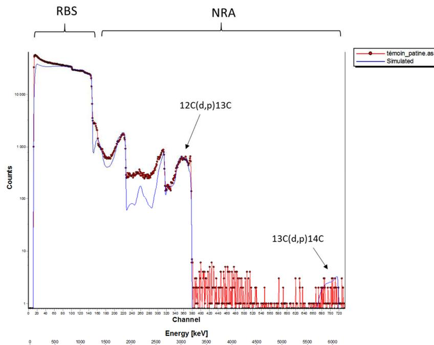
Figure 83 : Spectre expérimental et spectre simulé acquis sur la couche de produits de corrosion de l'échantillon de Metz sans traitement HC<sub>10</sub> dopé au carbone 13
