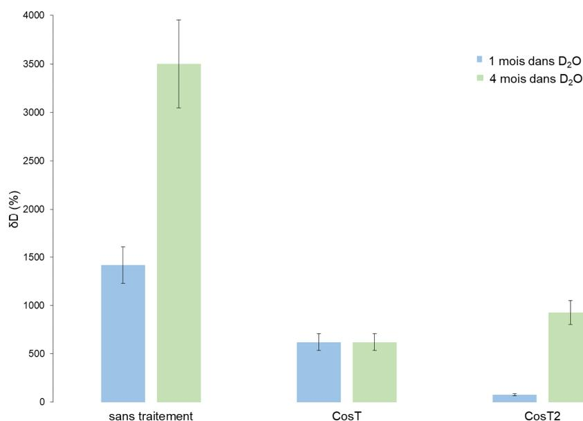
Figure 159 : Valeurs de  $\delta_D$  dans les couches externes des échantillons sans traitement de protection<sup>10</sup> et des échantillons traités à la cire Cosmolloïd, après 1 mois et 4 mois d'immersion dans le D<sub>2</sub>O
