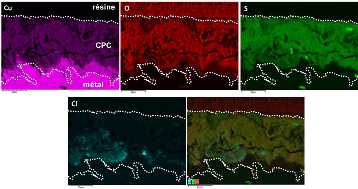
Figure 94 : Cartographies EDS du cuivre (raie  $K_{\alpha}$ ), de l'oxygène (raie  $K_{\alpha}$ ), du soufre (raie  $K_{\alpha}$ ) et du chlore (raie  $K_{\alpha}$ ), et cartographies superposées du soufre, de l'oxygène et du chlore de l'échantillon de Chartres
