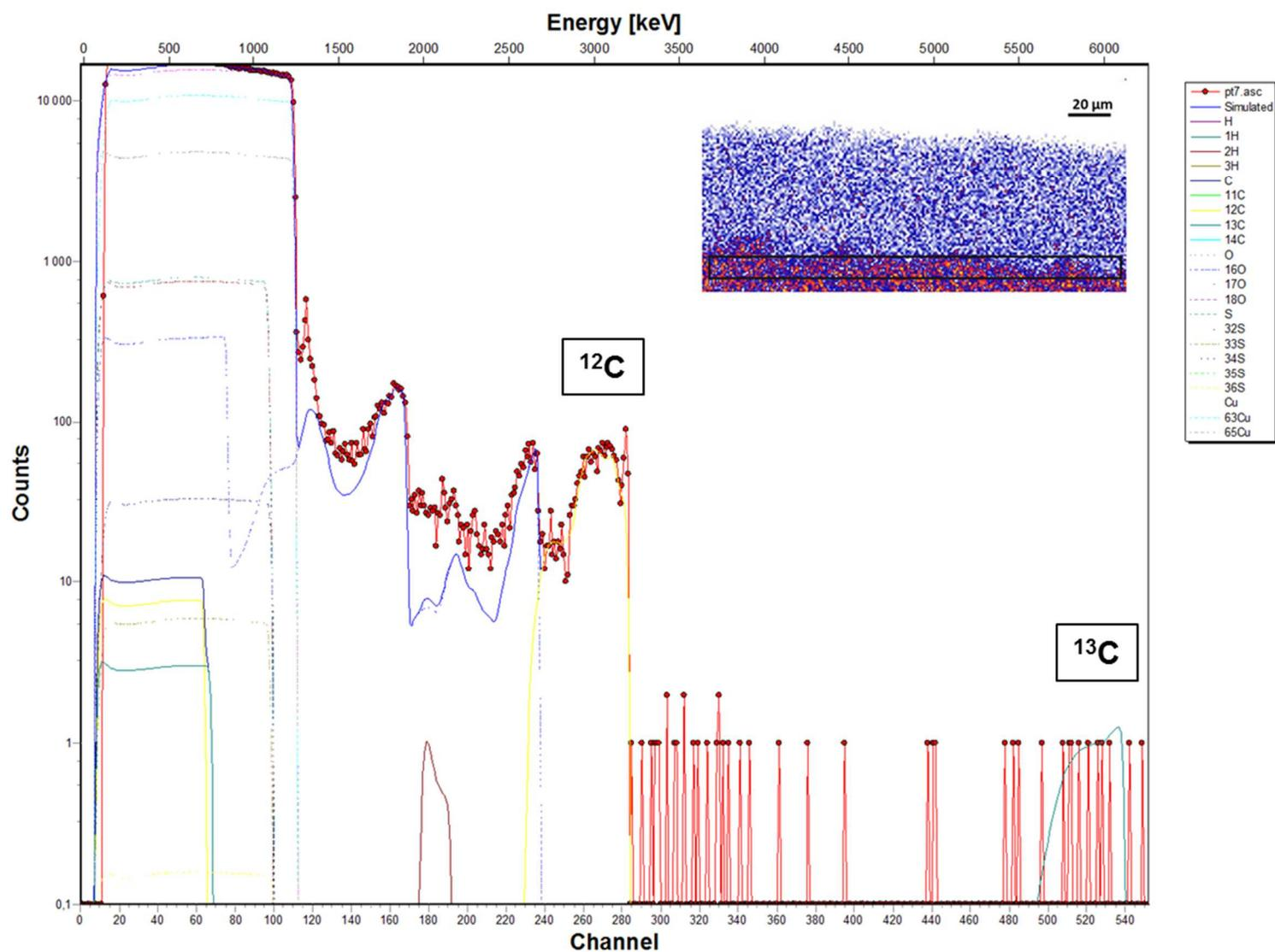
Figure XIII : Spectre expérimental et spectre simulé acquis sur la zone 7 de la couche de corrosion de l'échantillon traité à l'acide décanoïque dopé au  $^{13}\text{C}$  appliqué par immersion pendant 1 minute (zone représentée par le rectangle sur la cartographie PIXE du cuivre) avec les contributions du cuivre, du carbone, de l'oxygène, du soufre, de l'hydrogène et de leurs isotopes naturels
