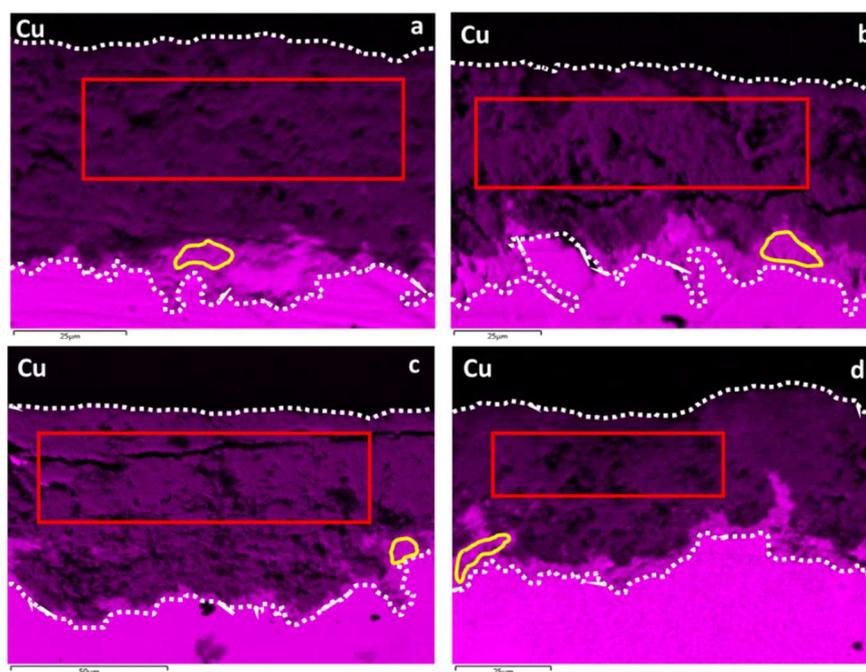
Figure 97 : Cartographies du cuivre (raie  $\text{K}_\alpha$ ) et zones d'analyse EDS de la couche interne (jaune) et de la couche externe (rouge) des échantillons de Metz (a), de Chartres (b), de Dijon (c) et de Strasbourg (d)
