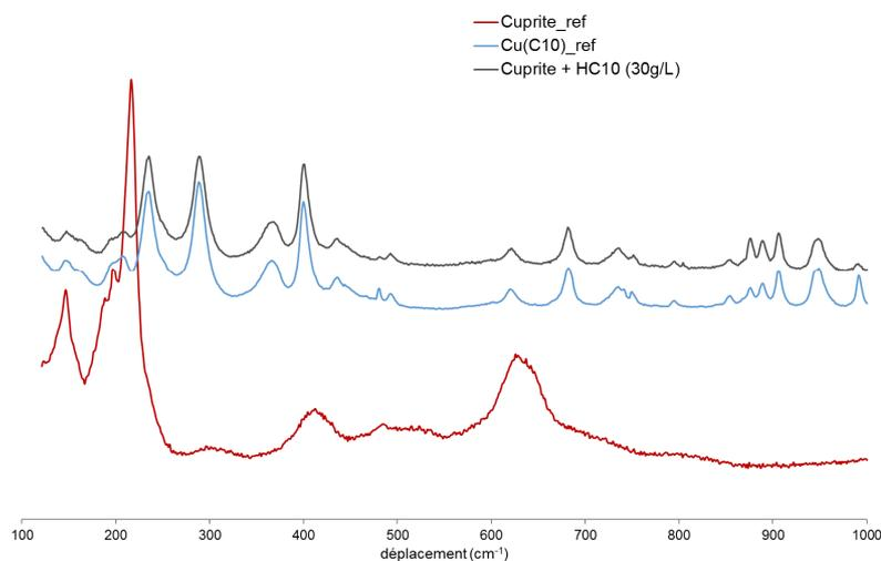
Figure 117 : Spectre  $\mu$ Raman du précipité formé après le mélange de la cuprite et HC<sub>10</sub> (30g/L) ; spectres  $\mu$ Raman de la cuprite et de Cu(C<sub>10</sub>)<sub>2</sub>
