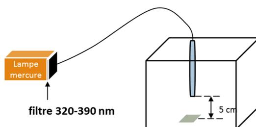
Figure 48 : Schéma du montage d'altération par UVB
