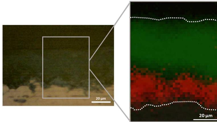
Figure 104 : Cartographies  $\mu$ Raman de la cuprite (rouge, pic  $218\text{ cm}^{-1}$ ) et de la brochantite (vert, pic  $974\text{ cm}^{-1}$ ) de l'échantillon de Chartres <sup>7</sup>
