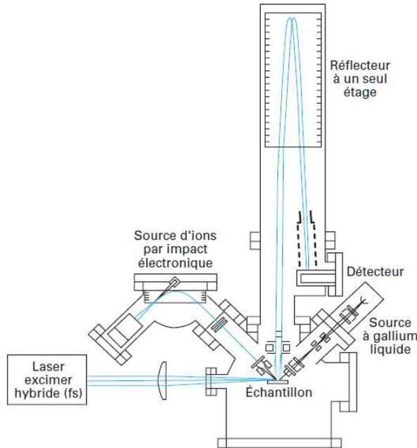
Figure 76 : Schéma général d'un analyseur à temps de vol à réflectron [153]
