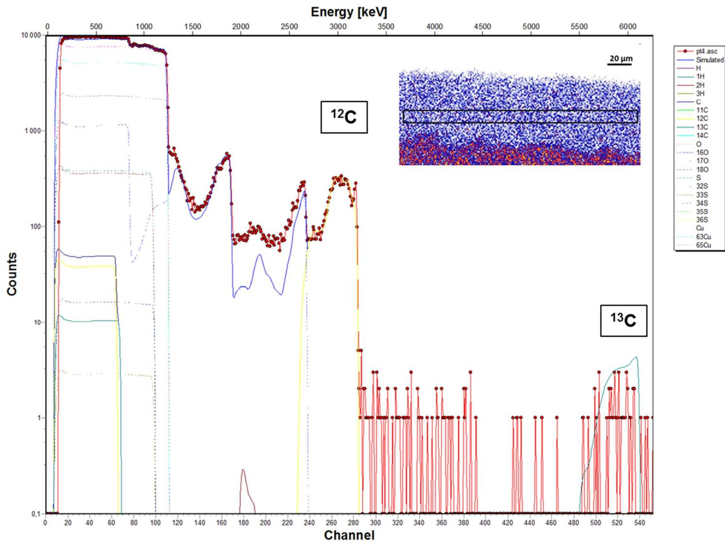
Figure X : Spectre expérimental et spectre simulé acquis sur la zone 4 de la couche de corrosion de l'échantillon traité à l'acide décanoïque dopé au <sup>13</sup>C appliqué par immersion pendant 1 minute (zone représentée par le rectangle sur la cartographie PIXE du cuivre) avec les contributions du cuivre, du carbone, de l'oxygène, du soufre, de l'hydrogène et de leurs isotopes naturels
