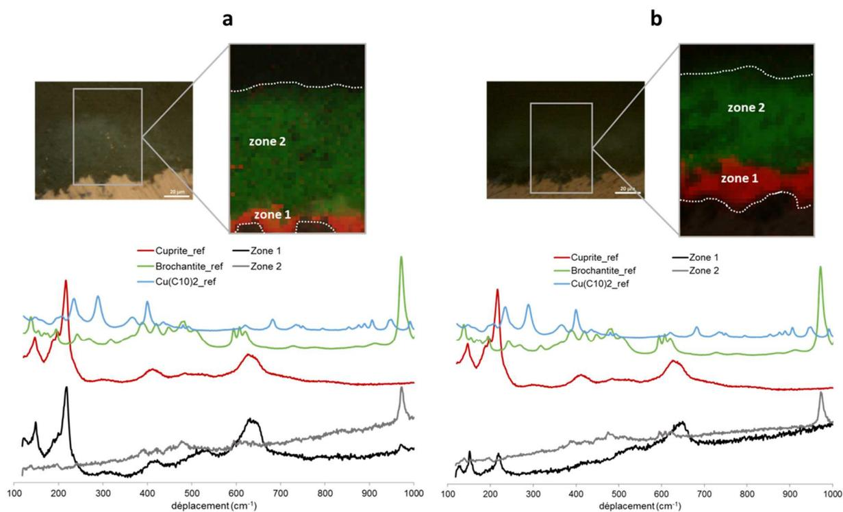
Figure 144 : Cartographies  $\mu$ Raman de la cuprite (rouge) et de la brochantite (vert) ; spectres  $\mu$ Raman moyens des couches interne et externe des échantillons immergés dans HC<sub>10</sub> pendant 1 min (a) et 5 min (b)
