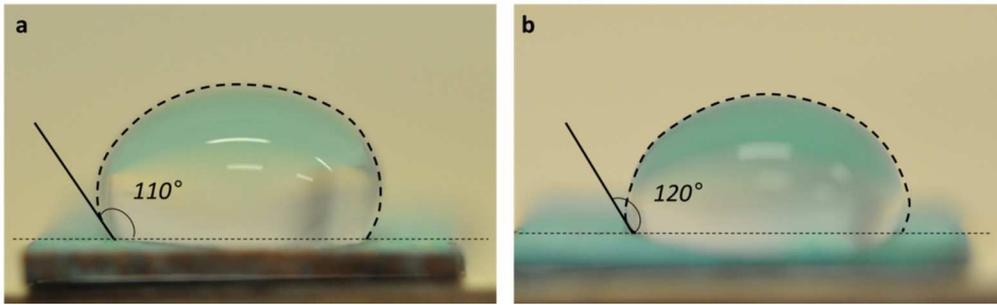
Figure 126 : Photographies de la goutte d'eau à la surface des échantillons protégés par l'acide décanoïque appliqué au pinceau en deux passes (a) et en quatre passes (b)
