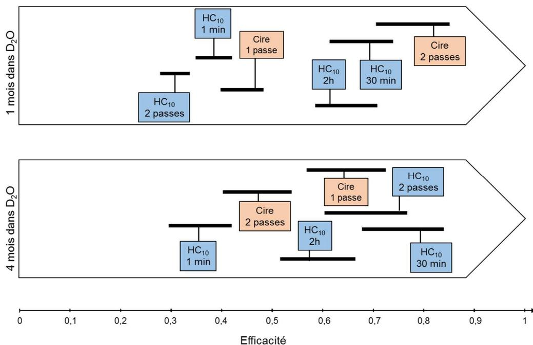
Figure 184 : Echelles d'efficacité des traitements de protection (cire en rose et HC<sub>10</sub> en bleu) après 1 mois (a) et 4 mois (b) dans le D<sub>2</sub>O (les barres noires correspondent aux incertitudes)
