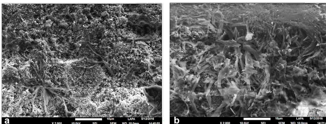
Figure 134 : Micrographies MEB en SE des échantillons traité à l'HC<sub>10</sub> appliqué en deux passes (a) et 4 passes (b)
