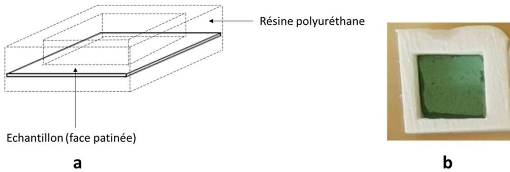
Figure 43 : Schéma de l'enrobage d'un échantillon dans une résine polyuréthane (a) et échantillon de Metz protégé par une résine polyuréthane (b)
