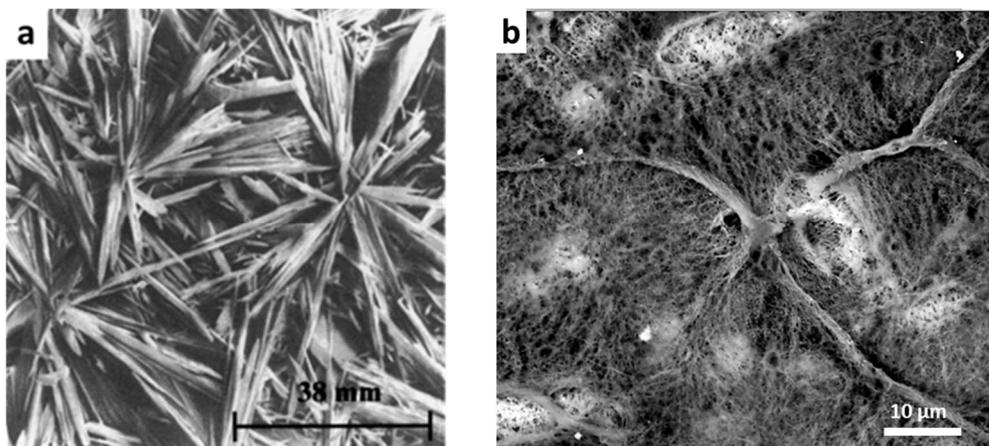
Figure 175 : Micrographie MEB d'un échantillon en cuivre non corrodé et immergé dans  $\text{NaC}_7$  (0,08M) pendant 3 jours [90], et de l'échantillon naturellement corrodé immergé dans  $\text{NaC}_{10}$  (0,1M) pendant 1 semaine
