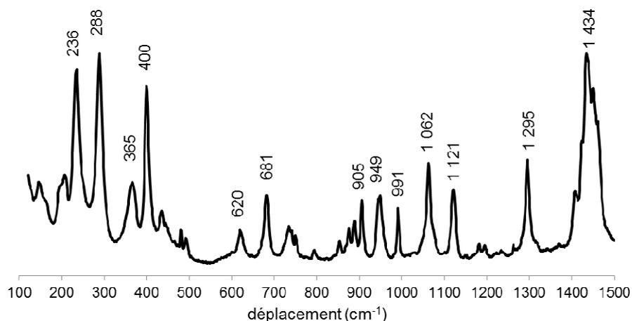
Figure 60 : Spectre  $\mu$ Raman du d canoate de cuivre
