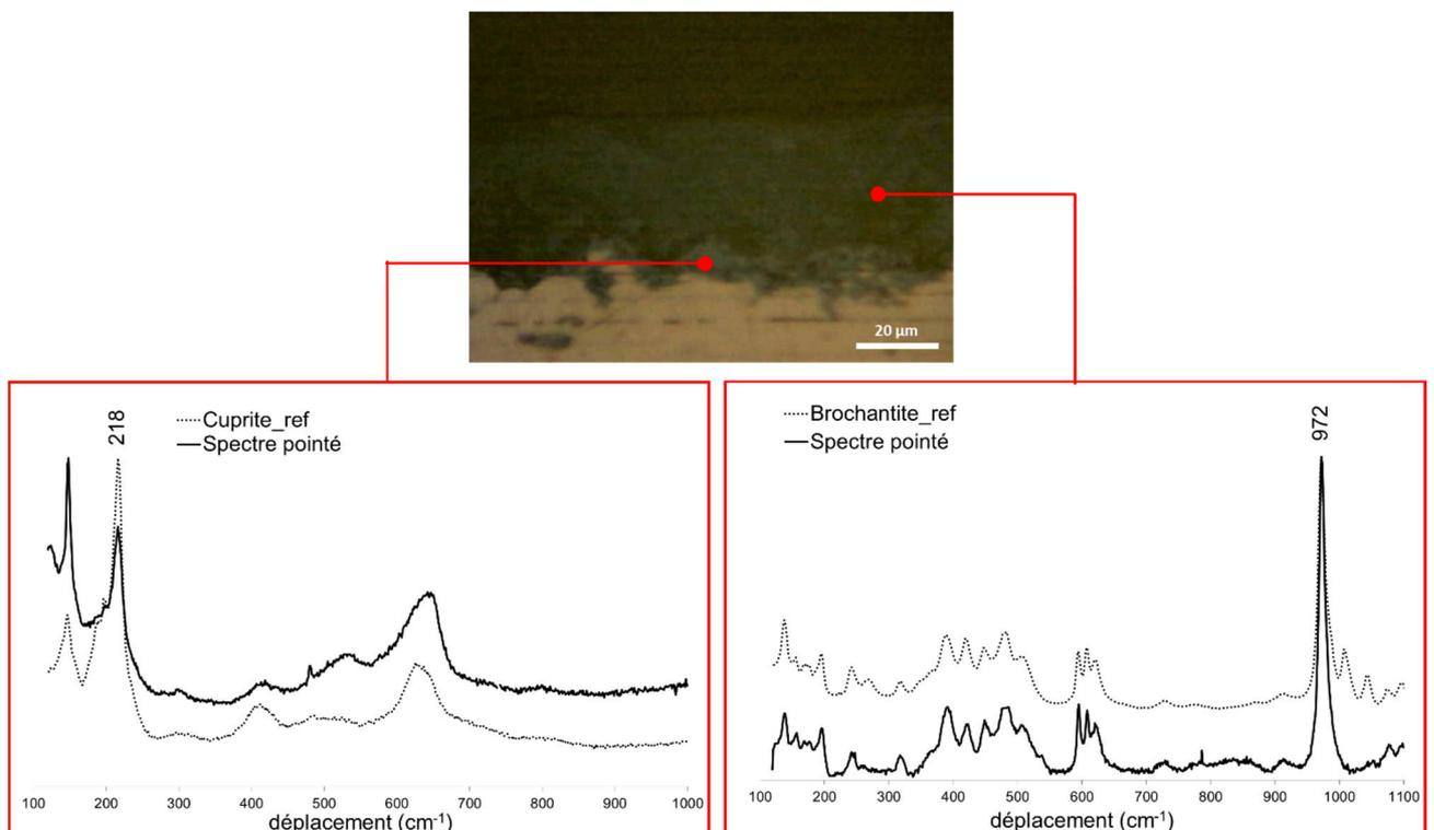
Figure 100 : Spectres  $\mu$ Raman obtenu par pointé dans les parties interne et externe de la couche de produit de corrosion de l'échantillon de Chartres ; spectres Raman de la cuprite et de la brochantite de référence
