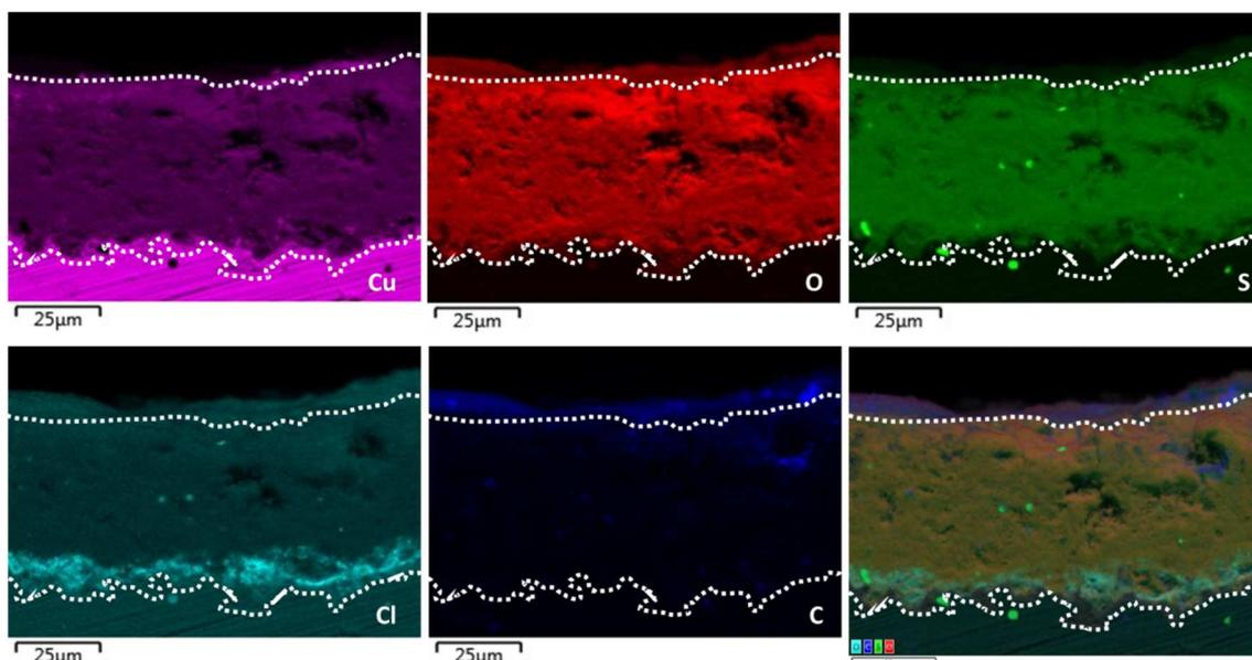
Figure 141 : Cartographies EDS du cuivre (raie  $K_{\alpha}$ ), de l'oxygène (raie  $K_{\alpha}$ ), du soufre (raie  $K_{\alpha}$ ) du chlore (raie  $K_{\alpha}$ ) et du carbone (raie  $K_{\alpha}$ ) de l'échantillon traité par  $HC_{10}$  appliqué au pinceau en 2 passes. La dernière cartographie est une superposition des cartographies du soufre (vert), de l'oxygène (rouge) et du carbone (bleu)
