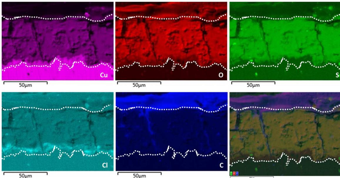
Figure 142 : Cartographies EDS du cuivre (raie  $K_{\alpha}$ ), de l'oxygène (raie  $K_{\alpha}$ ), du soufre (raie  $K_{\alpha}$ ) du chlore (raie  $K_{\alpha}$ ) et du carbone (raie  $K_{\alpha}$ ) de l'échantillon immergé 1h dans HC<sub>10</sub>. La dernière cartographie est une superposition des cartographies du soufre (vert), de l'oxygène (rouge) et du carbone (bleu)
