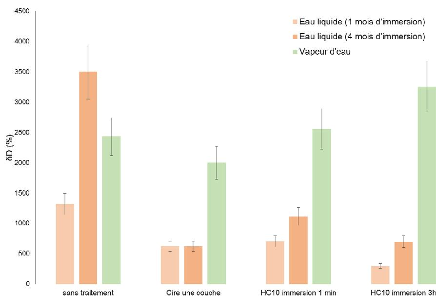
Figure 188 : Enrichissements en deutérium dans les couches de brochantite des échantillons sans traitement de protection, protégé à la cire Cosmolloïd et l'HC<sub>10</sub> par immersion 1 minute et 3h, puis remis en corrosion par immersion (saumon) ou en conditions atmosphériques sous cyclage d'humidité relative (vert)
