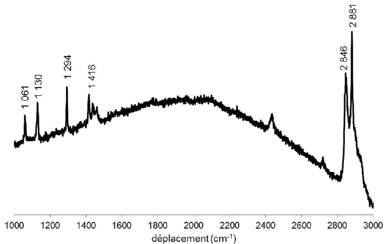
Figure 57 : Spectre  $\mu$ Raman de la cire Cosmolloïd
