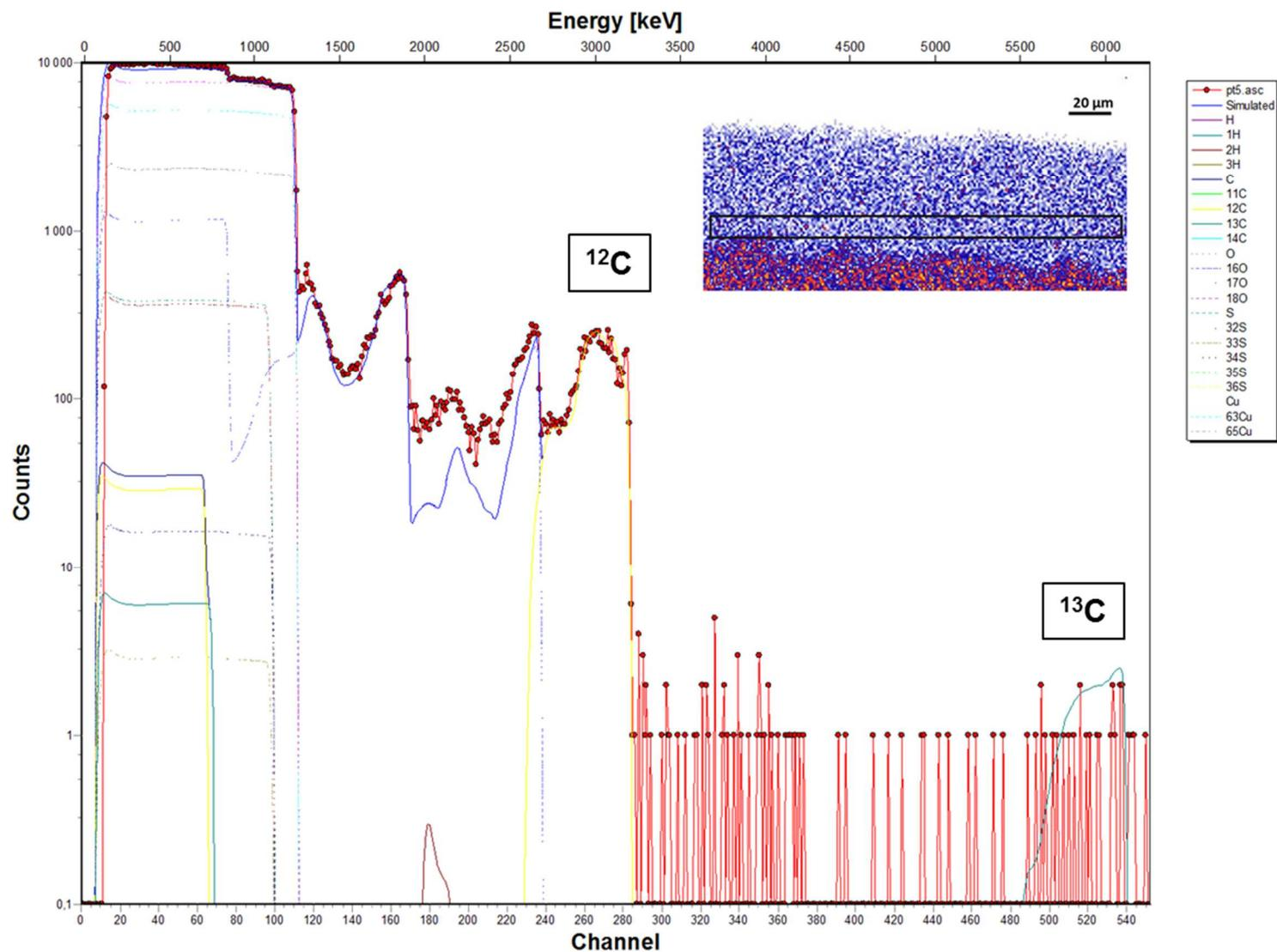
Figure XI : Spectre expérimental et spectre simulé acquis sur la zone 5 de la couche de corrosion de l'échantillon traité à l'acide décanoïque dopé au  $^{13}\text{C}$  appliqué par immersion pendant 1 minute (zone représentée par le rectangle sur la cartographie PIXE du cuivre) avec les contributions du cuivre, du carbone, de l'oxygène, du soufre, de l'hydrogène et de leurs isotopes naturels
