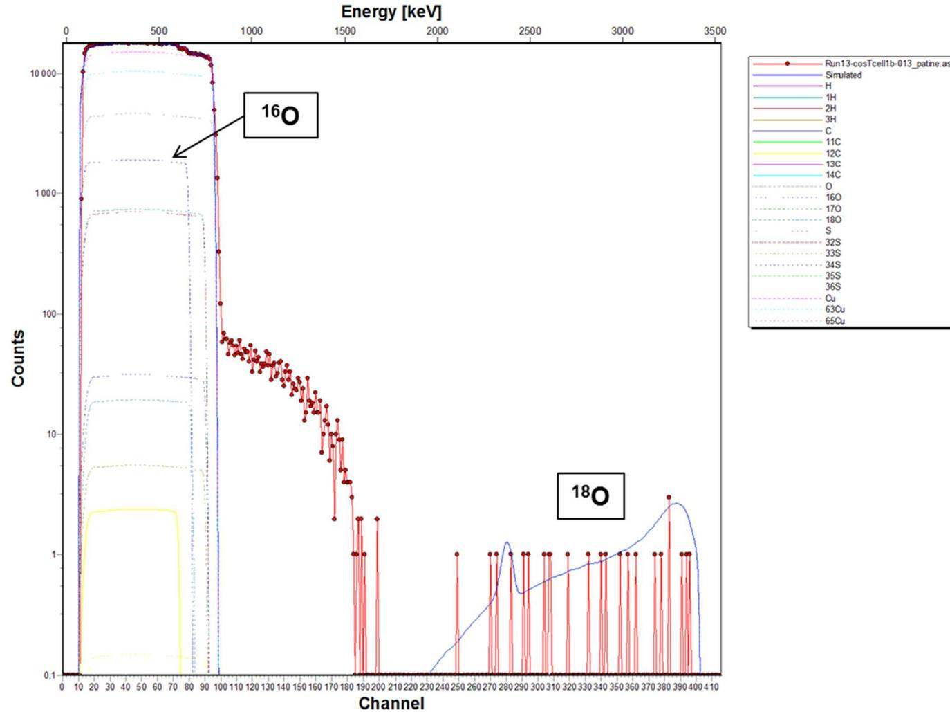
Figure XXXIX : Spectre expérimental et spectre simulé acquis sur la couche de corrosion de l'échantillon protégé à la cire Cosmolloid une passe et remis en corrosion sous  $^{18}\text{O}$ , avec les contributions du cuivre, de l'oxygène, du soufre, de l'hydrogène et de leurs isotopes naturels
