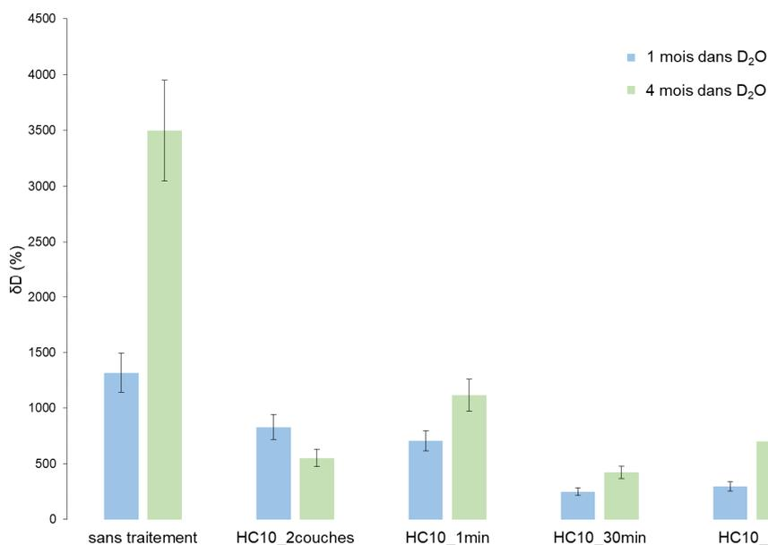
Figure 160 : Valeurs de  $\delta_D$  dans les couches externes des échantillons sans traitement et des échantillons traités à l'HC<sub>10</sub>, après 1 mois et 4 mois d'immersion dans le D<sub>2</sub>O
