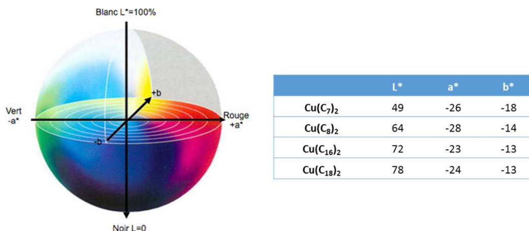
Figure 32 : Coordonnées  $L^*$ ,  $a^*$  et  $b^*$  dans l'espace CIELab des différents carboxylates de cuivre étudiés, l'heptanoate, l'octanoate, le palmitate et le stéarate de cuivre=
