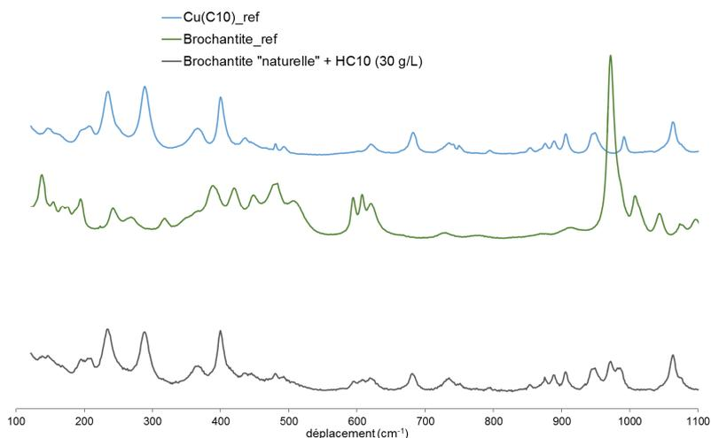
Figure 115 : Spectre  $\mu$ Raman du précipité formé après le mélange de brochantite « naturelle » et  $\text{HC}_{10}$  (30g/L) ; spectres Raman de la brochantite et de  $\text{Cu}(\text{C}_{10})_2$
