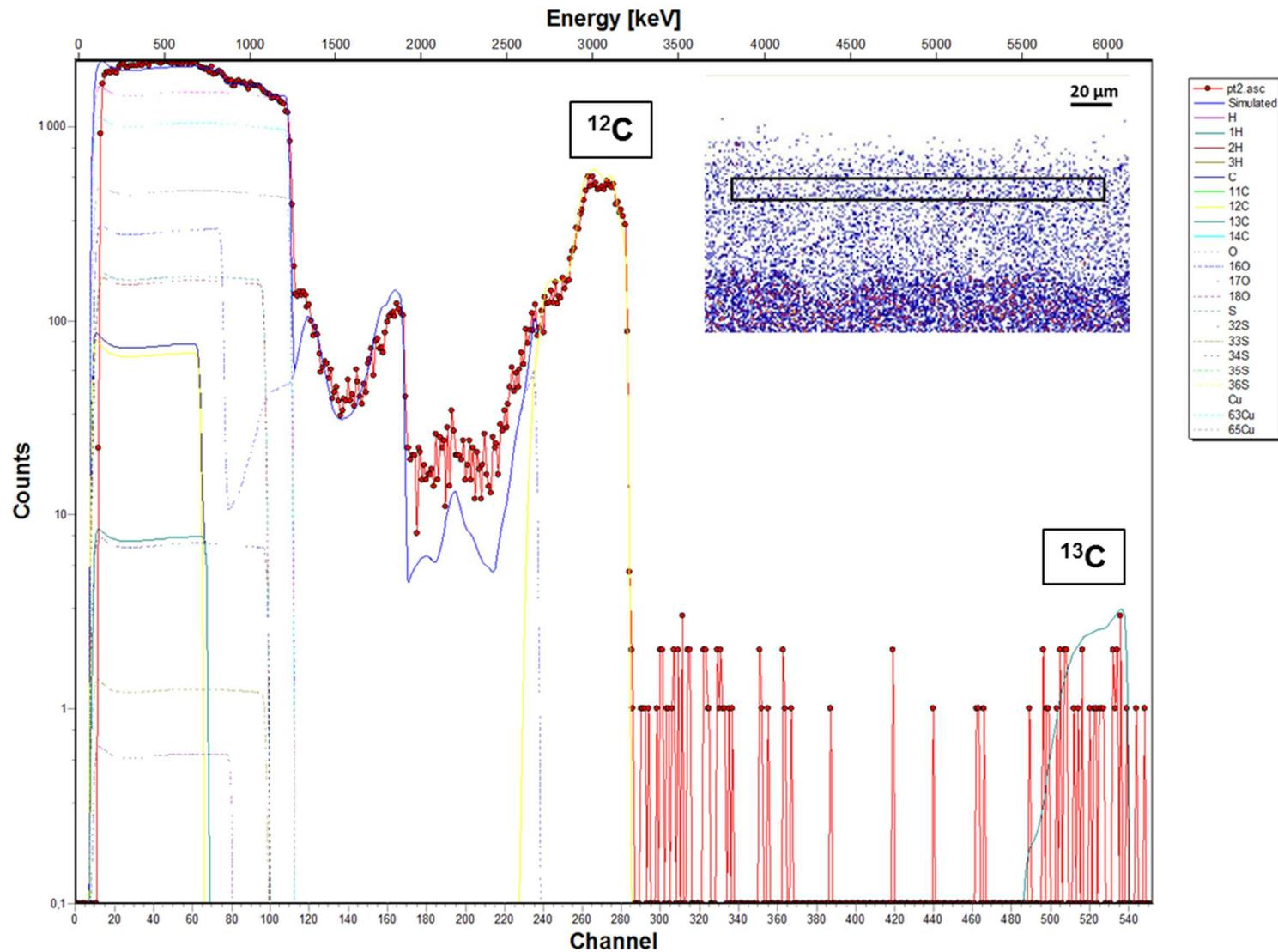
Figure XXVII : Spectre expérimental et spectre simulé acquis sur la zone 2 de la couche de corrosion de l'échantillon traité à l'acide décanoïque dopé au  $^{13}\text{C}$  appliqué par immersion pendant 2 heures (zone représentée par le rectangle sur la cartographie PIXE du cuivre) avec les contributions du cuivre, du carbone, de l'oxygène, du soufre, de l'hydrogène et de leurs isotopes naturels
