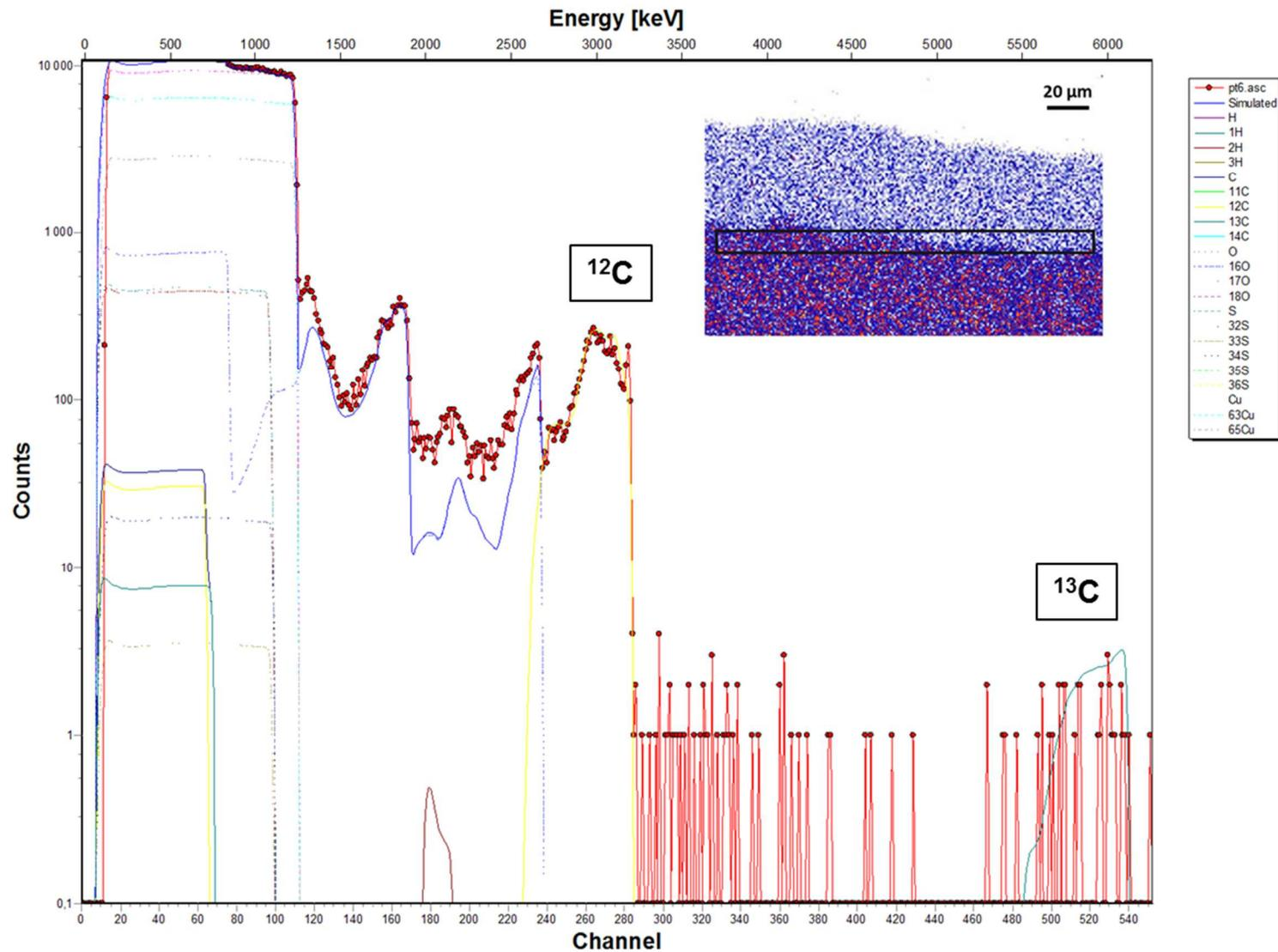
Figure XXV : Spectre expérimental et spectre simulé acquis sur la zone 6 de la couche de corrosion de l'échantillon traité à l'acide décanoïque dopé au  $^{13}\text{C}$  appliqué par immersion pendant 30 minutes (zone représentée par le rectangle sur la cartographie PIXE du cuivre) avec les contributions du cuivre, du carbone, de l'oxygène, du soufre, de l'hydrogène et de leurs isotopes naturels
