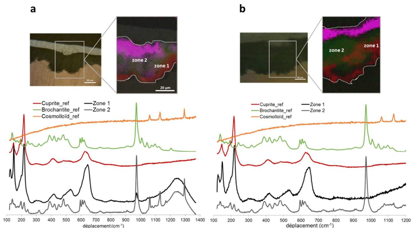
Figure 140 : Cartographie  $\mu$ Raman de la cuprite (rouge), de la brochantite (vert) et de la cire Cosmolloïd (magenta) ; spectres  $\mu$ Raman moyens des couches interne et externe des échantillons traités à la cire Cosmolloïd en 1 passe à chaud (a) et 2 passes à froid (b)
