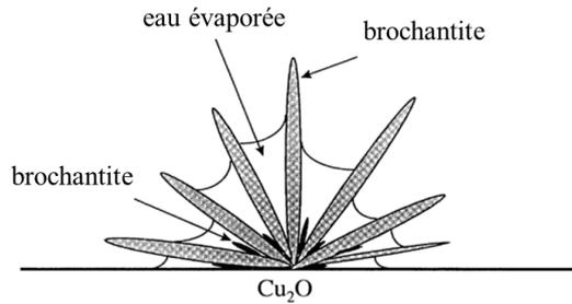
Figure 8 : Schéma des cristaux de brochantite à la surface de la couche de cuprite [17]
