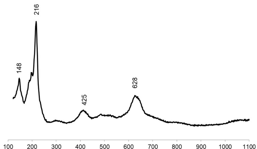
Figure 54 : Spectre  $\mu$ Raman de la cuprite synthétique
