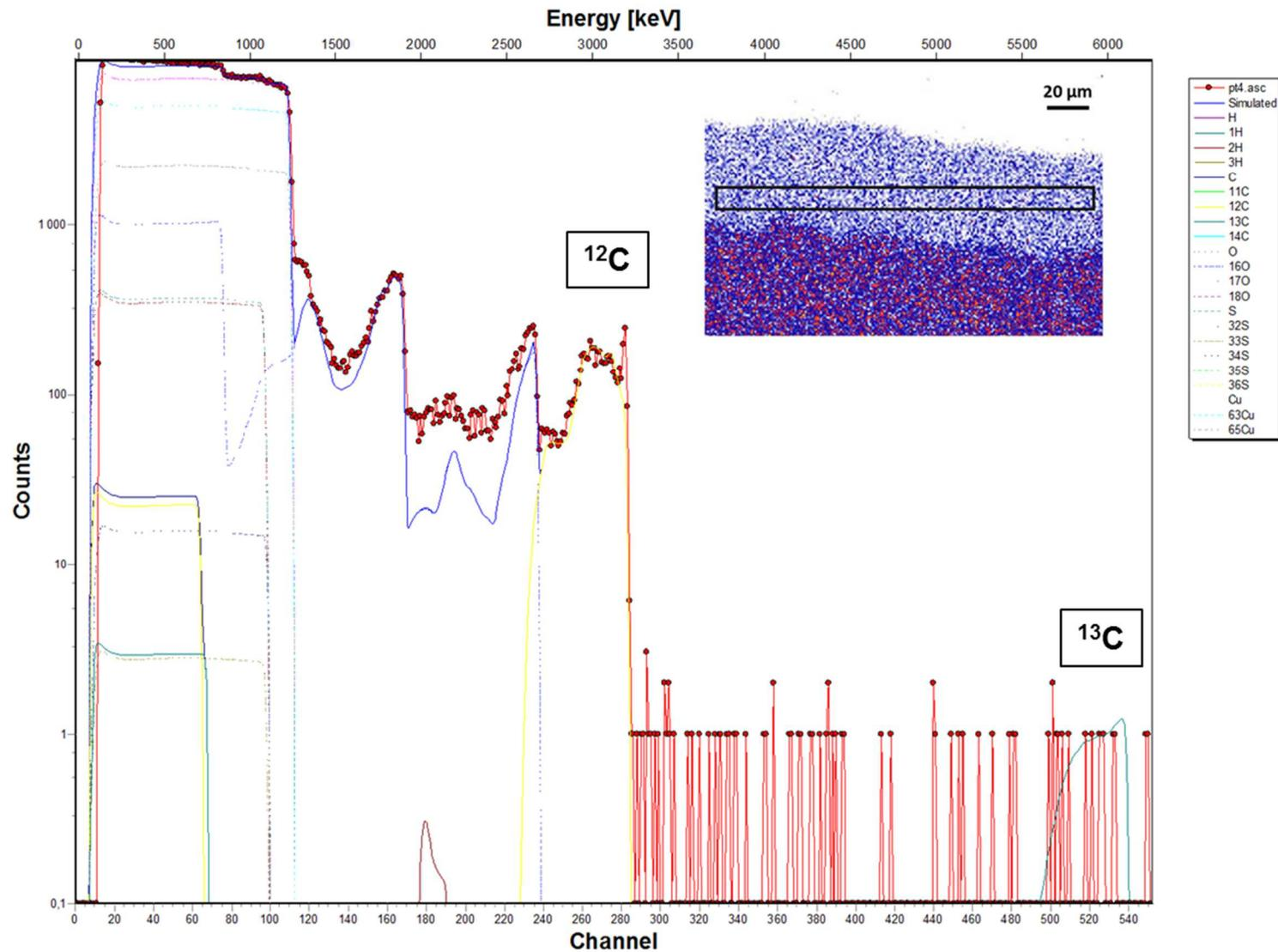
Figure XXIII : Spectre expérimental et spectre simulé acquis sur la zone 4 de la couche de corrosion de l'échantillon traité à l'acide décanoïque dopé au  $^{13}\text{C}$  appliqué par immersion pendant 30 minutes (zone représentée par le rectangle sur la cartographie PIXE du cuivre) avec les contributions du cuivre, du carbone, de l'oxygène, du soufre, de l'hydrogène et de leurs isotopes naturels
