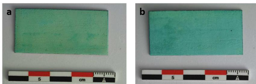
Figure 122 : Echantillons de Metz après application du traitement  $\text{HC}_{10}$  au pinceau. a) application deux passes, b) application quatre passes (les photos ont été prises dans les mêmes conditions)
