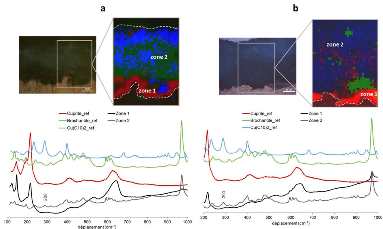
Figure 147 : Cartographies  $\mu$ Raman de la cuprite (rouge), de la brochantite (vert) et du  $\text{Cu}(\text{C}_{10})_2$  (bleu) ; spectres  $\mu$ Raman moyens des couches interne et externe des échantillons immergés dans  $\text{HC}_{10}$  pendant 1h (a) et 3h (b)
