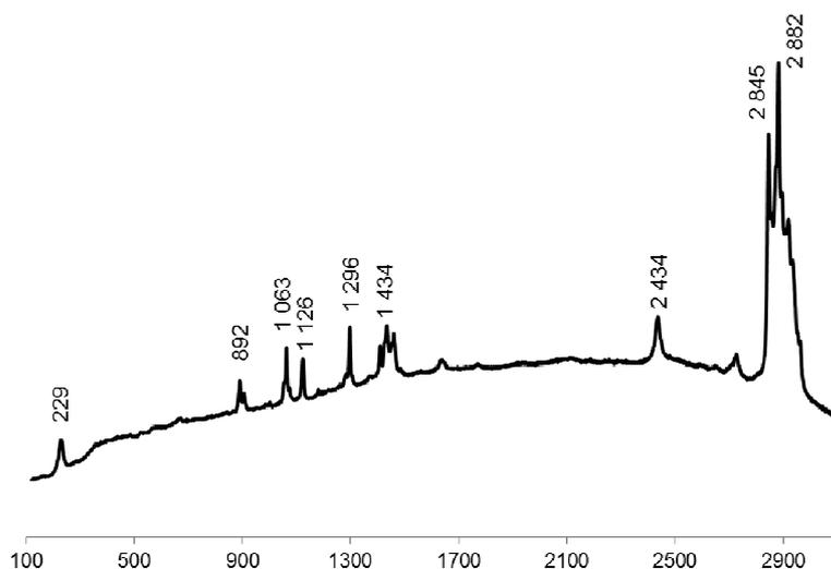
Figure 59 : Spectre  $\mu$ Raman de l'acide d canoique
