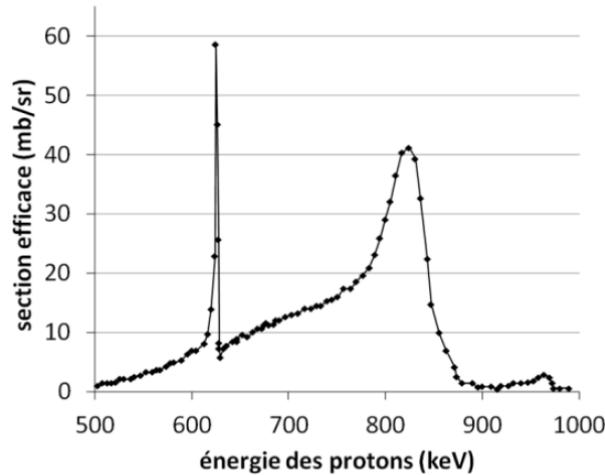
Figure 82 : Section efficace (en millibarn/stéradian) de la réaction  $^{18}\text{O}(p, \alpha)^{15}\text{N}$  en fonction de l'énergie du proton incident (pour un angle de détection de  $170^\circ$ ) [162]
