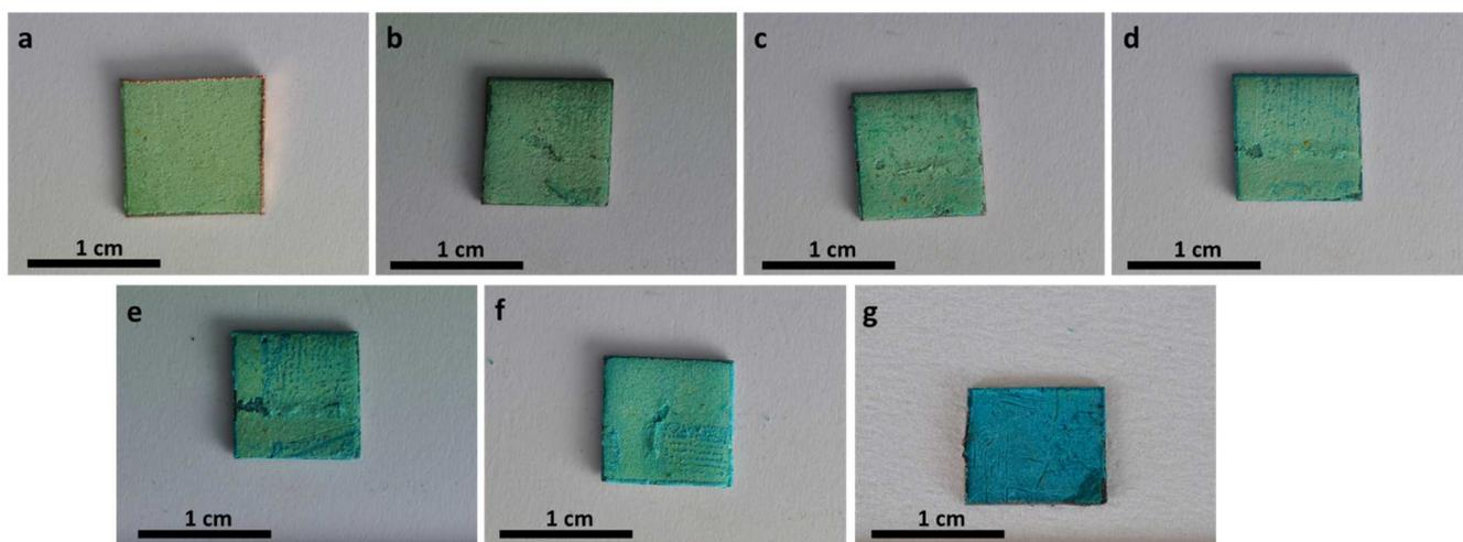
Figure 121 : Echantillons de Metz après application du traitement  $\text{HC}_{10}$  par immersion. a) sans traitement, b) 1 min, c) 5 min, d) 30 min, e) 1h, f) 2h, g) 3h, d'immersion (les photos ont été prises dans les mêmes conditions)
