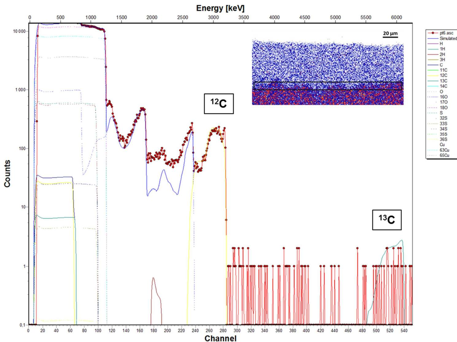
Figure XIX : Spectre expérimental et spectre simulé acquis sur la zone 6 de la couche de corrosion de l'échantillon traité à l'acide décanoïque dopé au  $^{13}\text{C}$  appliqué par immersion pendant 5 minutes (zone représentée par le rectangle sur la cartographie PIXE du cuivre) avec les contributions du cuivre, du carbone, de l'oxygène, du soufre, de l'hydrogène et de leurs isotopes naturels
