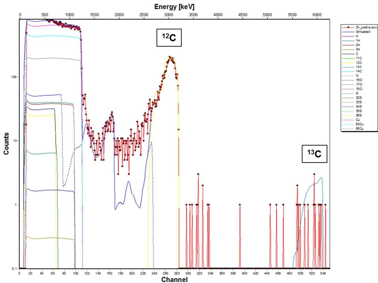
Figure VI : Spectre expérimental et spectre simulé acquis sur la couche de corrosion de l'échantillon traité à l'acide décanoïque dopé au  $^{13}\text{C}$  appliqué par immersion pendant 30 minutes avec les contributions du cuivre, du carbone, de l'oxygène, du soufre, de l'hydrogène et de leurs isotopes naturels
