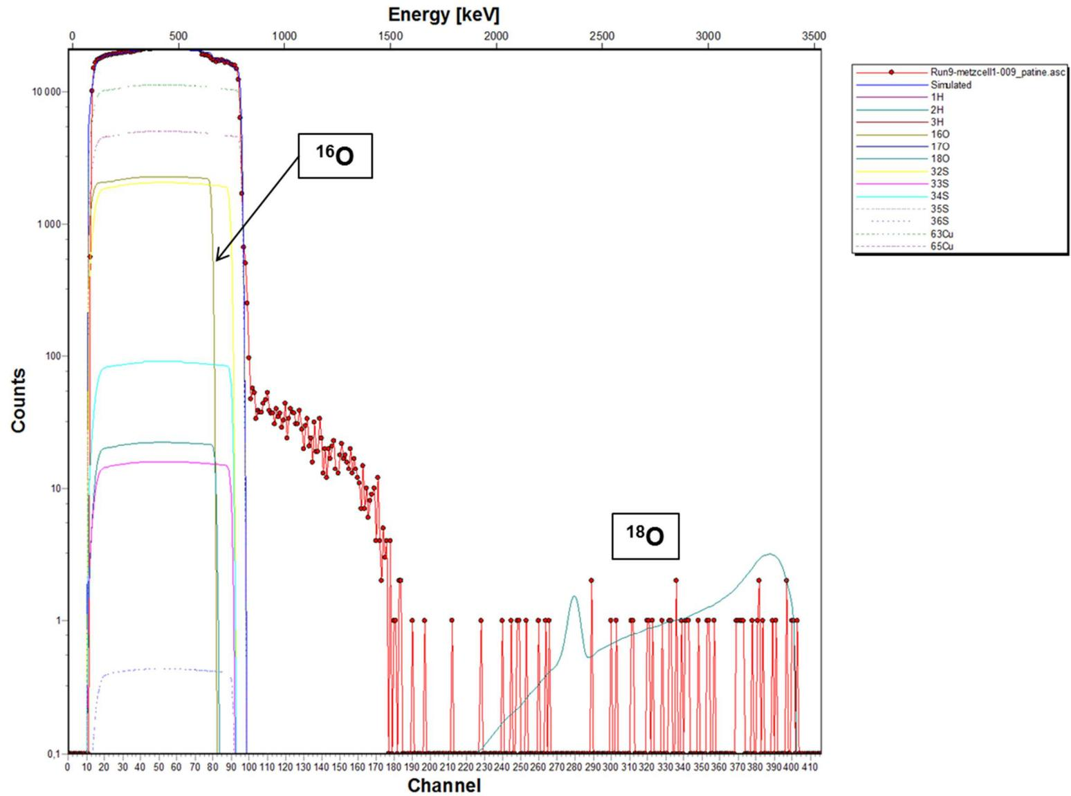
Figure XLI : Spectre expérimental et spectre simulé acquis sur la couche de corrosion de l'échantillon de Metz sans traitement de protection et remis en corrosion sous  $^{18}\text{O}$ , avec les contributions du cuivre, de l'oxygène, du soufre, de l'hydrogène et de leurs isotopes naturels
