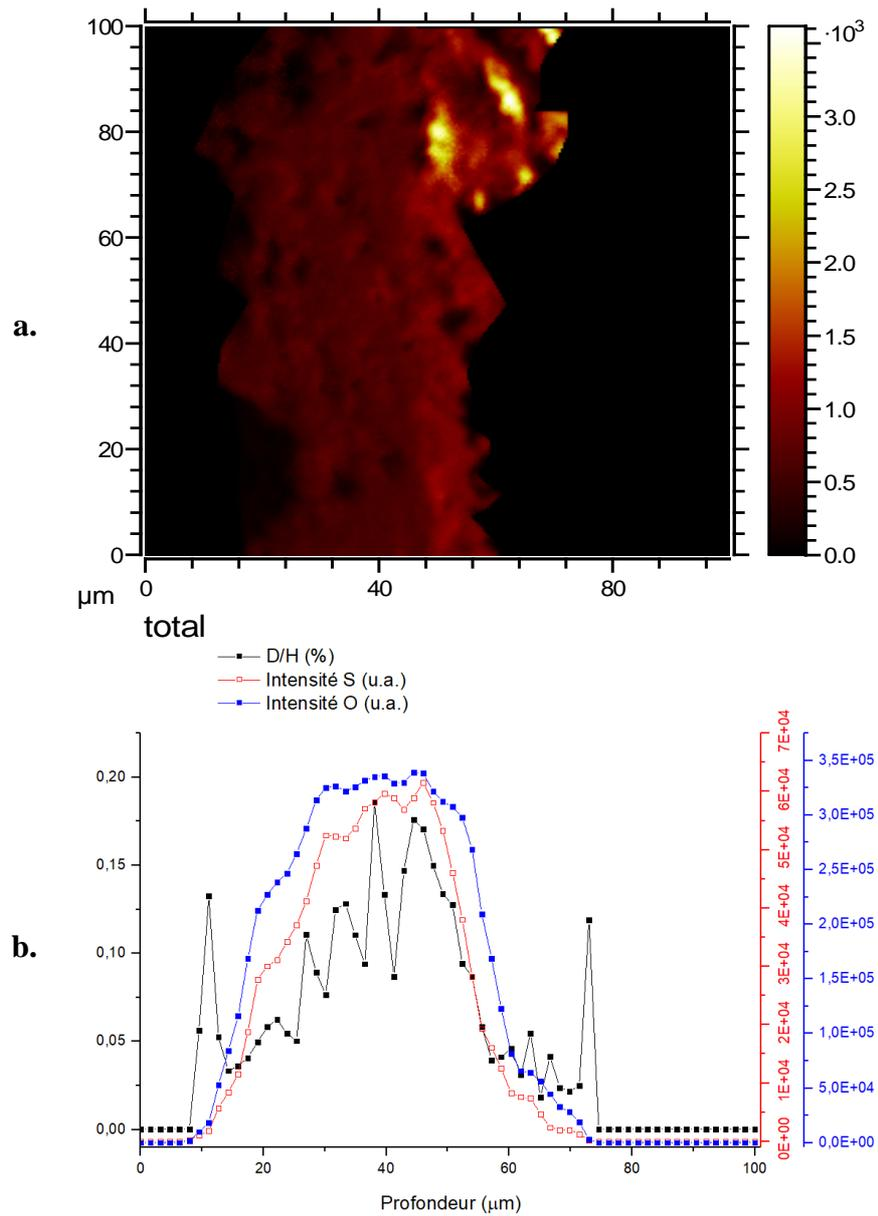
Figure XXXIV : Superposition des cartographies de S<sup>-</sup> et CuO<sup>-</sup> de l'échantillon de Metz protégé à l'acide décanoïque appliqué au pinceau en deux couches (a) et profil d'enrichissement en D/H (noir), profil d'intensité du soufre (rouge) et de l'oxygène (bleu) (b)
