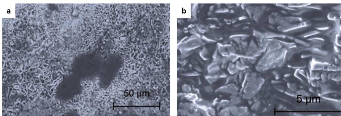
Figure 28 : Micrographies MEB des échantillons après immersion pendant 5 jours dans NaC<sub>10</sub> (a) et HC<sub>10</sub> (b)
