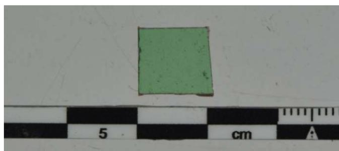
Figure 40 : Echantillon en cuivre de la toiture de la cathédrale de Metz de 1x1 cm<sup>2</sup>
