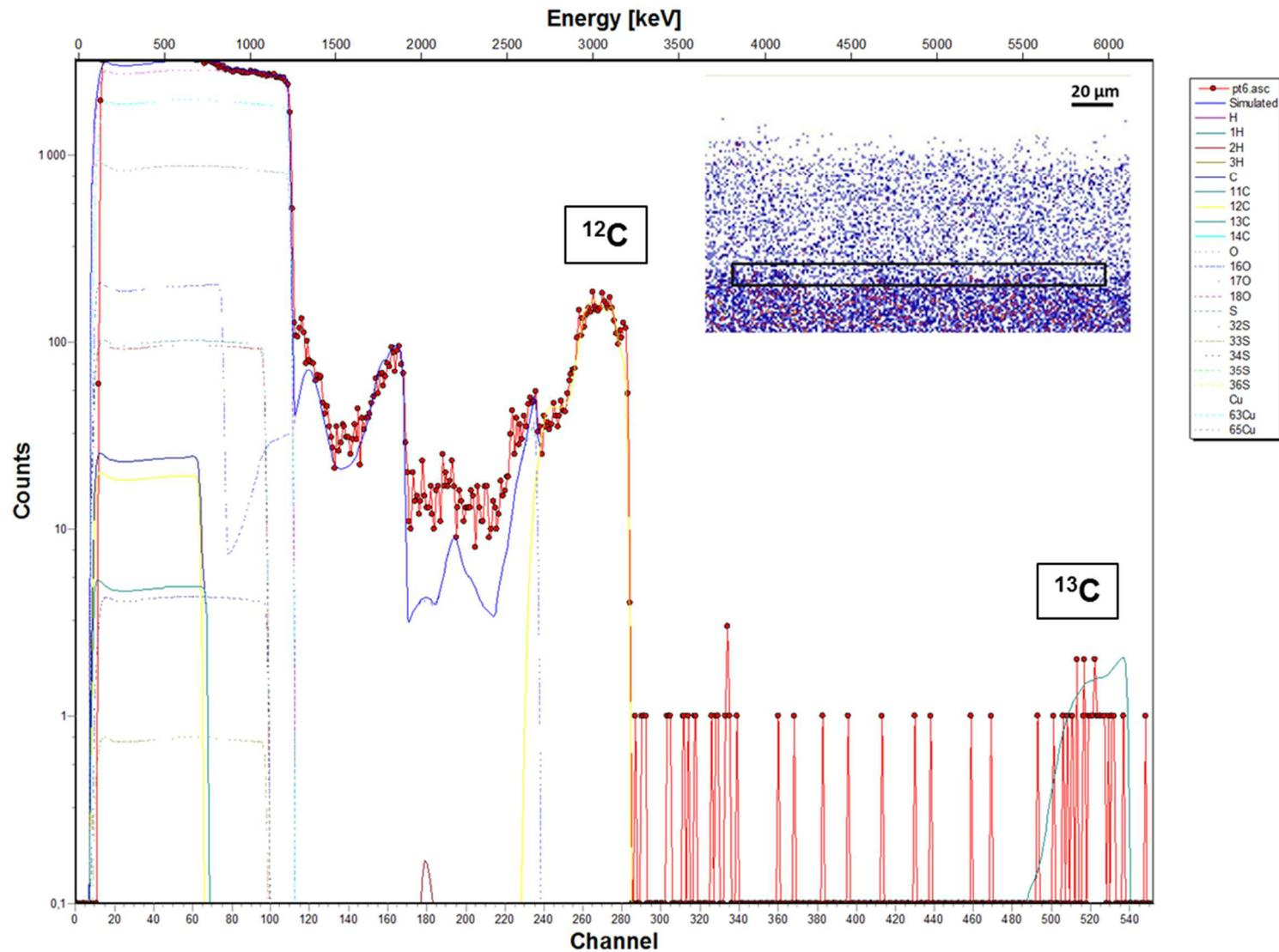
Figure XXXI : Spectre expérimental et spectre simulé acquis sur la zone 5 de la couche de corrosion de l'échantillon traité à l'acide décanoïque dopé au  $^{13}\text{C}$  appliqué par immersion pendant 2 heures (zone représentée par le rectangle sur la cartographie PIXE du cuivre) avec les contributions du cuivre, du carbone, de l'oxygène, du soufre, de l'hydrogène et de leurs isotopes naturel
