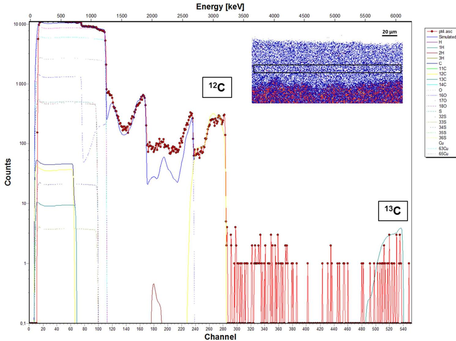
Figure XVII : Spectre expérimental et spectre simulé acquis sur la zone 4 de la couche de corrosion de l'échantillon traité à l'acide décanoïque dopé au  $^{13}\text{C}$  appliqué par immersion pendant 5 minutes (zone représentée par le rectangle sur la cartographie PIXE du cuivre) avec les contributions du cuivre, du carbone, de l'oxygène, du soufre, de l'hydrogène et de leurs isotopes naturels
