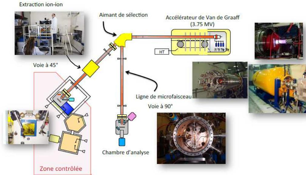
Figure 77 : Schéma de la microsonde nucléaire du LEEL [156]
