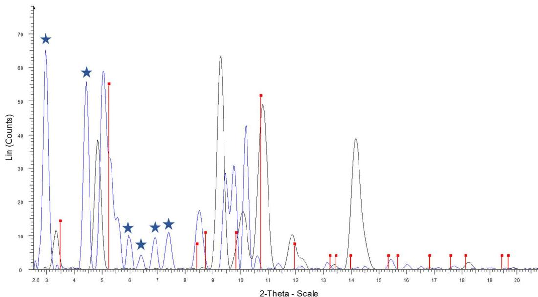
Figure 74 : Diffractogrammes du décanoate de cuivre  $\text{Cu}(\text{C}_{10})_2$  synthétisée (bleu), du décanoate de sodium  $\text{NaC}_{10}$  et positions des pics de l'acide décanoïque  $\text{HC}_{10}$  (JCPDF n° 043-1698) : les étoiles bleues correspondent aux pics du décanoate de sodium sans interférence avec l'acide décanoïque et le décanoate de sodium
