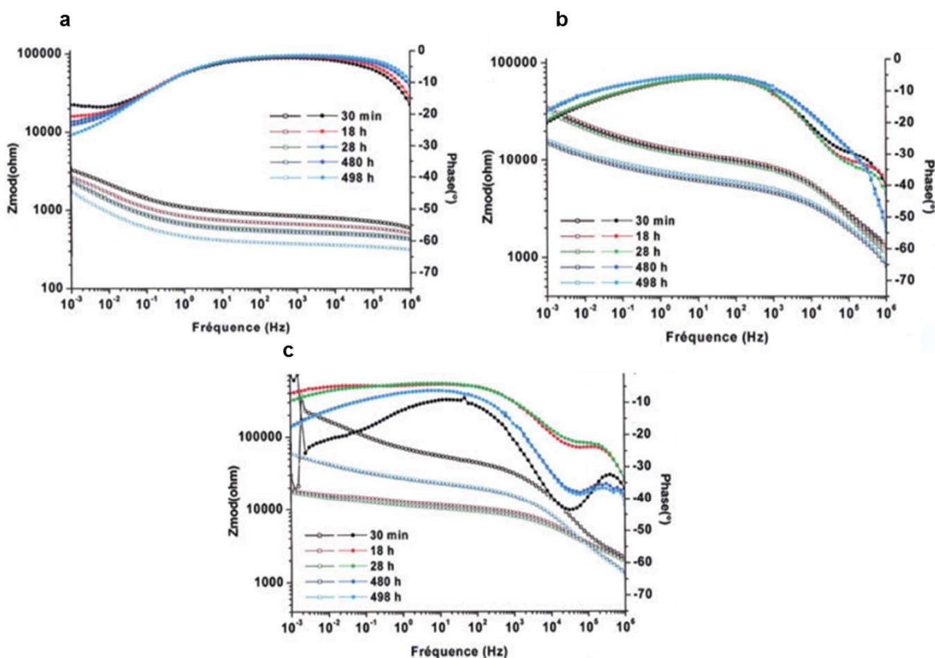
Figure 27 : Représentation de Bode des diagrammes d'impédances électrochimiques après 20 jours d'immersion dans l'eau ASTM des échantillons non traités (a) et traités par  $\text{NaC}_{10}$  (b) et  $\text{HC}_{10}$  (c) [122]
