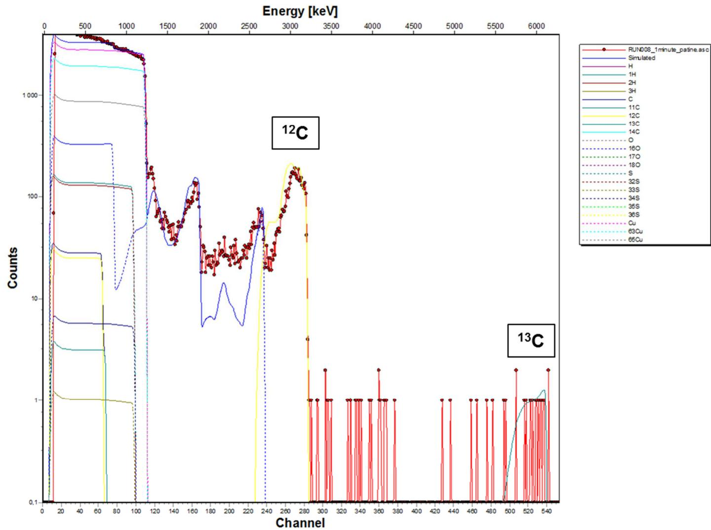
Figure III : Spectre expérimental et spectre simulé acquis sur la couche de corrosion de l'échantillon traité à l'acide décanoïque dopé au  $^{13}\text{C}$  appliqué par immersion pendant 1 minute avec les contributions du cuivre, du carbone, de l'oxygène, du soufre, de l'hydrogène et de leurs isotopes naturels
