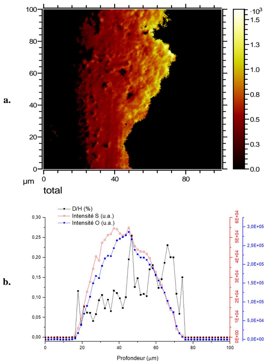
Figure XXXII : Superposition des cartographies de  $S^-$  et  $CuO^-$  de l'échantillon de Metz protégé à la cire Cosmolloïd® appliquée en une couche (a) et profil d'enrichissement en D/H (noir), profil d'intensité du soufre (rouge) et de l'oxygène (bleu) (b)
