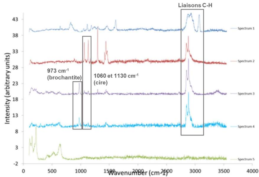
Figure 179 : Spectres Raman des cinq couches du profil sur coupe transverse d'un échantillon ciré en une passe (cire Renaissance) [79]
