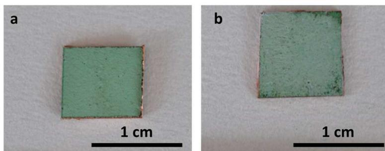
Figure 120 : Echantillons de Metz sans traitement (a) et après une semaine d'immersion dans une solution de  $\text{NaC}_{10}$  (0,1M) (les photos ont été prises dans les mêmes conditions)
