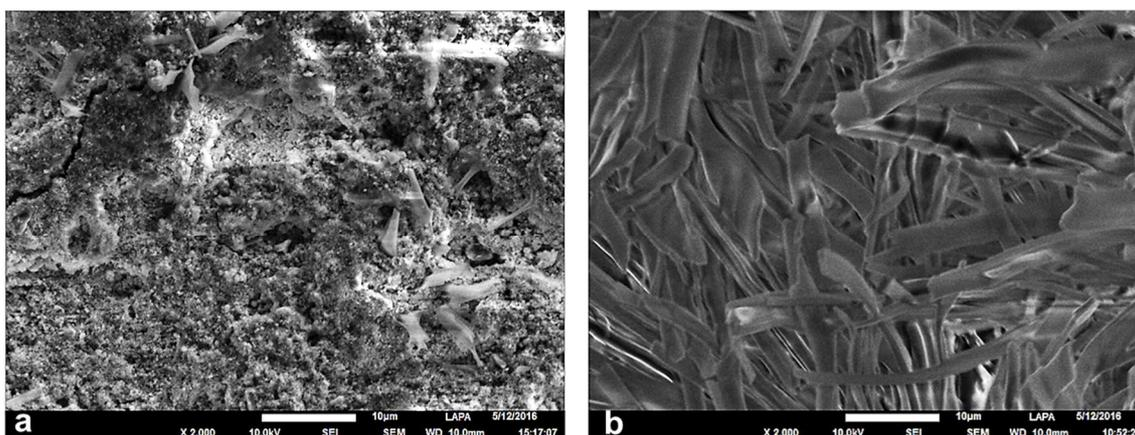
Figure 133 : Micrographies MEB en SE des échantillons immergés dans la solution de HC<sub>10</sub> (30g/L) pendant 5 min (a) et 20h (b)
