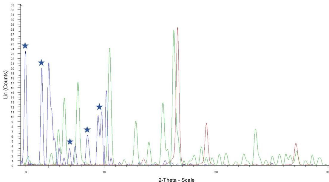
Figure 75 : Diffractogrammes du décanoate de cuivre  $\text{Cu}(\text{C}_{10})_2$  synthétisée (bleu), de la brochantite synthétisée (vert) et de la cuprite (rouge) ; les étoiles bleues correspondent aux pics du décanoate de cuivre sans interférence avec la brochantite et la cuprite
