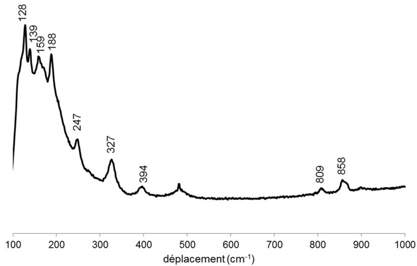
Figure 56 : Spectre  $\mu$ Raman de la nantokite synthétique
