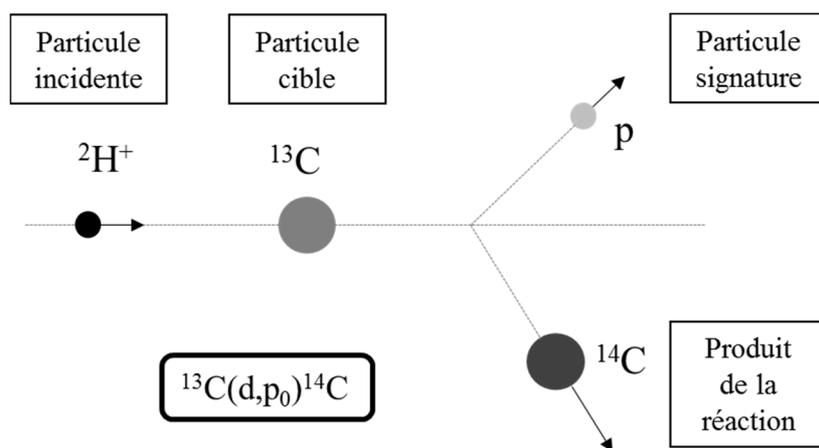
Figure 78 : Schéma de l'analyse par NRA du carbone 13
