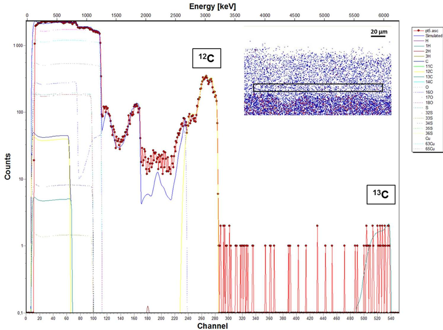
Figure XXX : Spectre expérimental et spectre simulé acquis sur la zone 5 de la couche de corrosion de l'échantillon traité à l'acide décanoïque dopé au  $^{13}\text{C}$  appliqué par immersion pendant 2 heures (zone représentée par le rectangle sur la cartographie PIXE du cuivre) avec les contributions du cuivre, du carbone, de l'oxygène, du soufre, de l'hydrogène et de leurs isotopes naturels
