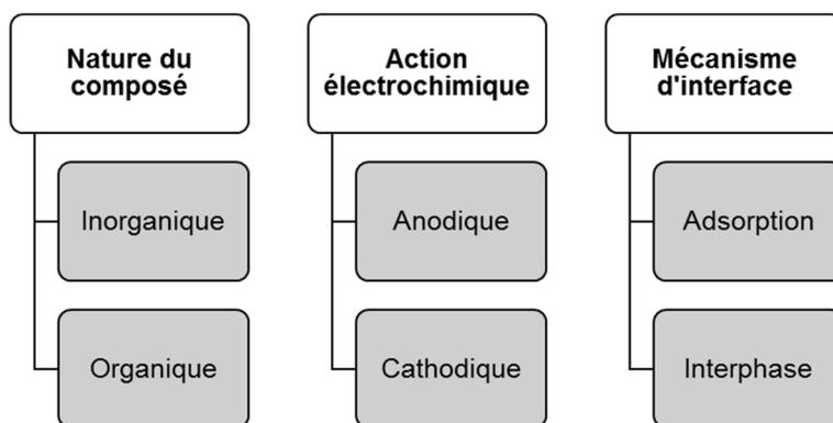
Figure 21 : Schéma de la classification des inhibiteurs de corrosion
