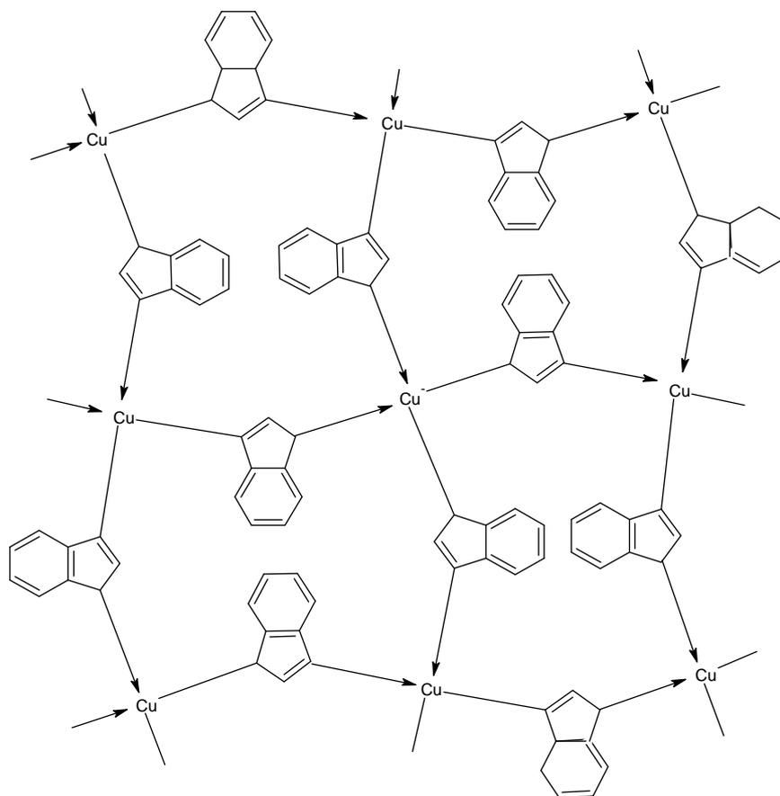
Figure 26 : Structure du réseau de complexes cuivriques Cu(II)-(BTA)<sub>2</sub> [97]
