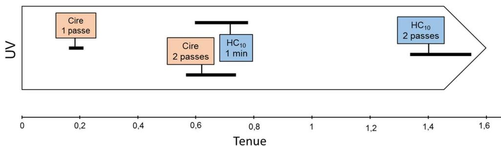
Figure 186 : Echelle de tenue des traitements de protection sous rayonnement UV (les barres noires correspondent aux incertitudes)
