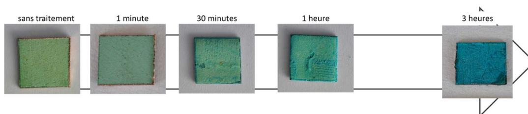
Figure 191 : Evolution de la coloration de la couche de produits de corrosion en fonction du temps d'immersion dans la solution d' $\text{HC}_{10}$
