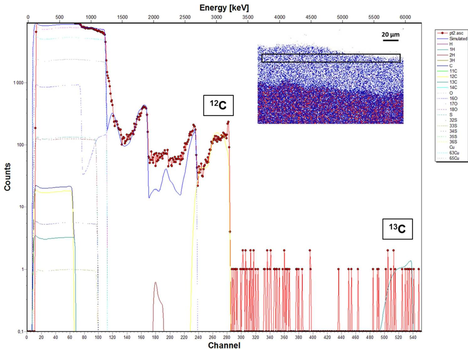
Figure XXI : Spectre expérimental et spectre simulé acquis sur la zone 2 de la couche de corrosion de l'échantillon traité à l'acide décanoïque dopé au  $^{13}\text{C}$  appliqué par immersion pendant 30 minutes (zone représentée par le rectangle sur la cartographie PIXE du cuivre) avec les contributions du cuivre, du carbone, de l'oxygène, du soufre, de l'hydrogène et de leurs isotopes naturels
