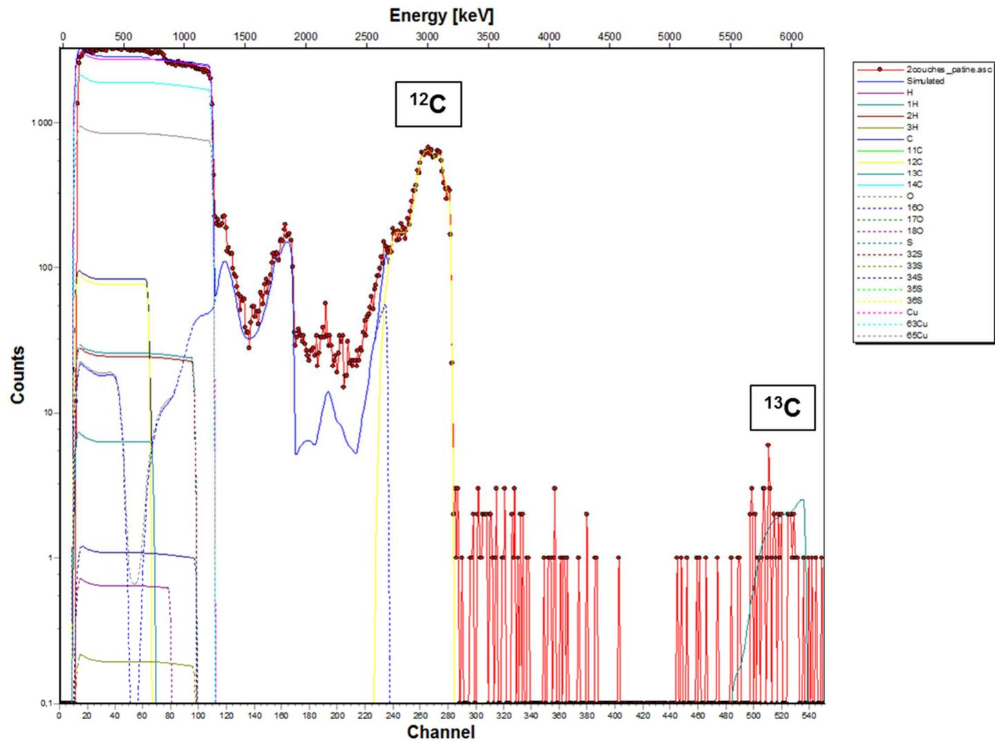
Figure II : Spectre expérimental et spectre simulé acquis sur la couche de corrosion de l'échantillon traité à l'acide décanoïque dopé au  $^{13}\text{C}$  appliqué au pinceau en deux couches avec les contributions du cuivre, du carbone, de l'oxygène, du soufre, de l'hydrogène et de leurs isotopes naturels
