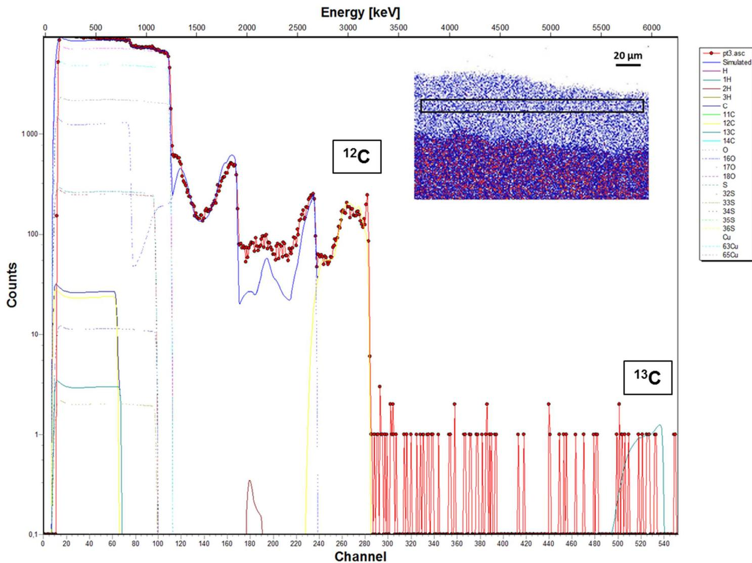
Figure XXII : Spectre expérimental et spectre simulé acquis sur la zone 3 de la couche de corrosion de l'échantillon traité à l'acide décanoïque dopé au  $^{13}\text{C}$  appliqué par immersion pendant 30 minutes (zone représentée par le rectangle sur la cartographie PIXE du cuivre) avec les contributions du cuivre, du carbone, de l'oxygène, du soufre, de l'hydrogène et de leurs isotopes naturels
