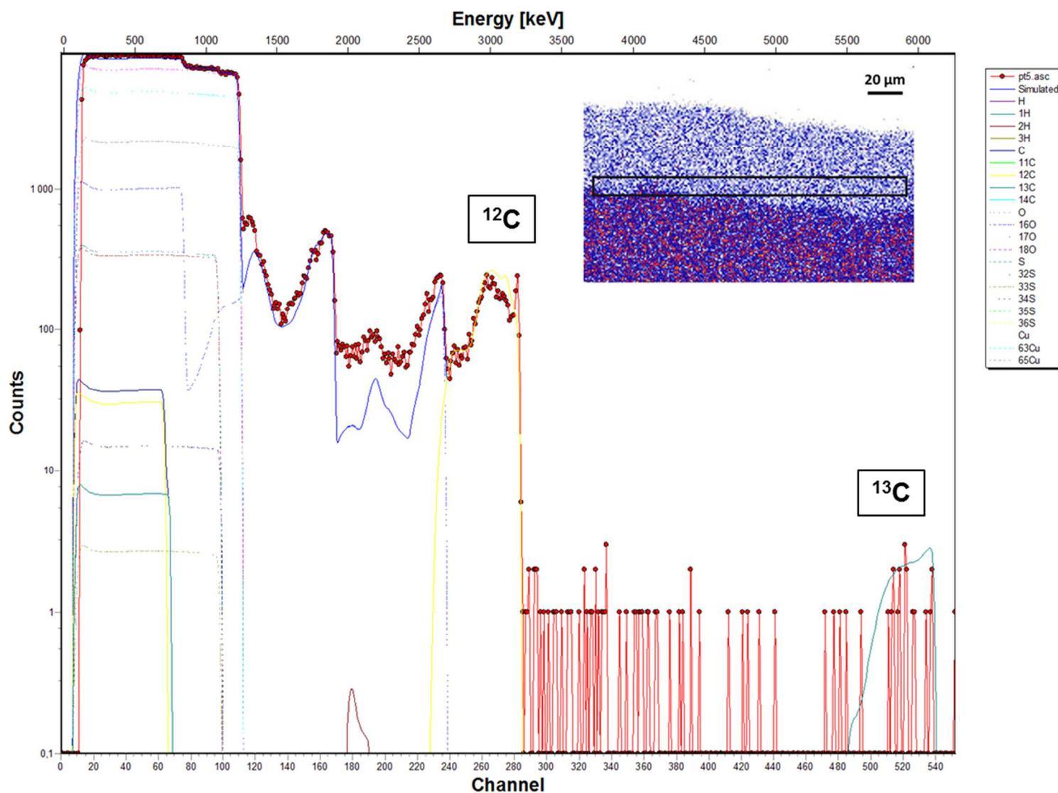
Figure XXIV : Spectre expérimental et spectre simulé acquis sur la zone 5 de la couche de corrosion de l'échantillon traité à l'acide décanoïque dopé au  $^{13}\text{C}$  appliqué par immersion pendant 30 minutes (zone représentée par le rectangle sur la cartographie PIXE du cuivre) avec les contributions du cuivre, du carbone, de l'oxygène, du soufre, de l'hydrogène et de leurs isotopes naturels
