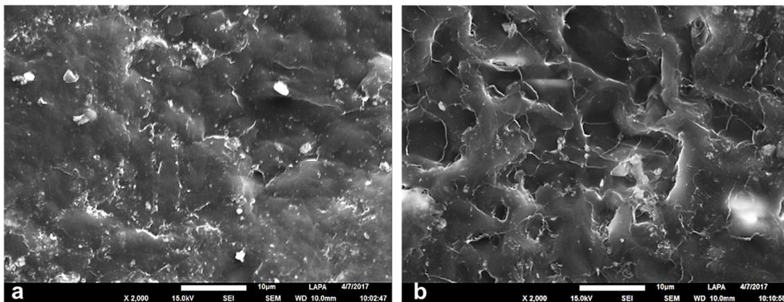
Figure 130 : Micrographies MEB en SE des échantillons traités à la cire Cosmolloid en une passe à chaud (a) et en deux passes à froid (b)
