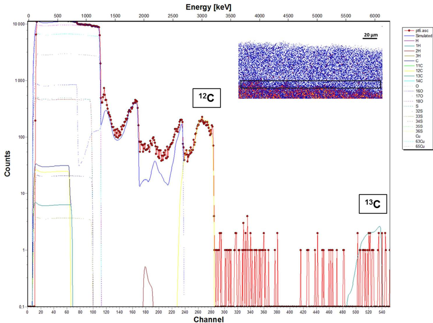
Figure XII : Spectre expérimental et spectre simulé acquis sur la zone 6 de la couche de corrosion de l'échantillon traité à l'acide décanoïque dopé au  $^{13}\text{C}$  appliqué par immersion pendant 1 minute (zone représentée par le rectangle sur la cartographie PIXE du cuivre) avec les contributions du cuivre, du carbone, de l'oxygène, du soufre, de l'hydrogène et de leurs isotopes naturels
