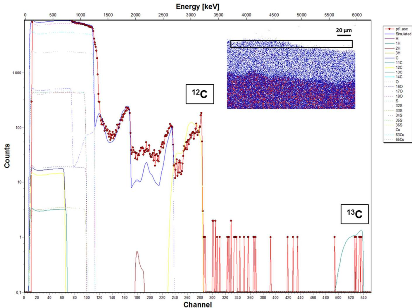
Figure XX : Spectre expérimental et spectre simulé acquis sur la zone 1 de la couche de corrosion de l'échantillon traité à l'acide décanoïque dopé au  $^{13}C$  appliqué par immersion pendant 30 minutes (zone représentée par le rectangle sur la cartographie PIXE du cuivre) avec les contributions du cuivre, du carbone, de l'oxygène, du soufre, de l'hydrogène et de leurs isotopes naturels
