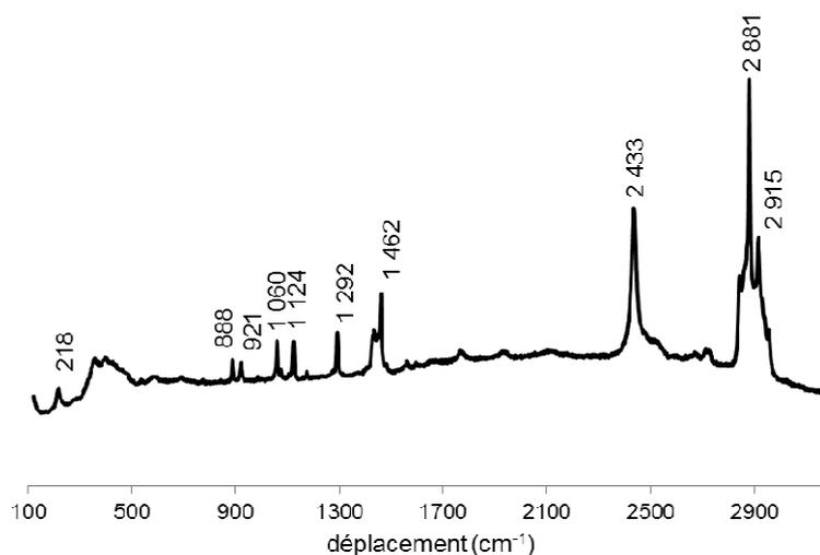
Figure 58 : Spectre  $\mu$ Raman du décanoate de sodium
