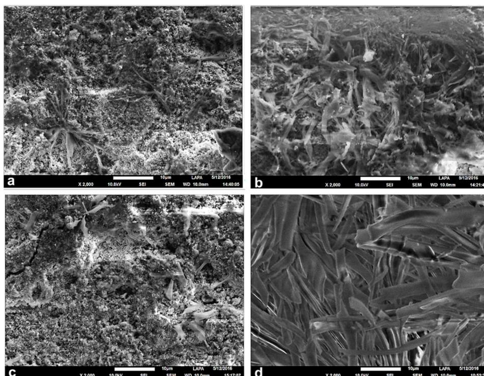
Figure 173 : Micrographies MEB en SE des surfaces des échantillons traités par la solution  $HC_{10}$  appliquée au pinceau en 2 passes (a) et 4 passes (b) ou par immersion pendant 5 minutes (c) et 3 heures (d)
