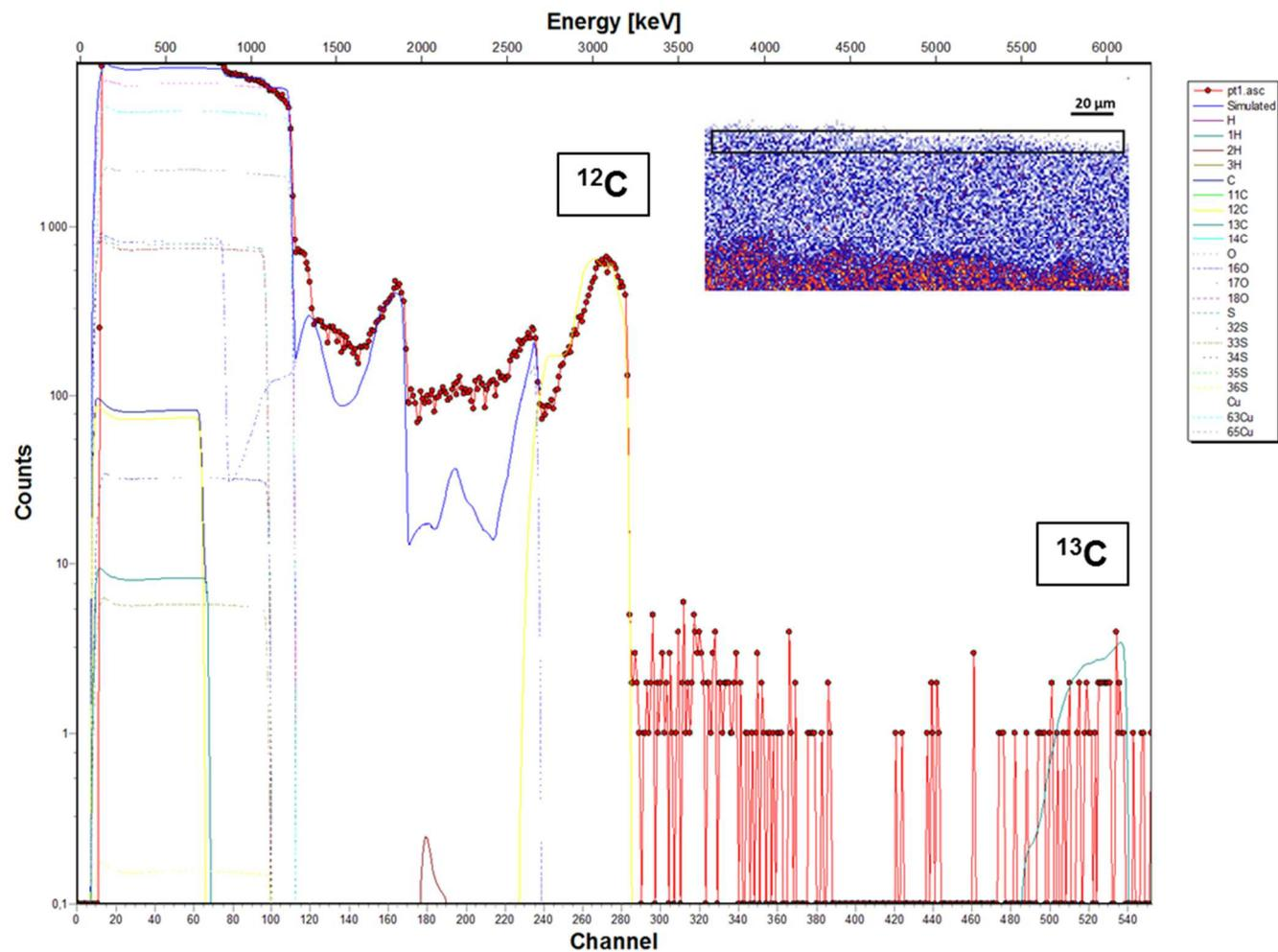
Figure VII : Spectre expérimental et spectre simulé acquis sur la zone 1 de la couche de corrosion de l'échantillon traité à l'acide décanoïque dopé au  $^{13}\text{C}$  appliqué par immersion pendant 1 minute (zone représentée par le rectangle sur la cartographie PIXE du cuivre) avec les contributions du cuivre, du carbone, de l'oxygène, du soufre, de l'hydrogène et de leurs isotopes naturels
