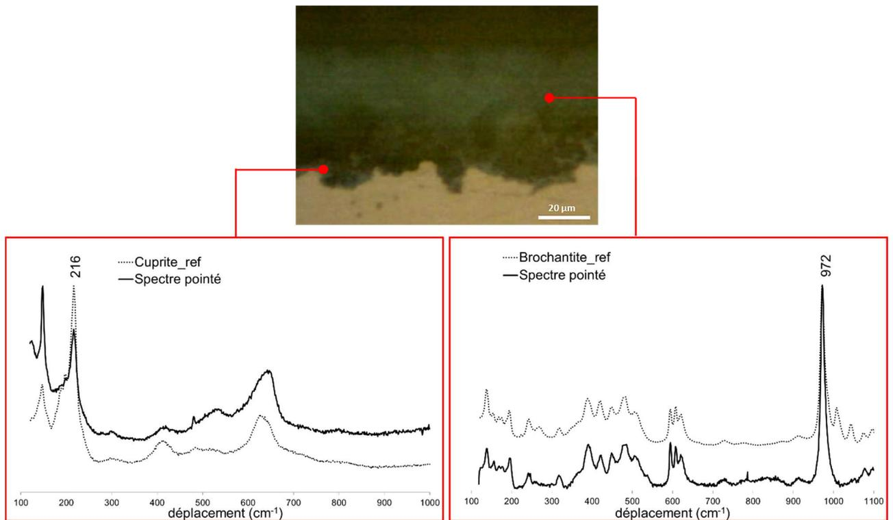
Figure 101 : Spectres  $\mu$ Raman obtenu par pointé dans les parties interne et externe de la couche de produit de corrosion de l'échantillon de Dijon ; spectres Raman de la cuprite et de la brochantite de référence
