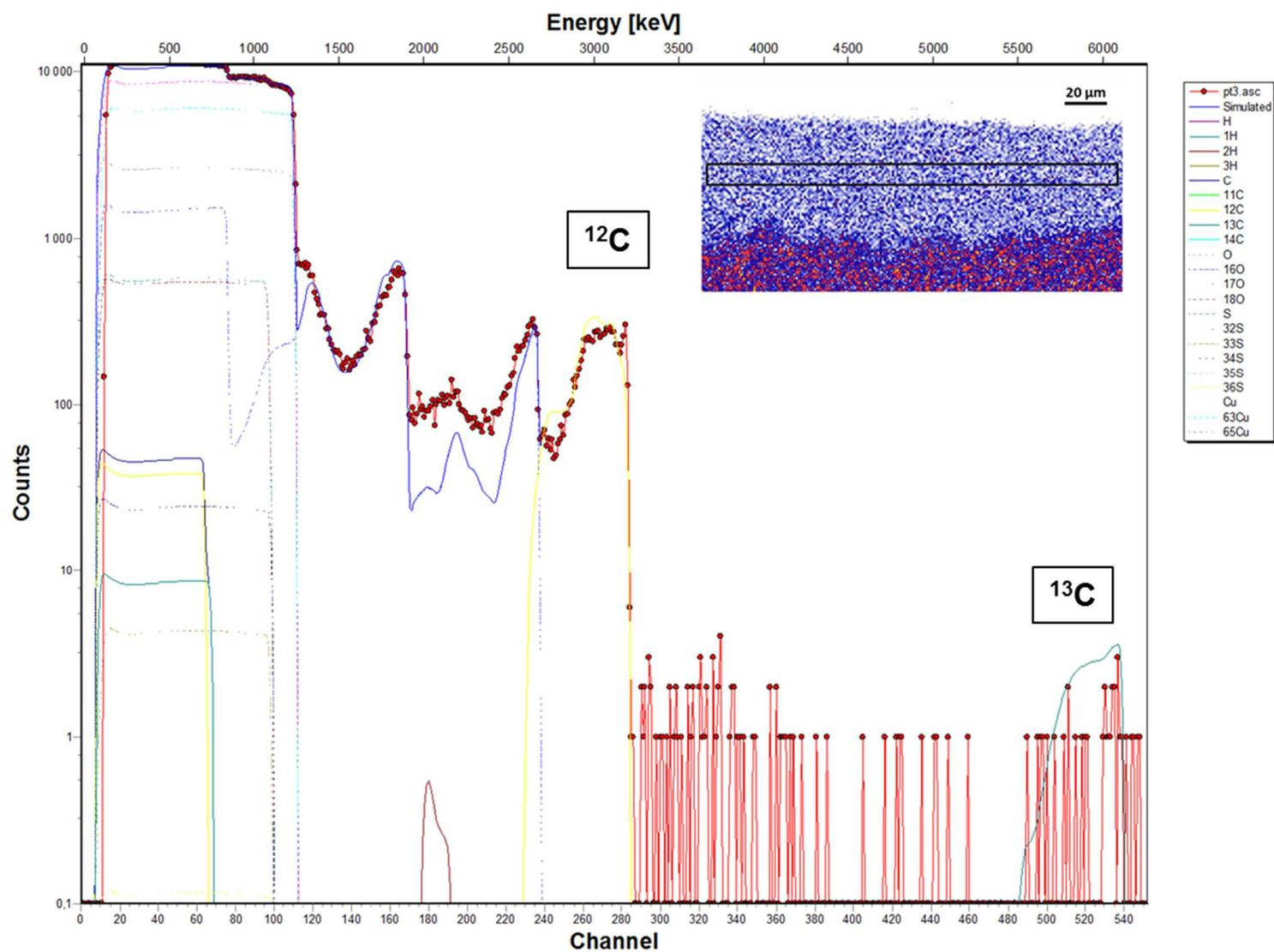
Figure XVI : Spectre expérimental et spectre simulé acquis sur la zone 3 de la couche de corrosion de l'échantillon traité à l'acide décanoïque dopé au  $^{13}\text{C}$  appliqué par immersion pendant 5 minutes (zone représentée par le rectangle sur la cartographie PIXE du cuivre) avec les contributions du cuivre, du carbone, de l'oxygène, du soufre, de l'hydrogène et de leurs isotopes naturels
