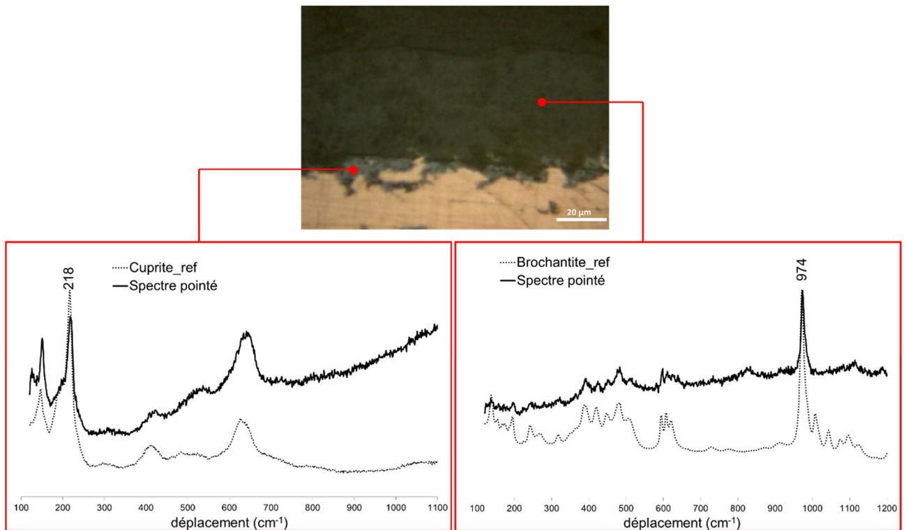
Figure 99 : Spectres  $\mu$ Raman obtenu par pointé dans les parties interne et externe de la couche de produit de corrosion de l'échantillon de Metz ; spectres Raman de la cuprite et de la brochantite de référence
