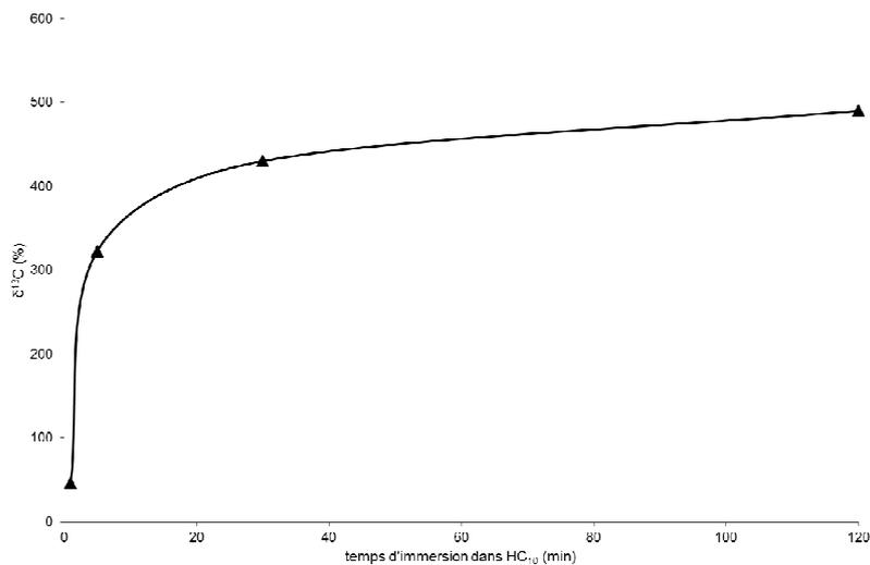
Figure 154 : Enrichissement en carbone-13 dans les couches de corrosion en fonction du temps d'immersion dans la solution d' $\text{H}^{13}\text{C}_{10}$
