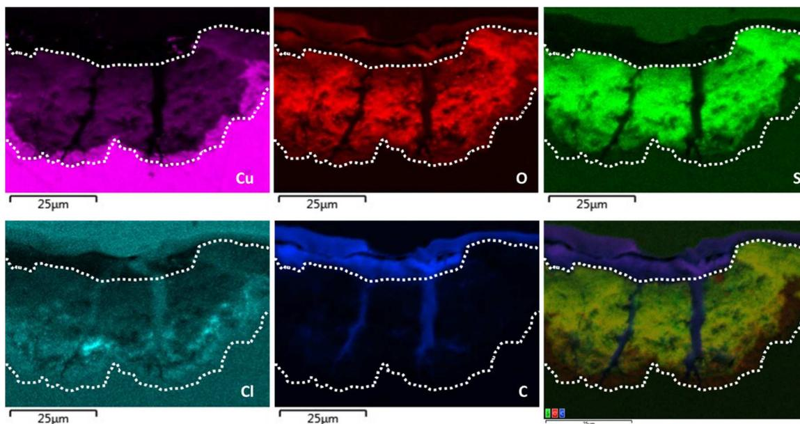
Figure 139 : Cartographies EDS du cuivre (raie  $K_{\alpha}$ ), de l'oxygène (raie  $K_{\alpha}$ ), du soufre (raie  $K_{\alpha}$ ) du chlore (raie  $K_{\alpha}$ ) et du carbone (raie  $K_{\alpha}$ ) de l'échantillon traité la cire Cosmolloïd en une passe à chaud. La dernière cartographie est une superposition des cartographies du soufre (vert), de l'oxygène (rouge) et du carbone (bleu)
