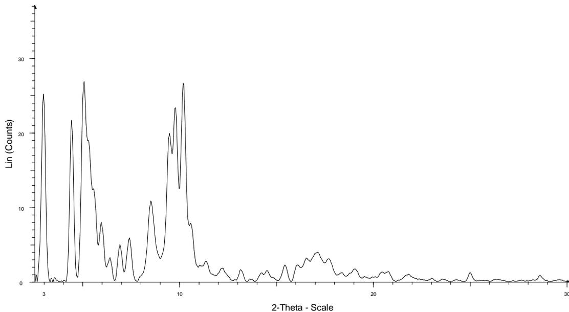
Figure 72 : Diffractogramme du décanoate de cuivre synthétisé
