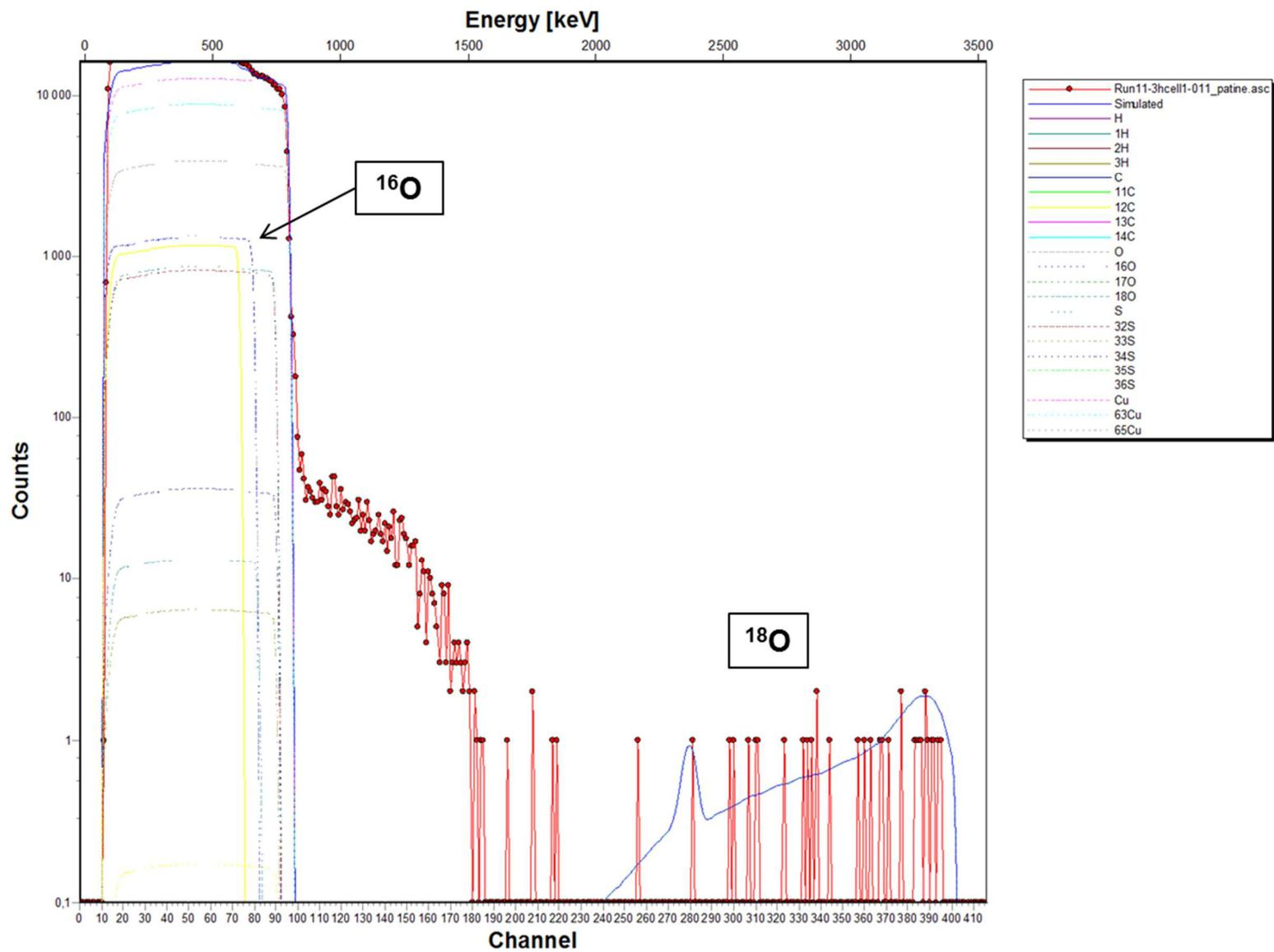
Figure XLIII : Spectre expérimental et spectre simulé acquis sur la couche de corrosion de l'échantillon immergé 3 heures dans l'acide décanoïque et remis en corrosion sous  $^{18}\text{O}$ , avec les contributions du cuivre, de l'oxygène, du soufre, de l'hydrogène et de leurs isotopes naturels
