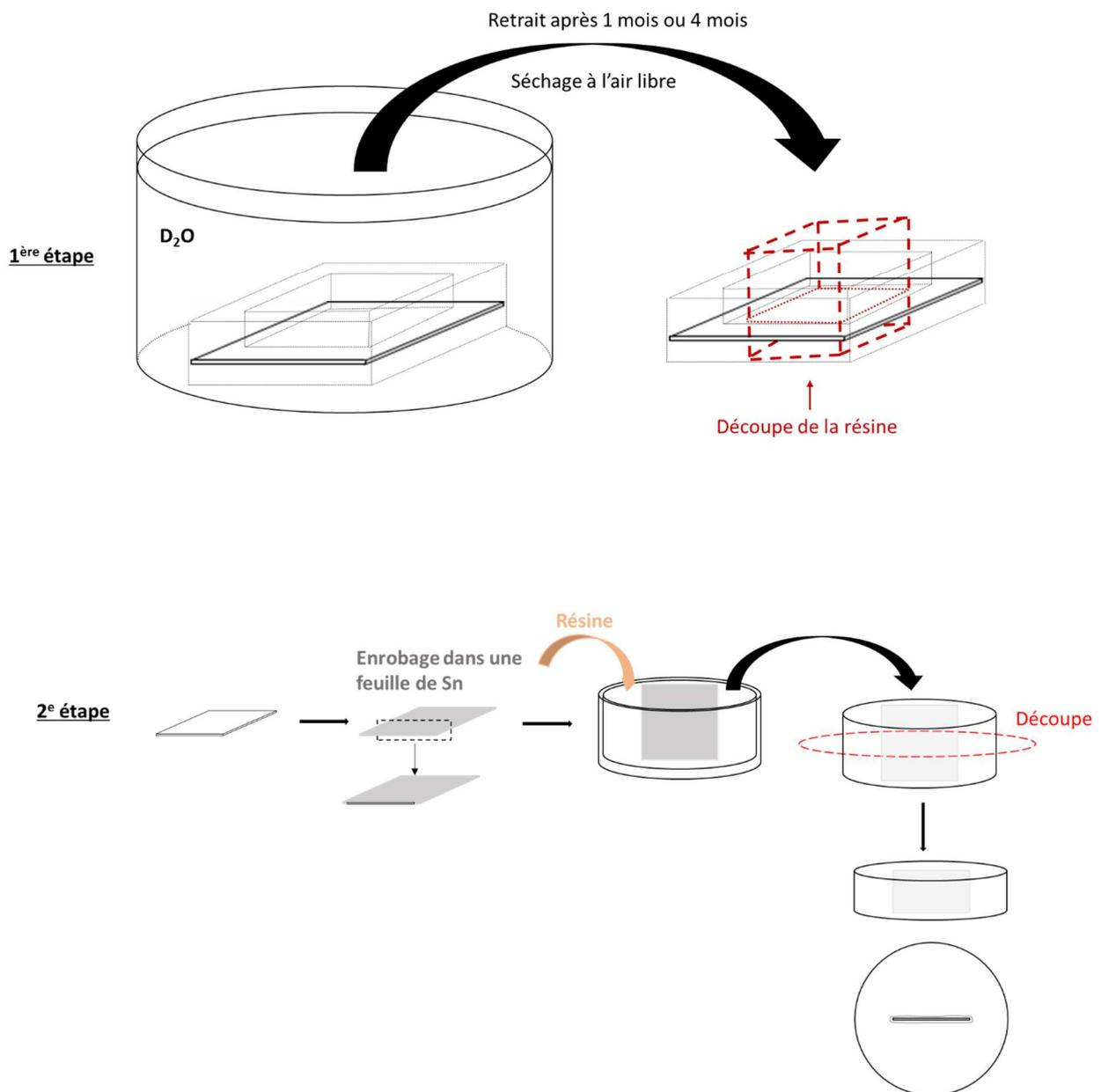
Figure 44 : Schéma récapitulatif de l'immersion des échantillons dans le D<sub>2</sub>O et de leur préparation en coupe transverse
