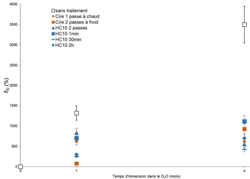
Figure 183 : Enrichissements en deutérium dans les couches de corrosion en fonction du temps d'immersion dans le D<sub>2</sub>O
