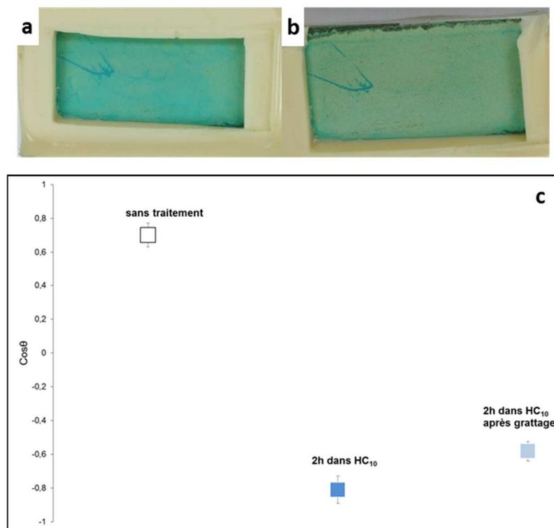
Figure 193 : Echantillon immergé pendant 2 heures dans HC<sub>10</sub> avant (a) et après (b) élimination de la couche bleue superficielle ; Angles de contact entre la goutte et la surface des échantillons sans traitement, immergé 2 heures dans HC<sub>10</sub> avant et après élimination de la couche bleue superficielle (Résultats E. Ferrari)
