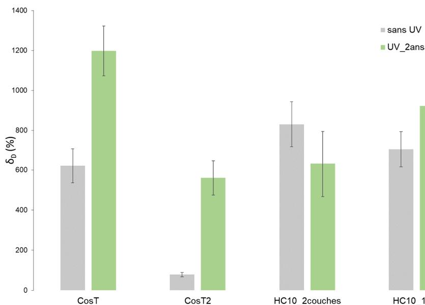
Figure 161 : Valeurs de  $\delta_D$  dans les couches externes des échantillons traités avant et après altération sous rayonnement UV et immergés 1 mois dans le  $D_2O$
