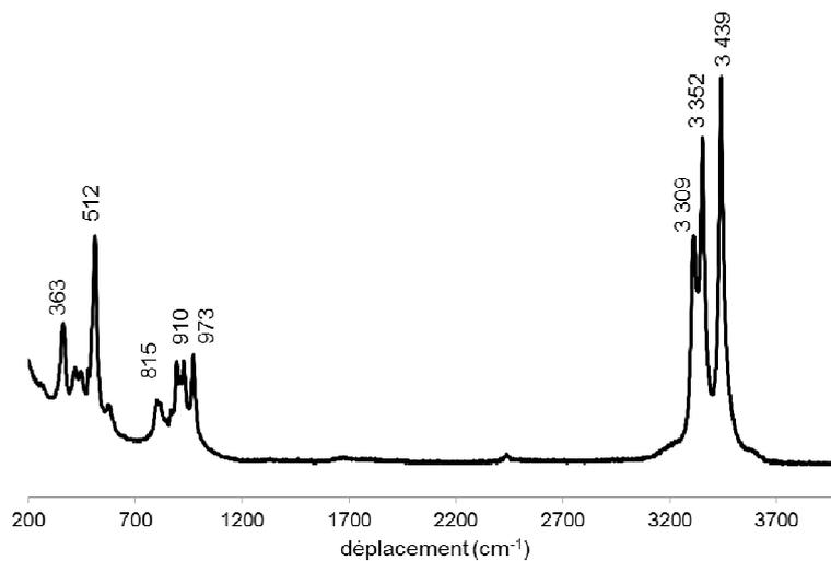
Figure 55 : Spectre  $\mu$ Raman de la paratacamite synthétisée
