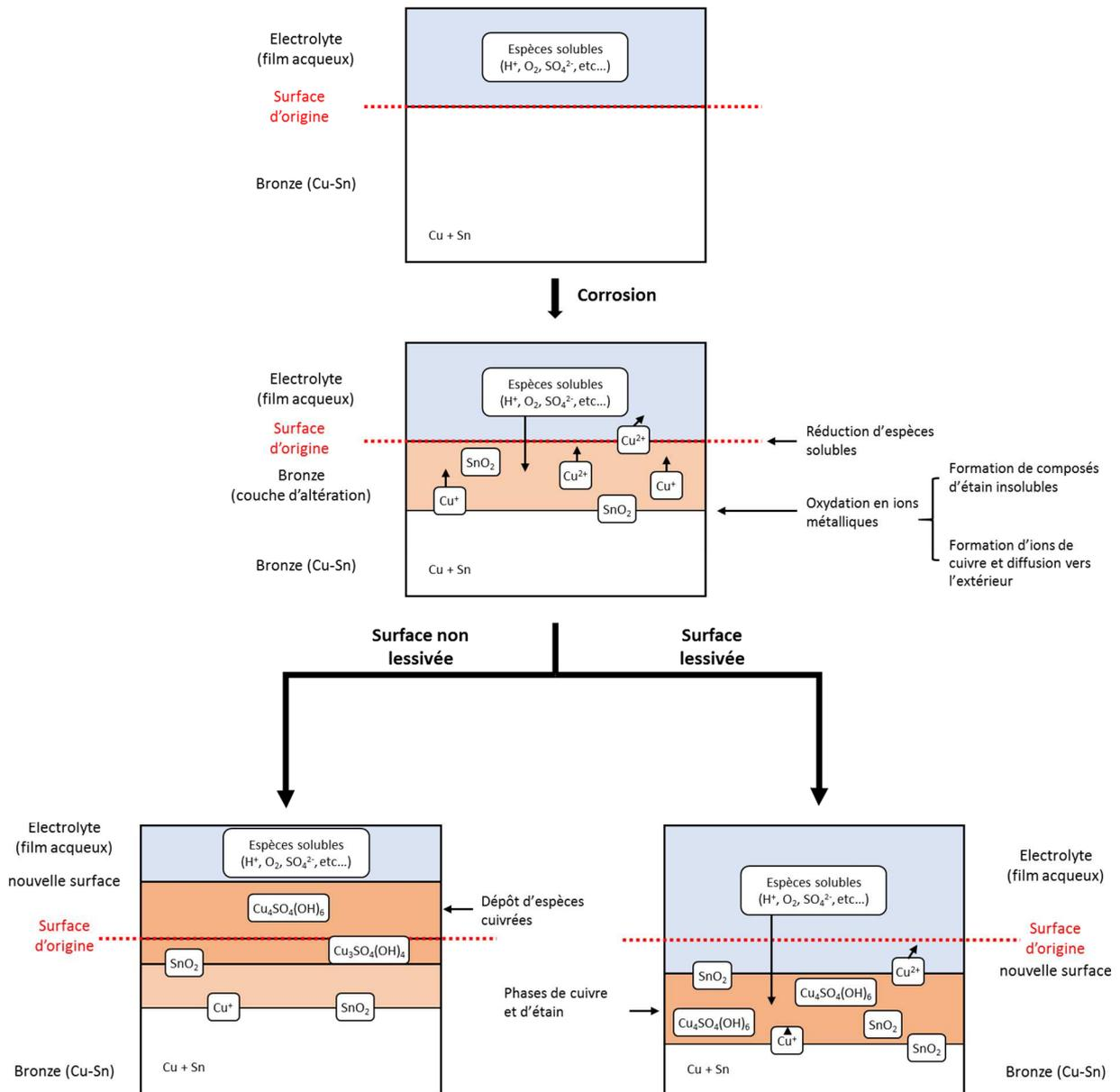
Figure 11 : Schéma récapitulatif de la corrosion atmosphérique du bronze exposé en extérieur [38]
