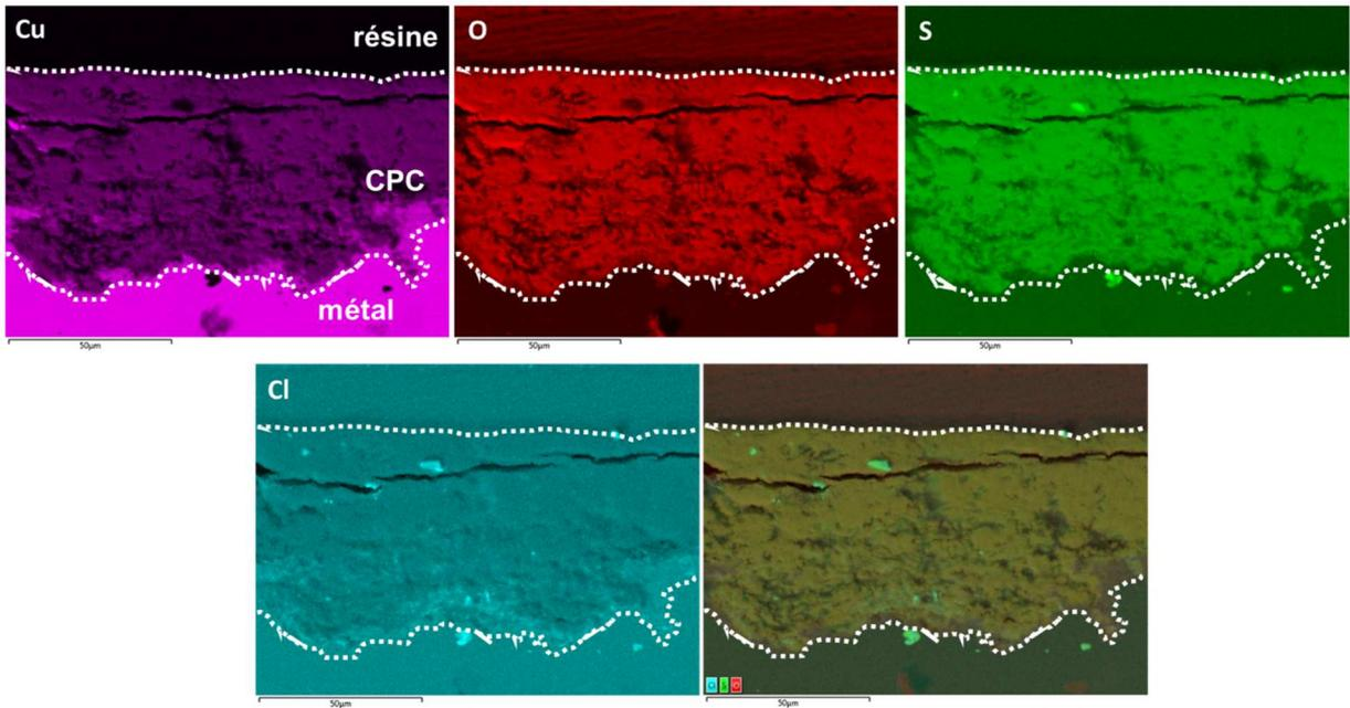
Figure 95 : Cartographies EDS du cuivre (raie  $K\alpha$ ), de l'oxygène (raie  $K\alpha$ ), du soufre (raie  $K\alpha$ ) et du chlore (raie  $K\alpha$ ), et cartographies superposées du soufre, de l'oxygène et du chlore de l'échantillon de Dijon
