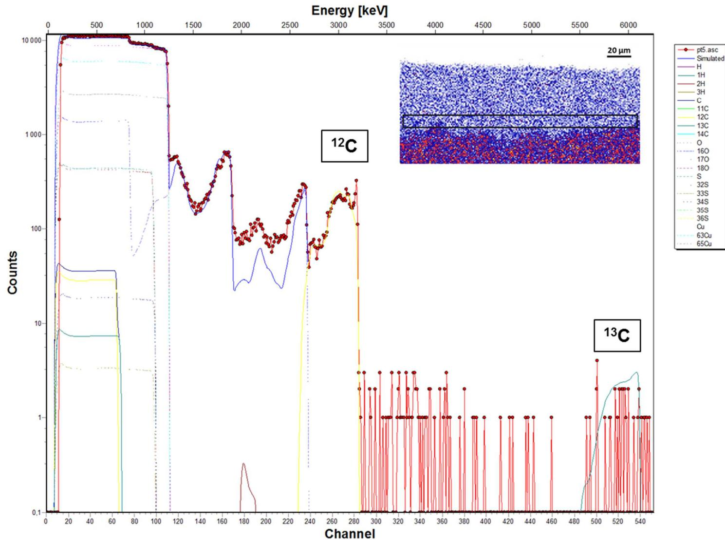
Figure XVIII : Spectre expérimental et spectre simulé acquis sur la zone 5 de la couche de corrosion de l'échantillon traité à l'acide décanoïque dopé au  $^{13}\text{C}$  appliqué par immersion pendant 5 minutes (zone représentée par le rectangle sur la cartographie PIXE du cuivre) avec les contributions du cuivre, du carbone, de l'oxygène, du soufre, de l'hydrogène et de leurs isotopes naturels
