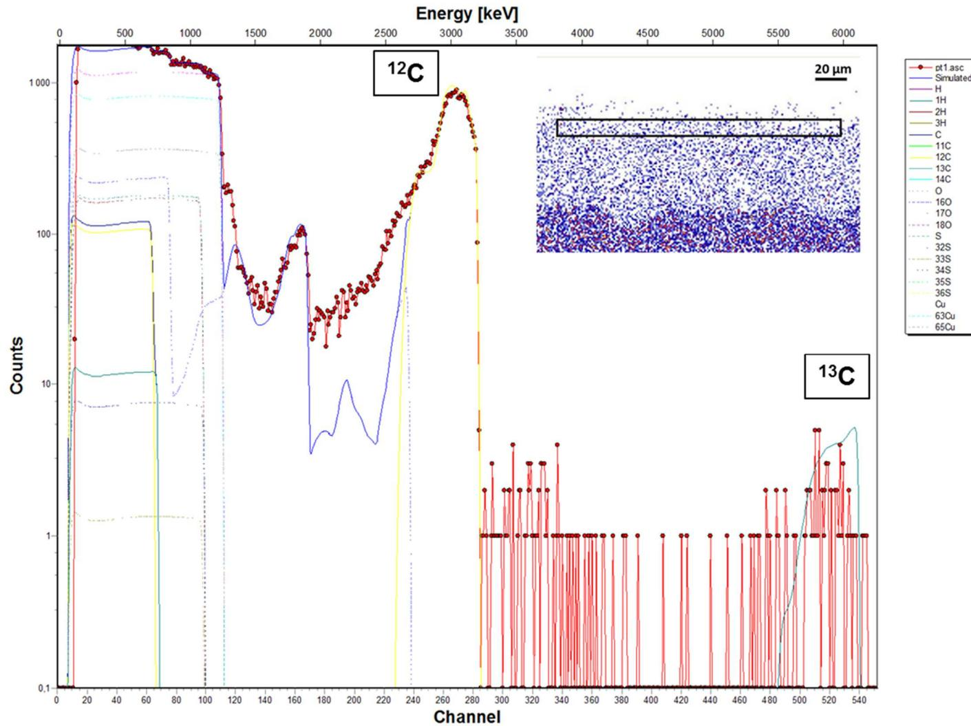
Figure XXVI : Spectre expérimental et spectre simulé acquis sur la zone 1 de la couche de corrosion de l'échantillon traité à l'acide décanoïque dopé au  $^{13}C$  appliqué par immersion pendant 2 heures (zone représentée par le rectangle sur la cartographie PIXE du cuivre) avec les contributions du cuivre, du carbone, de l'oxygène, du soufre, de l'hydrogène et de leurs isotopes naturels
