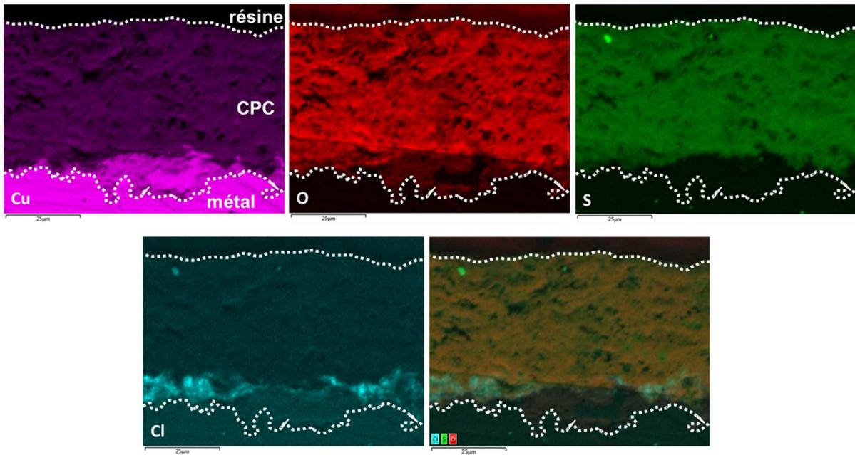
Figure 93 : Cartographies EDS du cuivre (raie  $K_{\alpha}$ ), de l'oxygène (raie  $K_{\alpha}$ ), du soufre (raie  $K_{\alpha}$ ) et du chlore (raie  $K_{\alpha}$ ), et cartographies superposées du soufre, de l'oxygène et du chlore de l'échantillon de Metz
