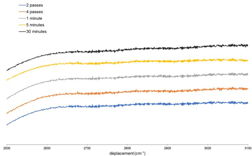
Figure 146 : Spectres  $\mu$ Raman des couches de brochantite des échantillons traités par la solution d' $\text{HC}_{10}$  (gamme spectrale autour de  $3000 \text{ cm}^{-1}$ )
