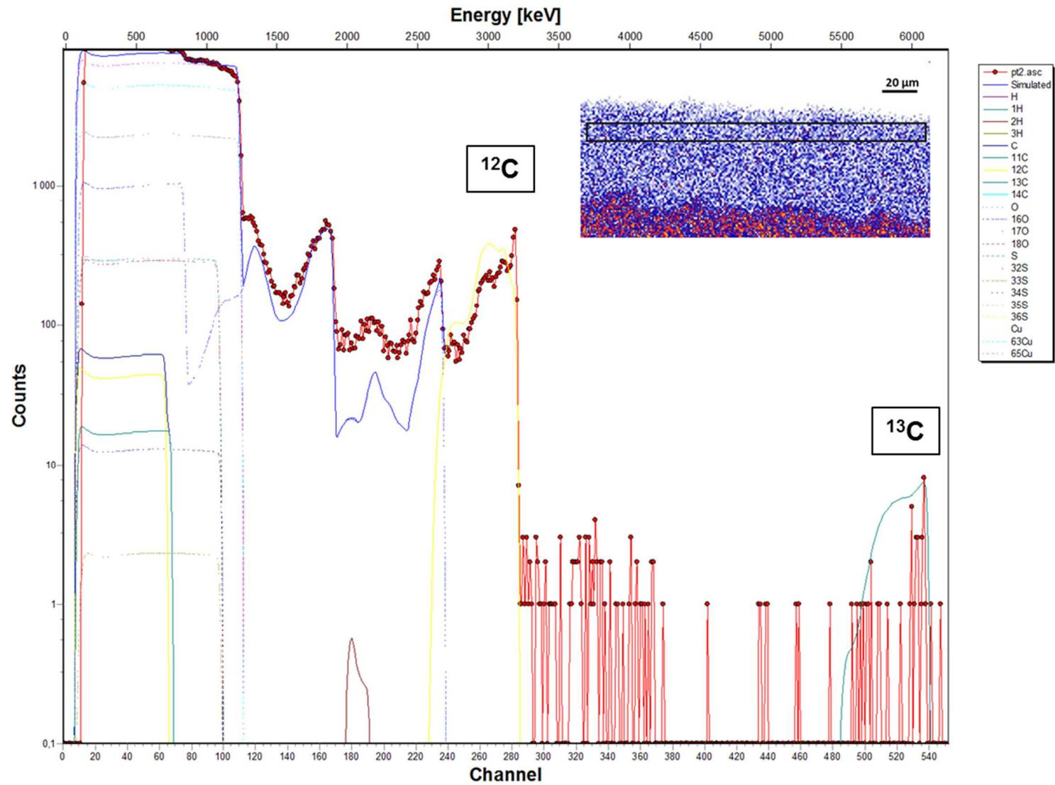
Figure VIII : Spectre expérimental et spectre simulé acquis sur la zone 2 de la couche de corrosion de l'échantillon traité à l'acide décanoïque dopé au  $^{13}\text{C}$  appliqué par immersion pendant 1 minute (zone représentée par le rectangle sur la cartographie PIXE du cuivre) avec les contributions du cuivre, du carbone, de l'oxygène, du soufre, de l'hydrogène et de leurs isotopes naturels
