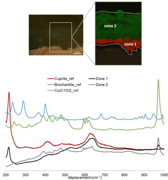
Figure 145 : Cartographie  $\mu$ Raman de la cuprite (rouge) et de la brochantite (vert) ; spectres  $\mu$ Raman moyens des couches interne et externe de l'échantillon immergé dans  $\text{HC}_{10}$  pendant 30 min
