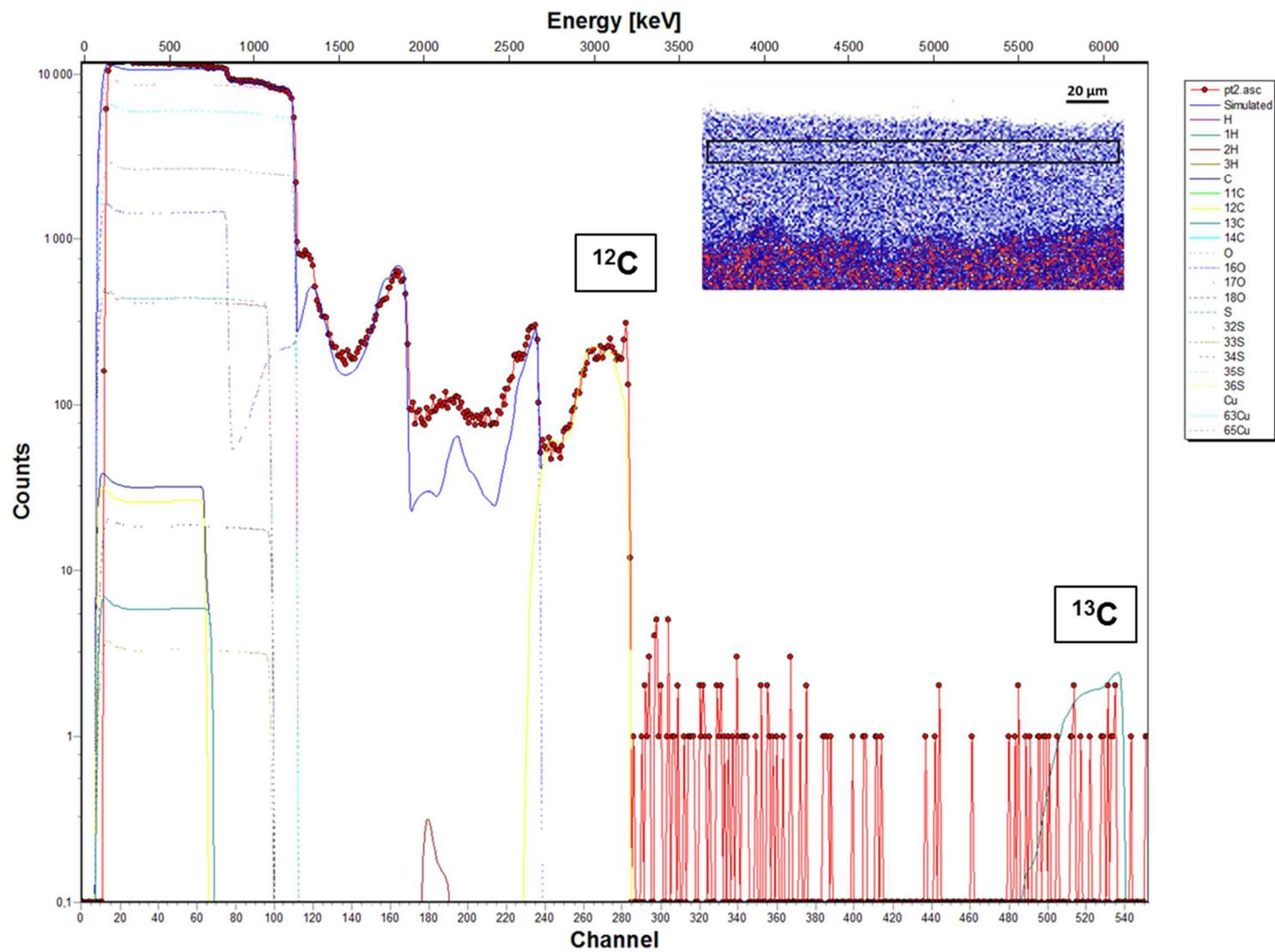
Figure XV : Spectre expérimental et spectre simulé acquis sur la zone 2 de la couche de corrosion de l'échantillon traité à l'acide décanoïque dopé au  $^{13}\text{C}$  appliqué par immersion pendant 5 minutes (zone représentée par le rectangle sur la cartographie PIXE du cuivre) avec les contributions du cuivre, du carbone, de l'oxygène, du soufre, de l'hydrogène et de leurs isotopes naturels
