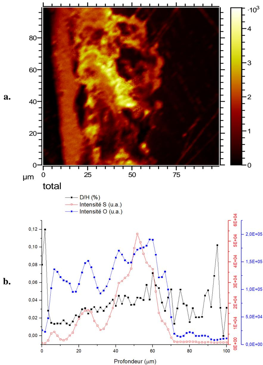
Figure XXXIII : Superposition des cartographies de  $\text{S}^{2-}$  et  $\text{CuO}^-$  de l'échantillon de Metz protégé à la cire Cosmolloïd® appliquée en deux couches (a) et profil d'enrichissement en D/H (noir), profil d'intensité du soufre (rouge) et de l'oxygène (bleu) (b)
