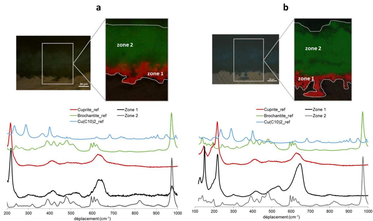
Figure 143 : Cartographies  $\mu$ Raman de la cuprite (rouge) et de la brochantite (vert) ; spectres  $\mu$ Raman moyens des couches interne et externe des échantillons traités par HC<sub>10</sub> au pinceau en 2 passes (a) en en 4 passes (b)
