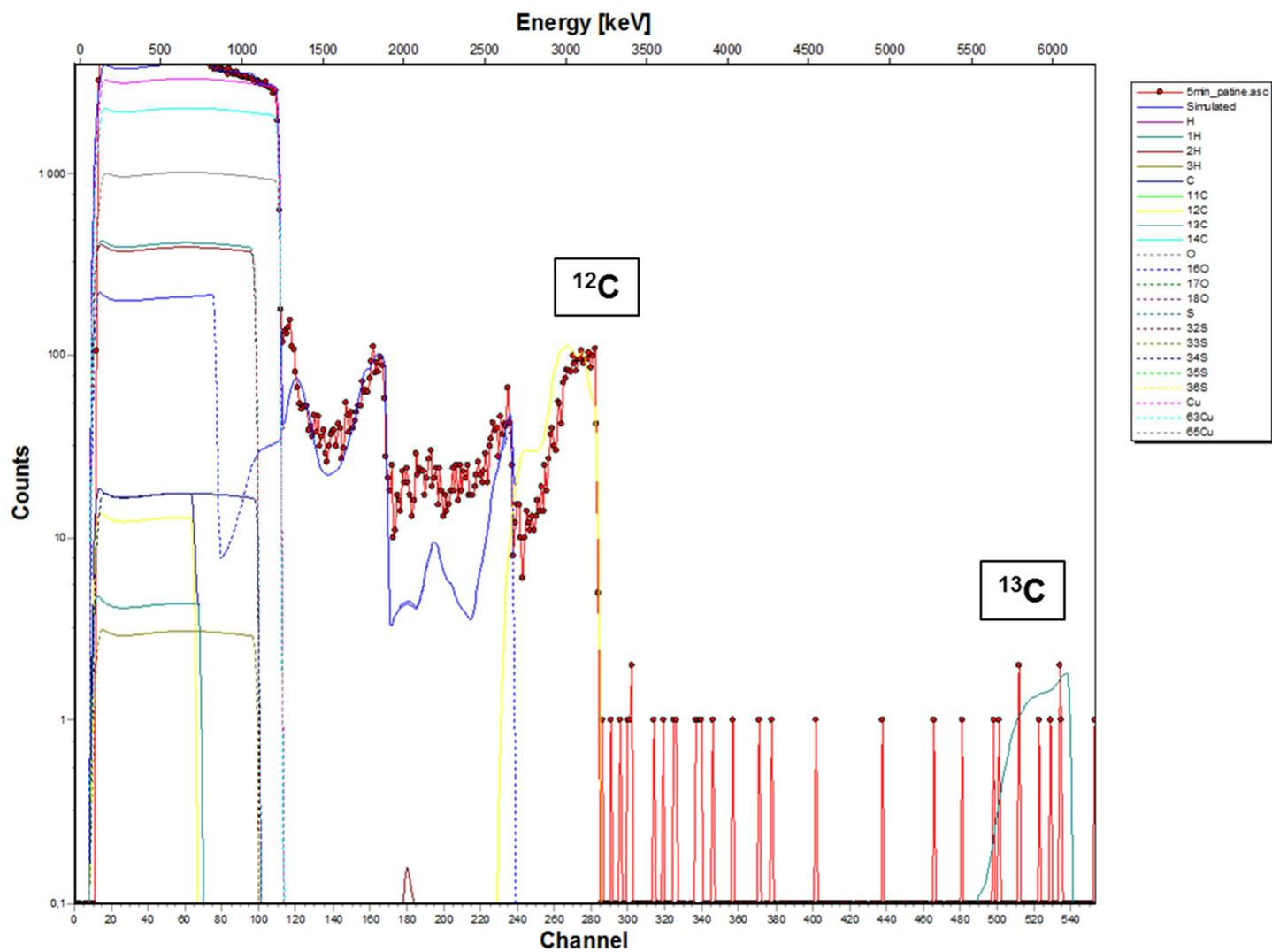
Figure IV : Spectre expérimental et spectre simulé acquis sur la couche de corrosion de l'échantillon traité à l'acide décanoïque dopé au  $^{13}\text{C}$  appliqué par immersion pendant 5 minutes avec les contributions du cuivre, du carbone, de l'oxygène, du soufre, de l'hydrogène et de leurs isotopes naturels
