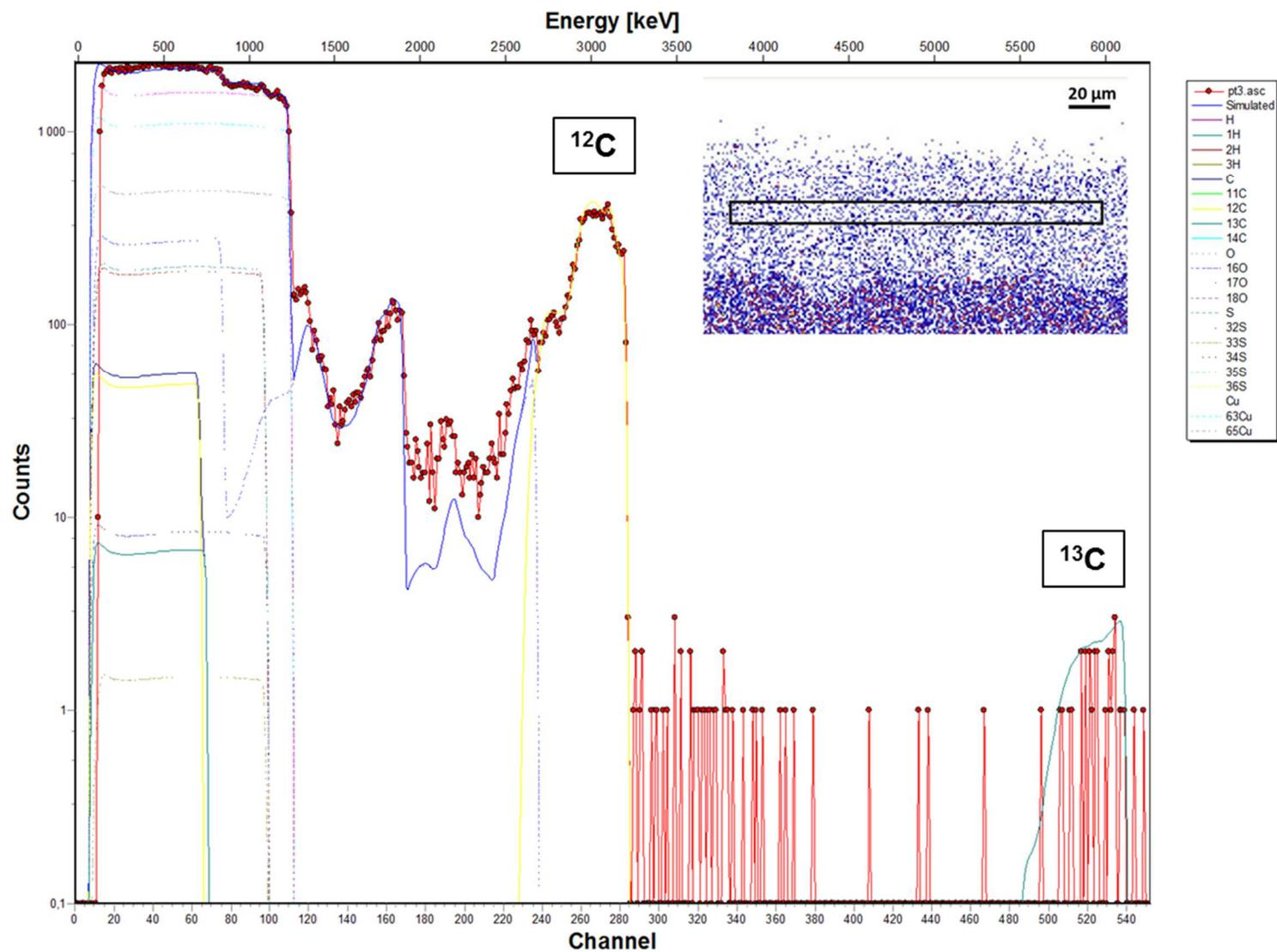
Figure XXVIII : Spectre expérimental et spectre simulé acquis sur la zone 3 de la couche de corrosion de l'échantillon traité à l'acide décanoïque dopé au  $^{13}\text{C}$  appliqué par immersion pendant 2 heures (zone représentée par le rectangle sur la cartographie PIXE du cuivre) avec les contributions du cuivre, du carbone, de l'oxygène, du soufre, de l'hydrogène et de leurs isotopes naturels
