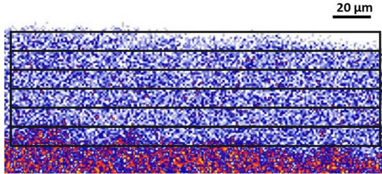
Figure 155 : Cartographie du signal RBS du cuivre sur l'échantillon immergé dans  $H^{13}C_{10}$  pendant 1 min avec les différentes zones de profil
