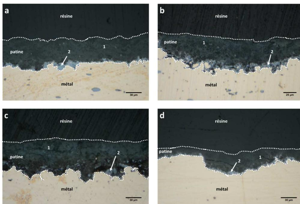
Figure 90 : Micrographies (x50) des échantillons en coupe transverse de la cathédrale de Metz (a), de la cathédrale de Chartres (b), de l'église Ste Anne de Dijon (c) et d'un immeuble de Strasbourg (d). Sur chaque échantillon la couche interne (1) et la couche externe (2) sont visibles
