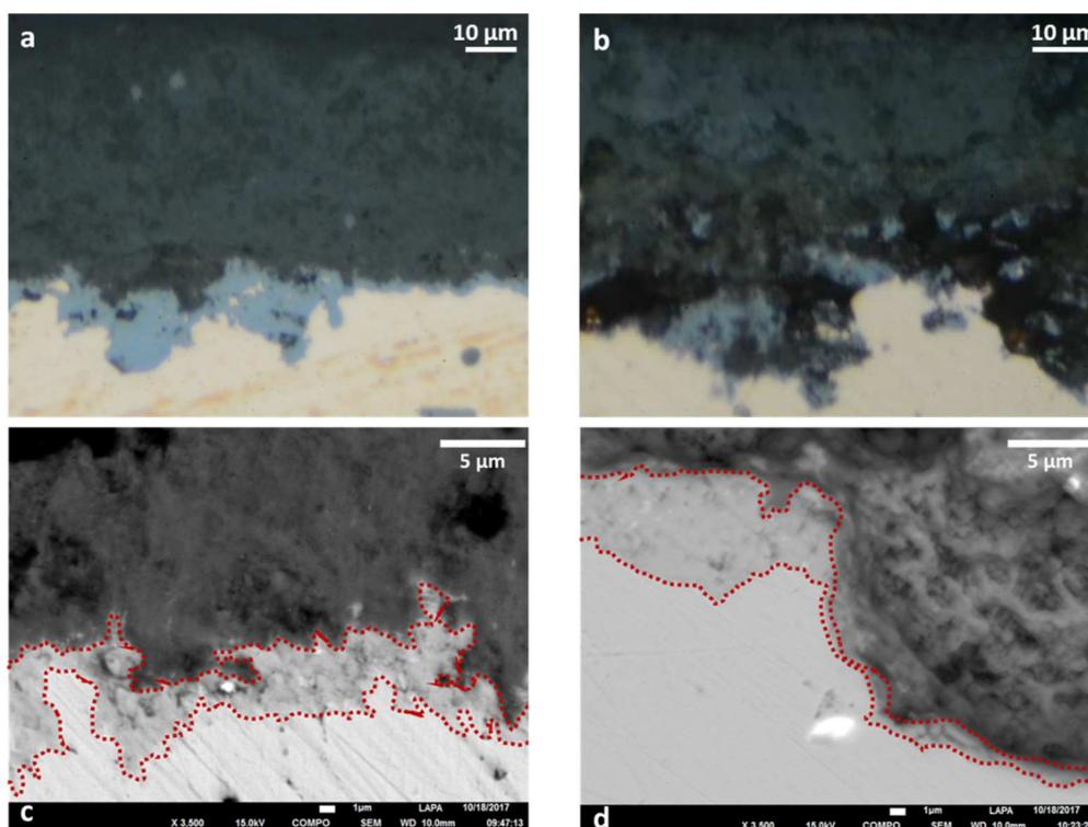
Figure 182 : Micrographies optiques et images en électrons secondaires par microscopie électronique à balayage des échantillons de Metz (a et c) et de Dijon (b et d)
