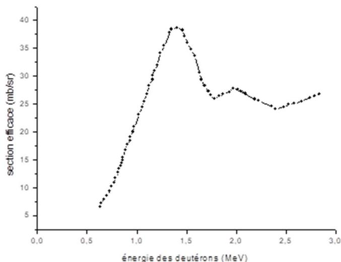
Figure 79 : Section efficace (en millibarn/stéradian) de la réaction  $^{13}\text{C}(d,p_0)^{14}\text{C}$  en fonction de l'énergie du deuteron incident (pour un angle de détection de  $170^\circ$ ) [157]
