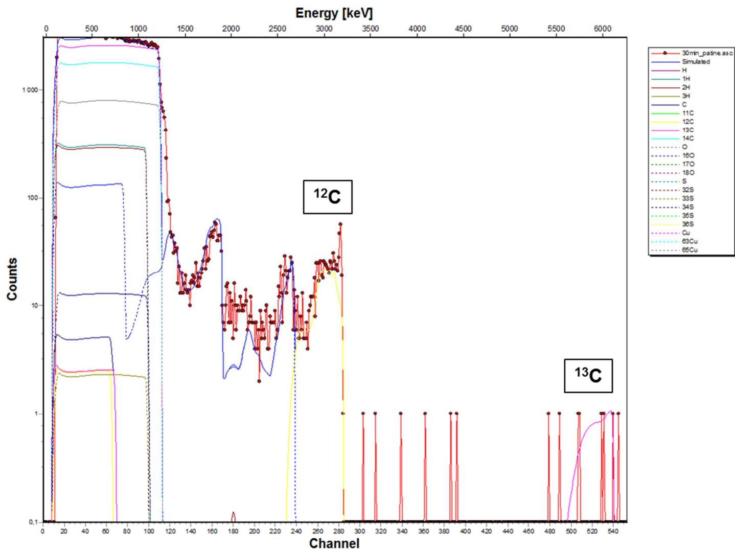
Figure V : Spectre expérimental et spectre simulé acquis sur la couche de corrosion de l'échantillon traité à l'acide décanoïque dopé au  $^{13}\text{C}$  appliqué par immersion pendant 5 minutes avec les contributions du cuivre, du carbone, de l'oxygène, du soufre, de l'hydrogène et de leurs isotopes naturels
