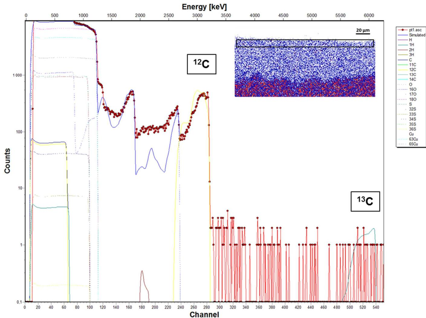
Figure XIV : Spectre expérimental et spectre simulé acquis sur la zone 1 de la couche de corrosion de l'échantillon traité à l'acide décanoïque dopé au  $^{13}C$  appliqué par immersion pendant 5 minutes (zone représentée par le rectangle sur la cartographie PIXE du cuivre) avec les contributions du cuivre, du carbone, de l'oxygène, du soufre, de l'hydrogène et de leurs isotopes naturels
