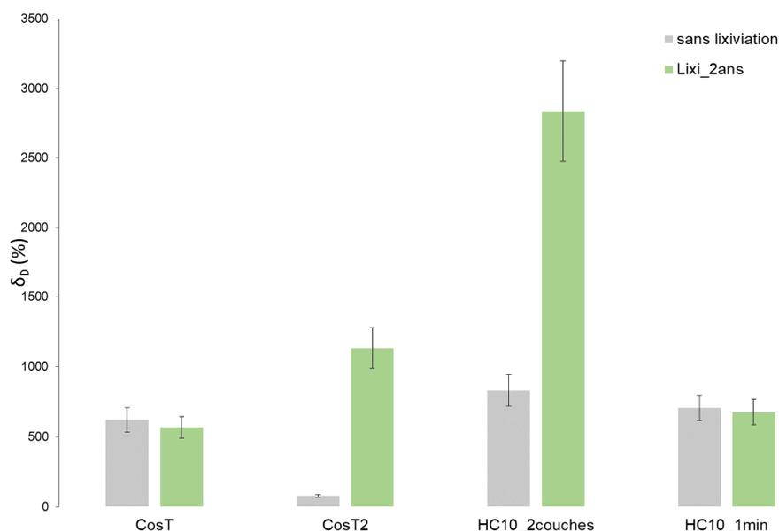
Figure 162 : Valeurs de  $\delta_D$  dans les couches externes des échantillons avant et après altération sous lixiviation et immergés 1 mois dans le D<sub>2</sub>O
