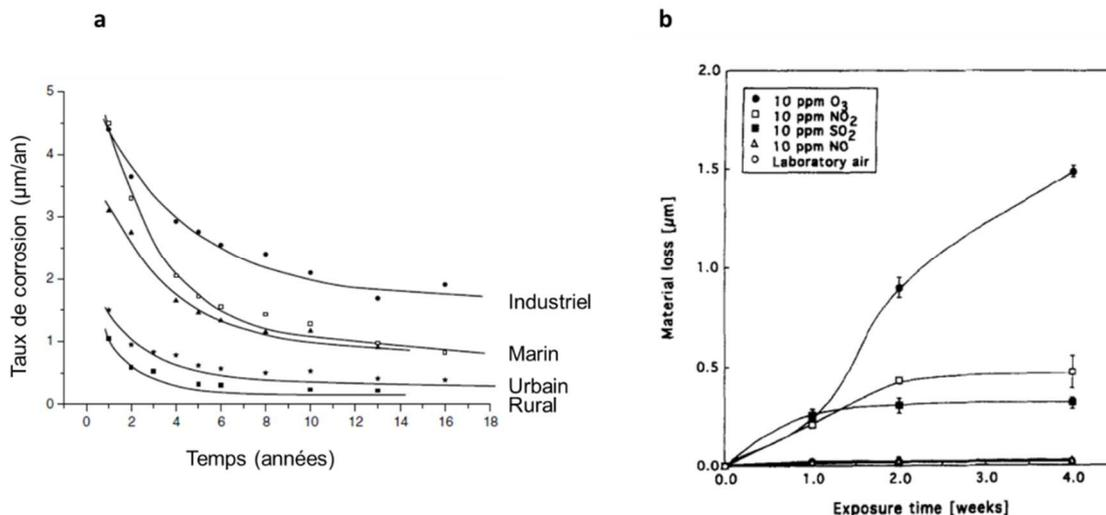
Figure 16 : Variation de la vitesse de corrosion dans différents atmosphères (a) [30] et en fonction de la présence dans l'atmosphère de polluants tels que  $\text{O}_3$ ,  $\text{NO}_2$ ,  $\text{SO}_2$  (b) [31]
