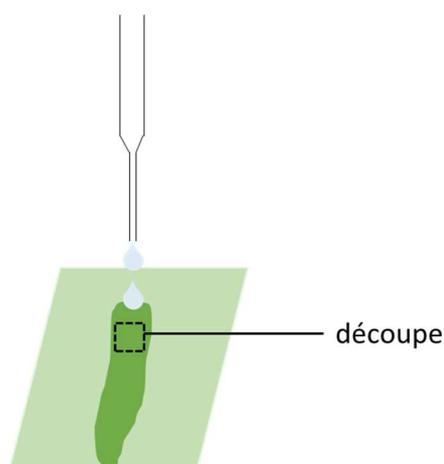
Figure 50 : Schéma de la découpe des échantillons lixiviés
