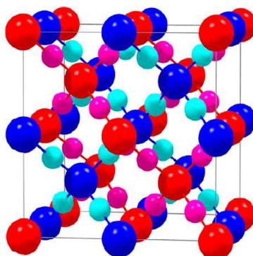
Figure 5 : Structure cristalline de la cuprite  $\text{Cu}_2\text{O}$ . Les cations  $\text{Cu}^+$  coordonnés linéairement sont représentés par des petites boules tandis que les anions  $\text{O}^{2-}$  coordonnés de manière tétraédrique sont représentés par des grosses boules. Les deux réseaux sont différenciés par leur couleur : l'un en rouge et magenta (cfc) et l'autre en bleu et cyan (ccc) [28]
