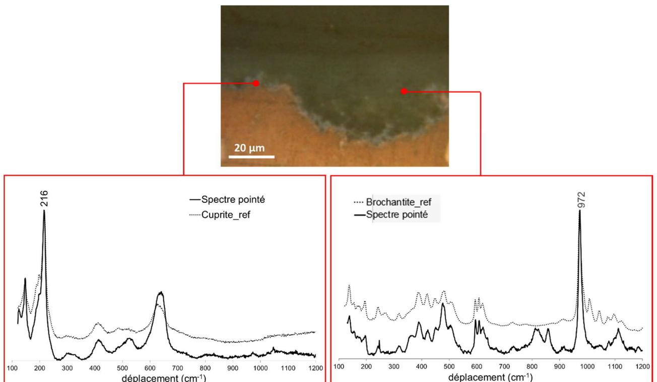
Figure 102 : Spectres  $\mu$ Raman obtenu par pointé dans les parties interne et externe de la couche de produit de corrosion de l'échantillon de Strasbourg ; spectres Raman de la cuprite et de la brochantite de référence
