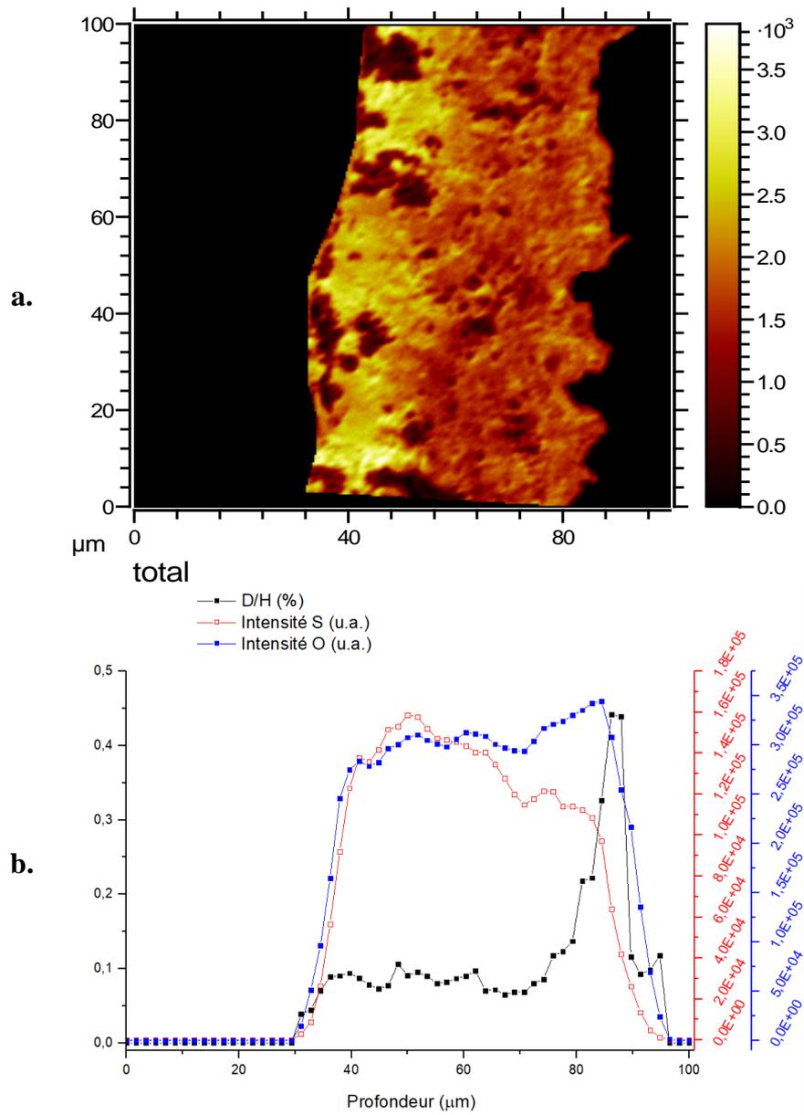
Figure XXXV : Superposition des cartographies de  $\text{S}^{2-}$  et  $\text{CuO}^-$  de l'échantillon de Metz protégé à l'acide décanoïque appliquée par immersion pendant une minute (a) et profil d'enrichissement en D/H (noir), profil d'intensité du soufre (rouge) et de l'oxygène (bleu) (b)
