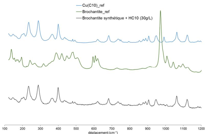
Figure 110 : Spectre  $\mu$ Raman du précipité formé après le mélange de brochantite de synthèse et  $\text{HC}_{10}$  (30g/L) ; spectres Raman de la brochantite et de  $\text{Cu}(\text{C}_{10})_2$
