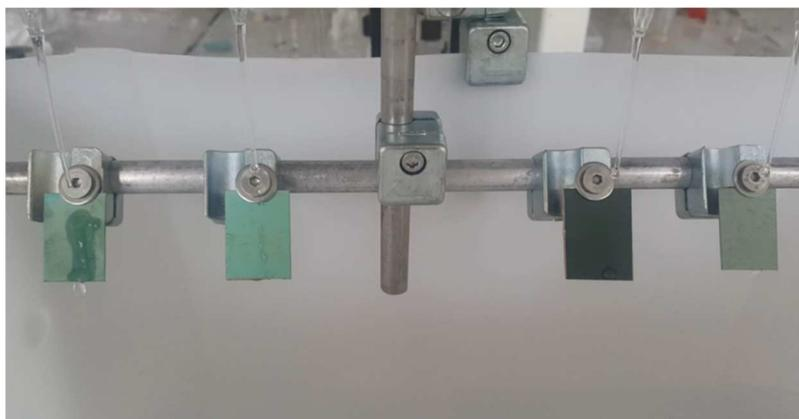
Figure 49 : Montage de lixiviation
