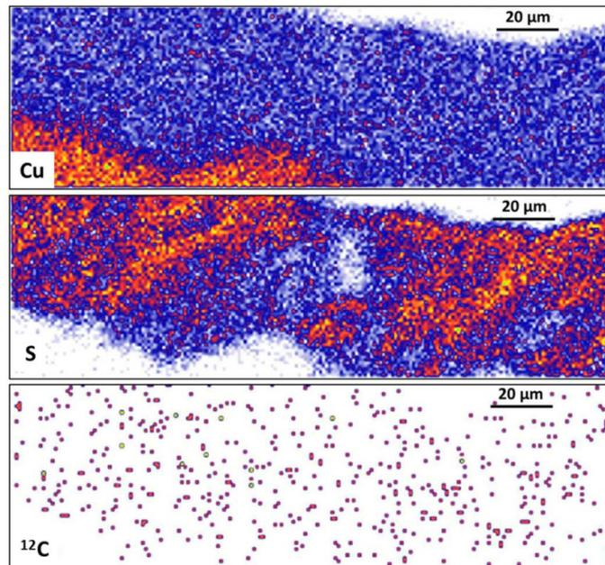
Figure 148 : Cartographies PIXE du cuivre et du soufre (permettent de localiser la couche de produits de corrosion) et cartographies NRA du carbone-12 ( $^{12}C$  (d,p0) $^{13}C$ ) de l'échantillon sans traitement de protection.
