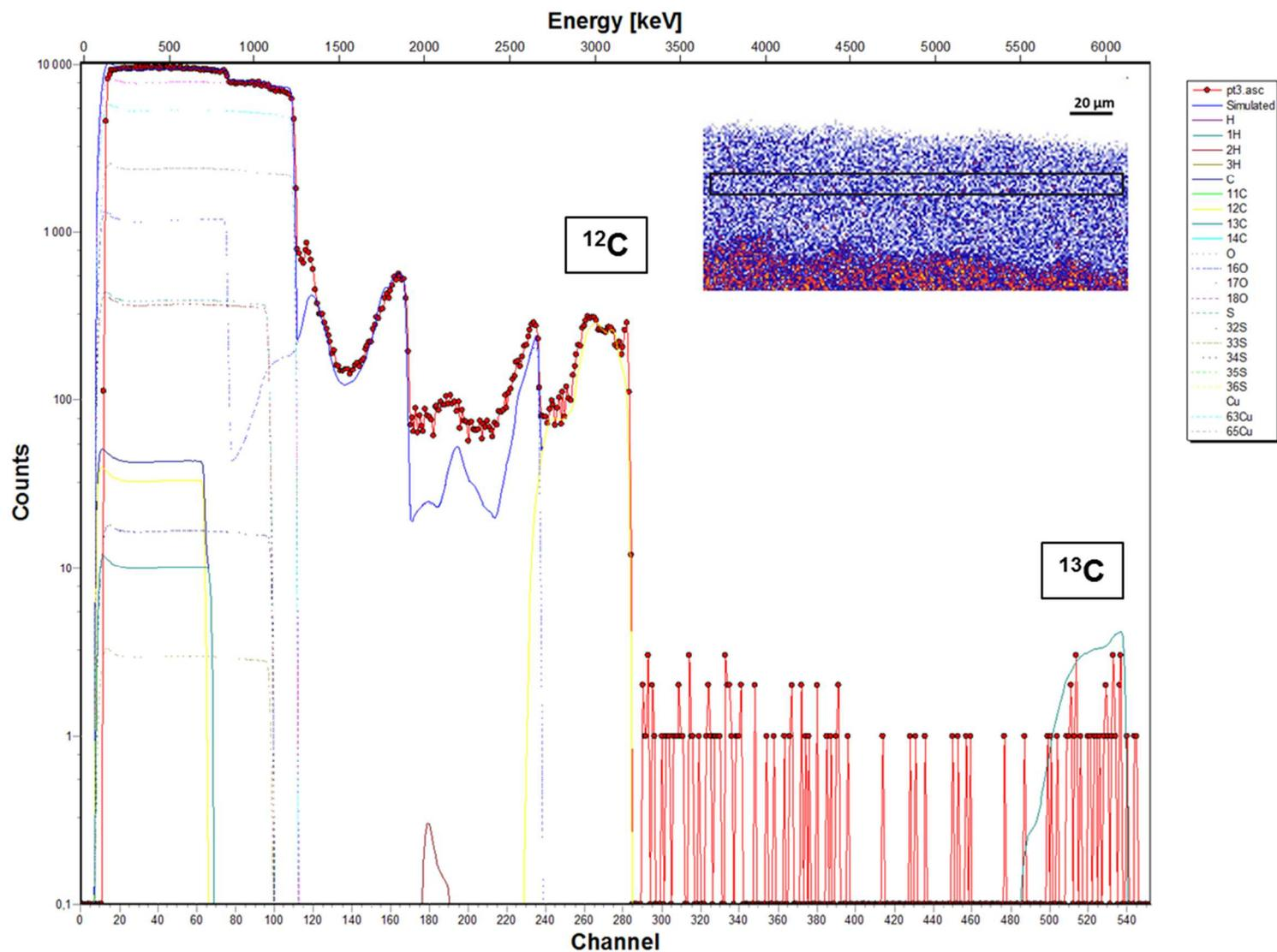
Figure IX : Spectre expérimental et spectre simulé acquis sur la zone 3 de la couche de corrosion de l'échantillon traité à l'acide décanoïque dopé au  $^{13}\text{C}$  appliqué par immersion pendant 1 minute (zone représentée par le rectangle sur la cartographie PIXE du cuivre) avec les contributions du cuivre, du carbone, de l'oxygène, du soufre, de l'hydrogène et de leurs isotopes naturels
