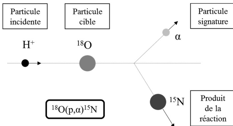
Figure 81 : Schéma de l'analyse par NRA de l'oxygène 18
