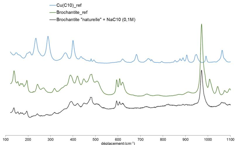
Figure 116 : Spectre  $\mu$ Raman du précipité formé après le mélange de brochantite « naturelle » et  $\text{NaC}_{10}$  (0,1M) ; spectres Raman de la brochantite et de  $\text{Cu}(\text{C}_{10})_2$
