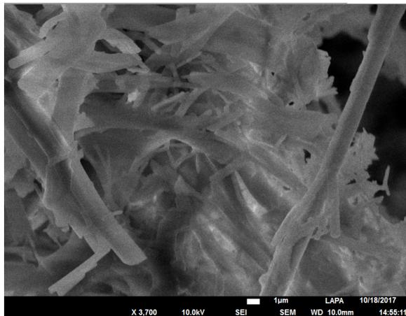
Figure 132 : Micrographie MEB en SE du  $\text{Cu}(\text{C}_{10})_2$  synthétisé
