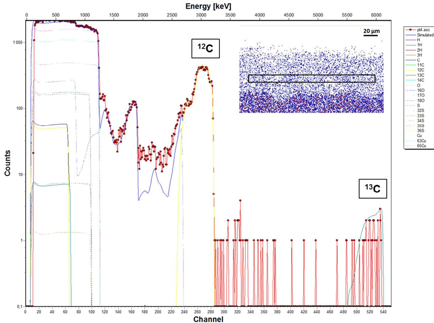
Figure XXIX : Spectre expérimental et spectre simulé acquis sur la zone 4 de la couche de corrosion de l'échantillon traité à l'acide décanoïque dopé au  $^{13}\text{C}$  appliqué par immersion pendant 2 heures (zone représentée par le rectangle sur la cartographie PIXE du cuivre) avec les contributions du cuivre, du carbone, de l'oxygène, du soufre, de l'hydrogène et de leurs isotopes naturels
