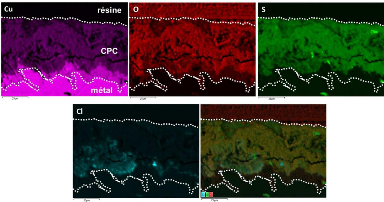
Figure 96 : Cartographies EDS du cuivre (raie  $K\alpha$ ), de l'oxygène (raie  $K\alpha$ ), du soufre (raie  $K\alpha$ ) et du chlore (raie  $K\alpha$ ), et cartographies superposées du soufre, de l'oxygène et du chlore de l'échantillon de Strasbourg
