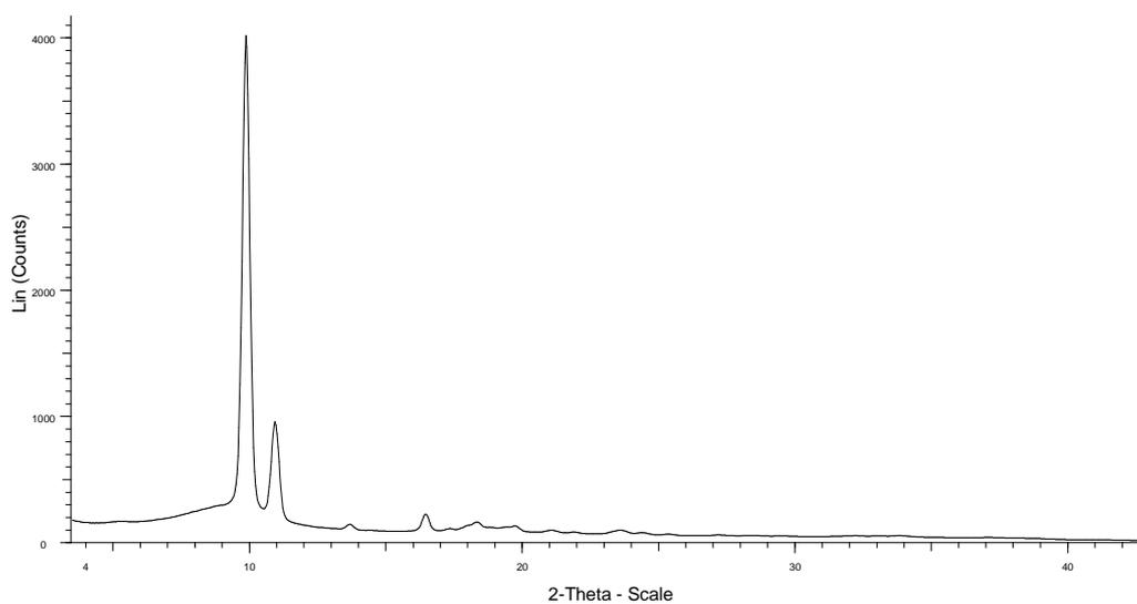
Figure 71 : Diffractogramme de la cire Cosmolloïd
