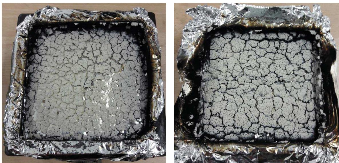
Figure 235 : Photographie de résidus après essai au cône calorimètre d'un composite chargé à 20% (gauche) et 30% (droite) de phénoplastes
