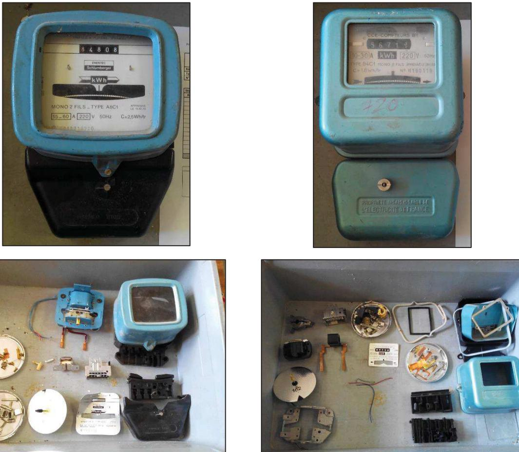
Figure 106 : Démantèlement d'un compteur à boîtier plastique (gauche) et métallique (droite)
