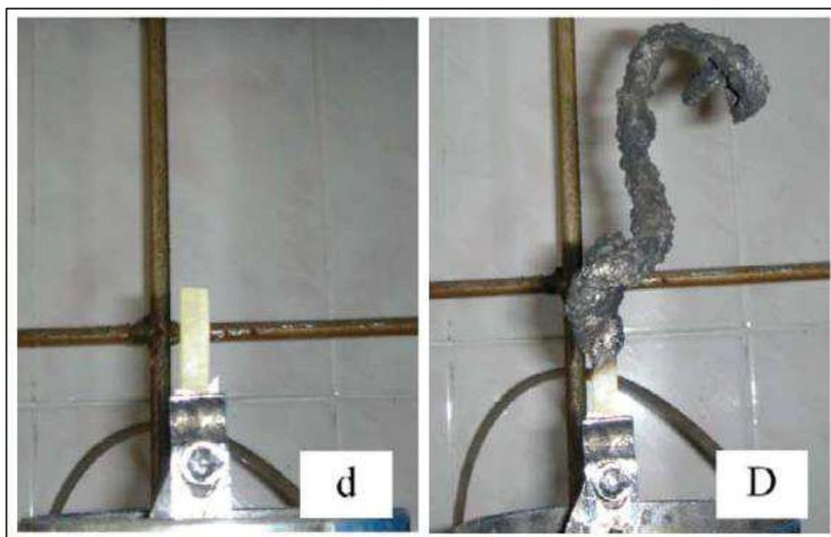
Figure 59 : Formation d'un char intumescent lors de la combustion d'un échantillon de TAEP/MAPM (ratio 2,8 :1,6) (A gauche : échantillon avant inflammation ; à droite : échantillon après combustion) [119]
