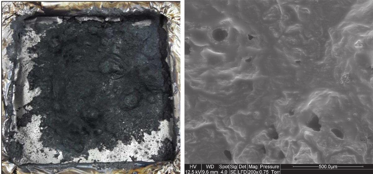
Figure 250 : Photographie (gauche) et image MEBE (droite) du résidu après essai au cône calorimètre d'un composite PP+30%APP
