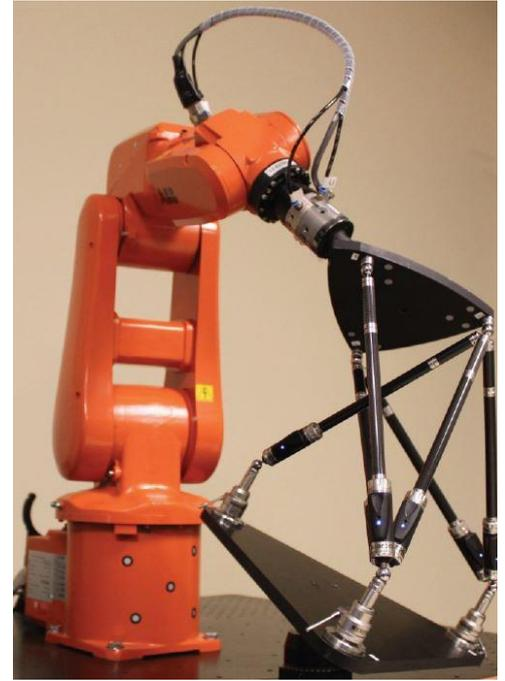
figure 134 : Calibration à l'aide du système BallBar
