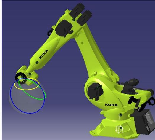
figure 135 : trajectoire à réaliser avec un BallBar
