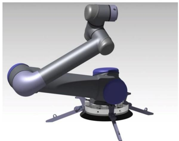
Figure 162 : principe d'accroche par ventouse du robot
