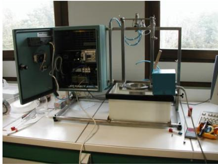
Figure 144 : Système d'extraction des arômes par bain marie
