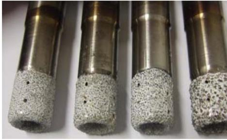
figure 64 :Outil avec différente granulométrie
