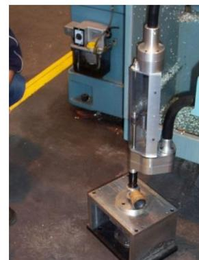
Figure 149 : UPA électrique en phase d'essais de perçage
