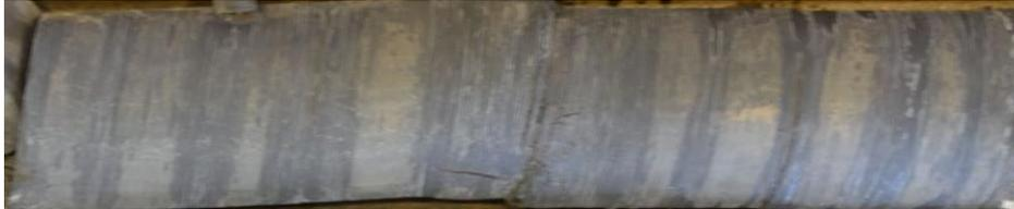
**Fig. VII.3: Forage BC 1 entre -48 m et -48.4 montrant une alternance entre des niveaux noirs (black shales) et des niveaux plus jaunâtres, riches en pyrite (riche en Fer; mesure niton) et probablement en hydrocarbures.**
