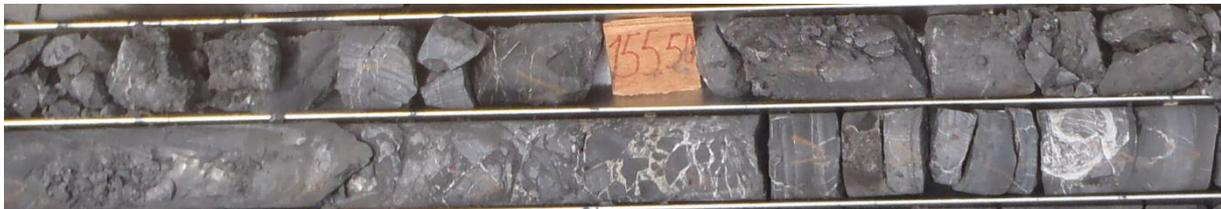
**Fig. VI.20:** Photo des brèches de faille et de gouge marquant la présence d'une faille post-sédimentaire dans le forage BA490 à -155m.
