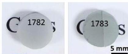
Figure 2.16 – *Echantillons frittés par SPS avec un préfrittage 700 °C.*
