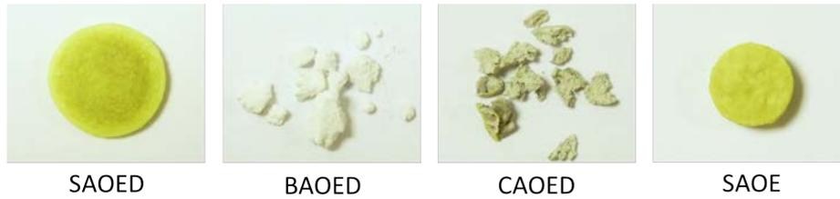
Figure 2.40 – Images des particules céramiques synthétisées par micro-onde :  $\text{SrAl}_2\text{O}_4$ : Eu, Dy (SAOED),  $\text{BaAl}_2\text{O}_4$ : Eu, Dy, (BAOED),  $\text{CaAl}_2\text{O}_4$ : Eu, Dy (CAOED) et  $\text{SrAl}_2\text{O}_4$ : Eu (SAOE).
