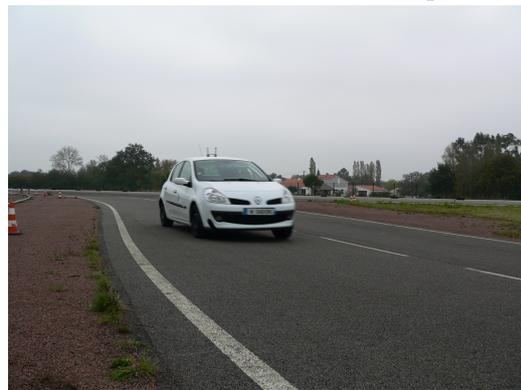
(d) manœuvre 4 : vitesse 80 km/h et coup de volant
