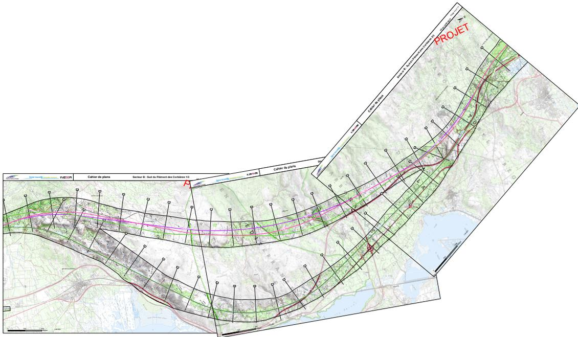
FIG. 2.17 – Les deux tracés possibles : au dessus une ligne dédiée au transport des passagers, au dessous une ligne mixte permettant le transport des passagers et du fret
