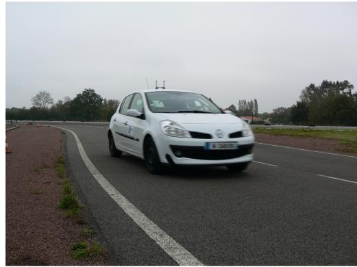
(b) manœuvre 2 : vitesse 60 km/h et coup de volant
