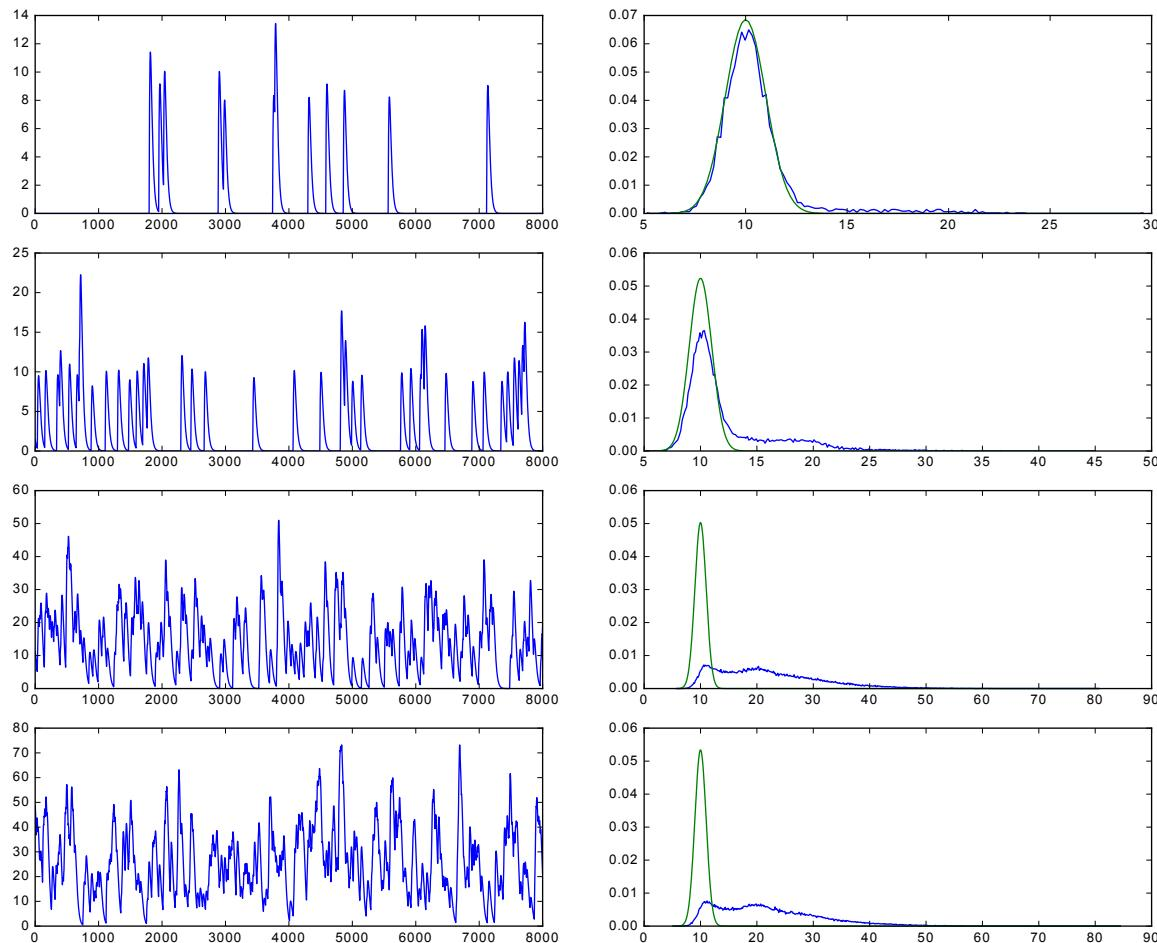
**Figure 1.14 :** Trajectoires de processus shot-noise  $(\lambda, f, h)$  simulées pour  $\lambda \in \{0.2, 1, 5, 10\}$  de même densité des marques  $f$  et réponse impulsionnelle  $h$  (à gauche, de haut en bas). A droite, histogramme des maxima locaux correspondants pour des échantillons de taille  $n = 5.10^6$
