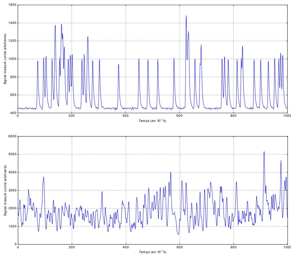
**Figure 1.13 :** Trajectoires de deux processus shot-noise enregistrés en spectrométrie  $\gamma$  dont la source est composée d'Americium 241 et de Plutonium 238. Les intensités varient et sont respectivement du haut vers le bas de  $5.10^5$  et  $4.10^6$  coups par seconde
