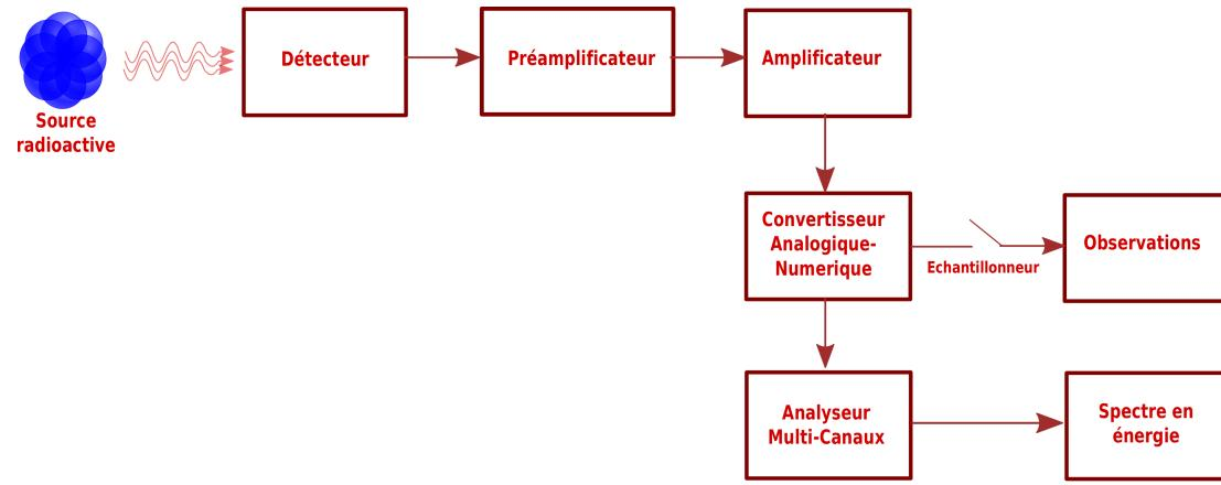
Figure 1.8 : Schéma d'une chaîne d'acquisition utilisée en spectrométrie
