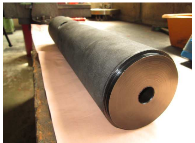
(b) Bloc de combustible en PE de 480 mm de longueur et de 20 mm de diamètre du canal central
