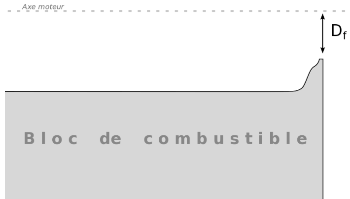
FIGURE 6.20 – Schéma de principe de l'excédant de combustible à la fin du canal dans certains essais.
