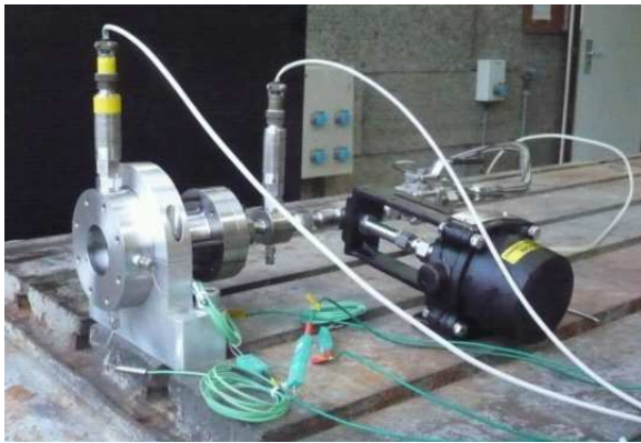
(a) Catalyseur seul sur le banc d'essai
