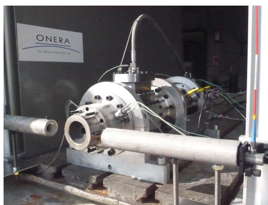
FIGURE 8.1 – Moteur HYCOM instrumenté avec un spectromètre.
