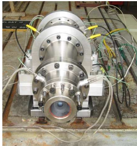
FIGURE 3.1 – Moteur HYCOM monté sur un banc d’essai.
