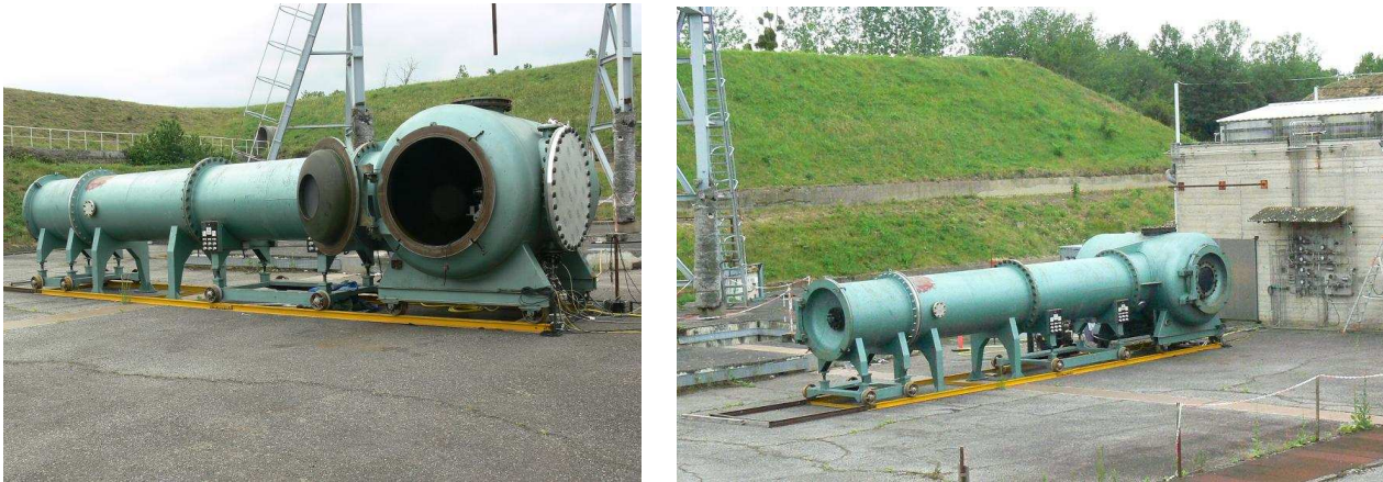
FIGURE 4.1 – Caisson d'essai à basse pression de l'ONERA.
