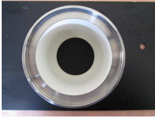
FIGURE 3.6 – Post-chambre de combustion du moteur HYCOM.
