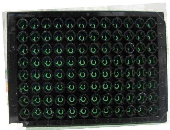
Figure IV-1. Microplaque 96 puits avec présence d'électrodes au fond de chaque puits.
