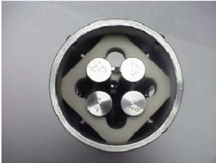
**Figure 3.9:** Photographie d'un quadrupôle vu de face.
