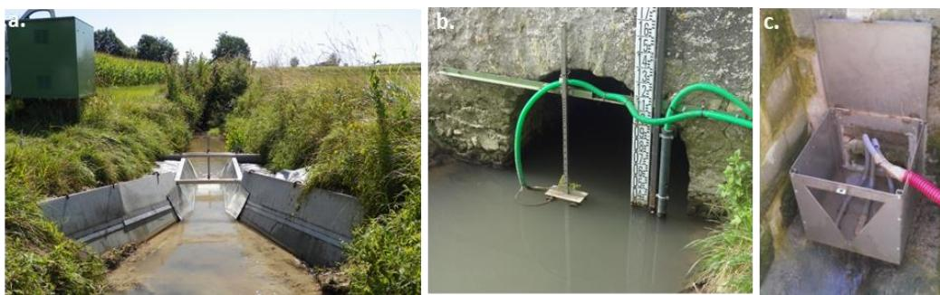
Figure 2.11. Photographies de trois stations d'échantillonnage : station avec canal Venturi (Les Masniers) (a), station installée sur un pont (Grand Braye) (b) et station installée sur un collecteur de drain (Brépinière) (c) (Photographies, A. Foucher).
