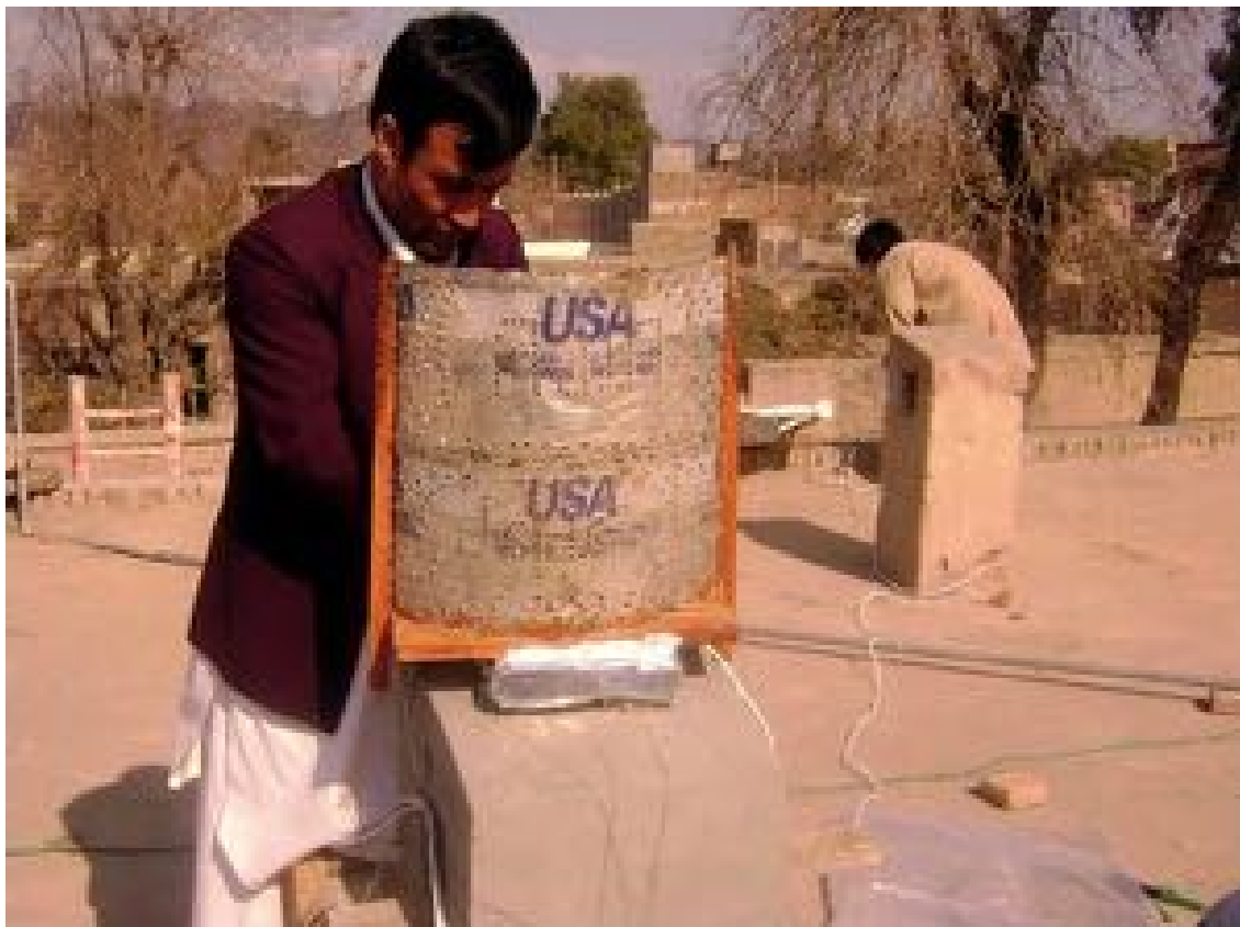
Figure 2 - Photo illustrative de l’article du New York Times « U.S. Underwrites Internet Detour Around Censors » publié (en ligne) le 12 juin 2011. Légende : “Afghans from Fab Lab worked to install a FabFi wireless mesh radio with parts from a recycled oil canister”. Crédit : Hameed Tasal/Fab Folk - 2011.
