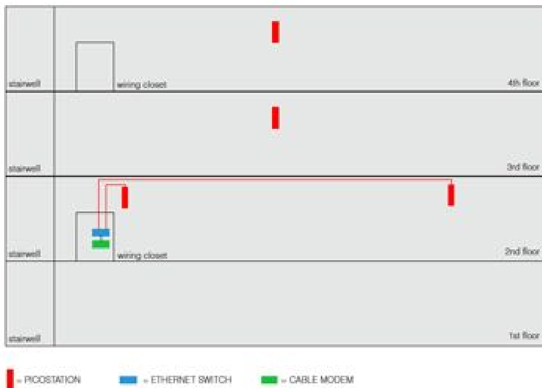
Figure 16 — Emplacement des picostations dans le BAL (2 e version). Crédits : Peña Gangadharan / Ford Foundation – 2012.
