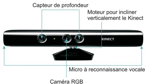
FIGURE 3.4 – Le capteur Kinect pour windows.
