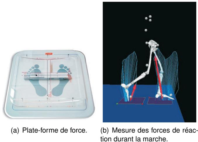
FIGURE 2.3 – Plate-forme de force et mesure des forces de réaction durant la marche.
