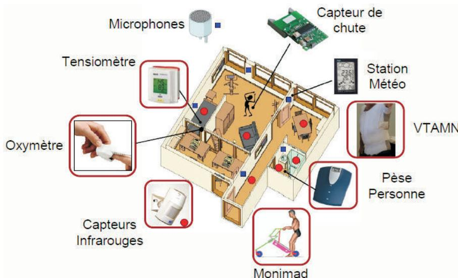
FIGURE 1.6 – Les capteurs utilisés dans le projet AILISA.
