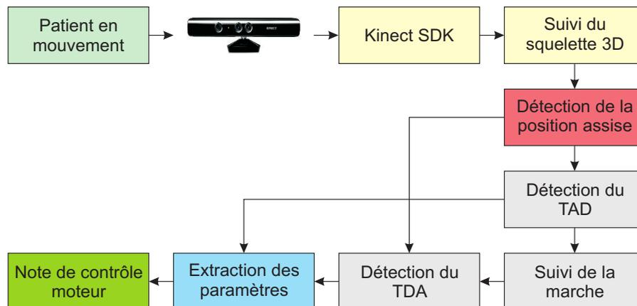
FIGURE 3.7 – Schéma fonctionnel de notre système global.
