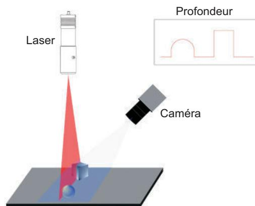
FIGURE 3.3 – Principe des caméras à lumière structurée.
