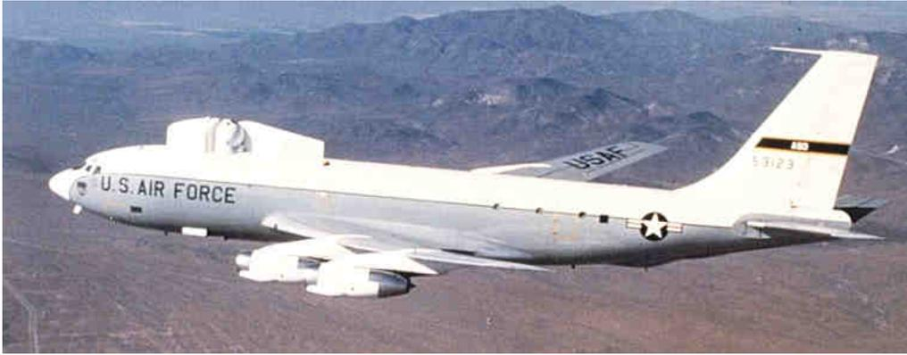
Figure 3 : L'Airborne Laser Lab (ALL) embarqué sur NKC-135A, l'ancêtre de l'ABL utilisant un laser CO<sub>2</sub> de la classe 500 kW.
