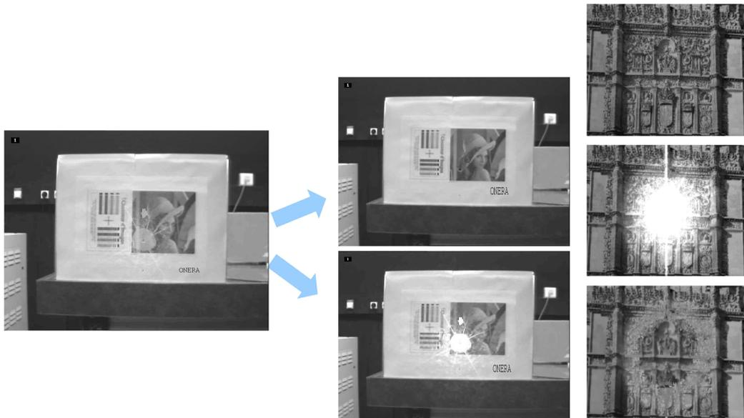
Figure 35 : A gauche, extraction de la trame non éblouie d'une image de caméra CCD bas coût éblouie par laser à basse cadence (10 Hz). A droite, restauration d'une image éblouie dans une séquence vidéo par diffusion 3D (extrait de [48]). Dans les deux cas, on observe qu'une séquence vidéo dont toutes les trames et images ne sont pas éblouies reste exploitable, moyennant un traitement d'image approprié.
