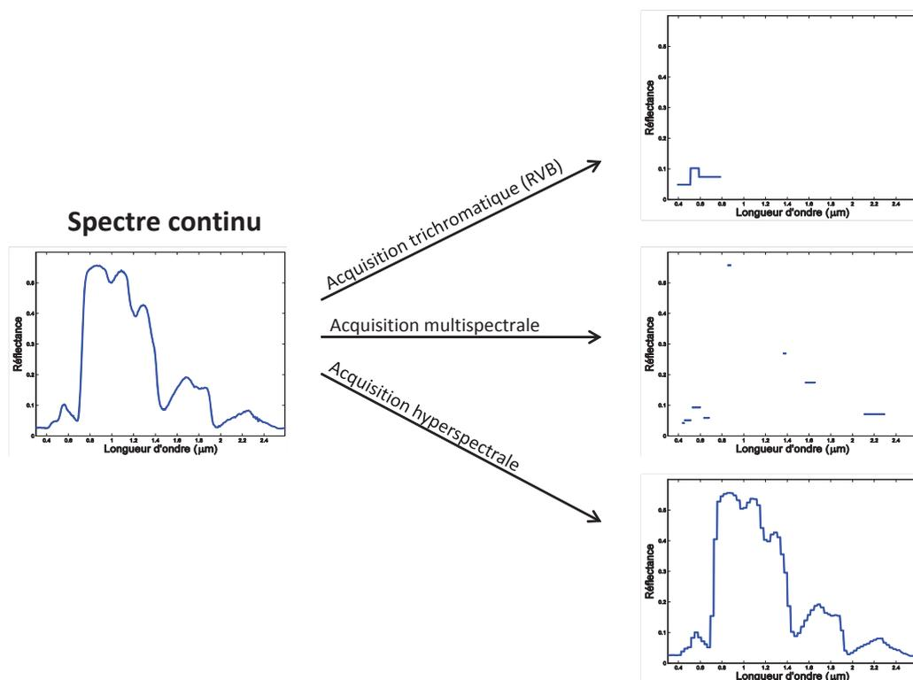
FIGURE 1.2 – Différents modes d'acquisition d'un spectre lumineux : trichromatique, multispectral et hyperspectral.
