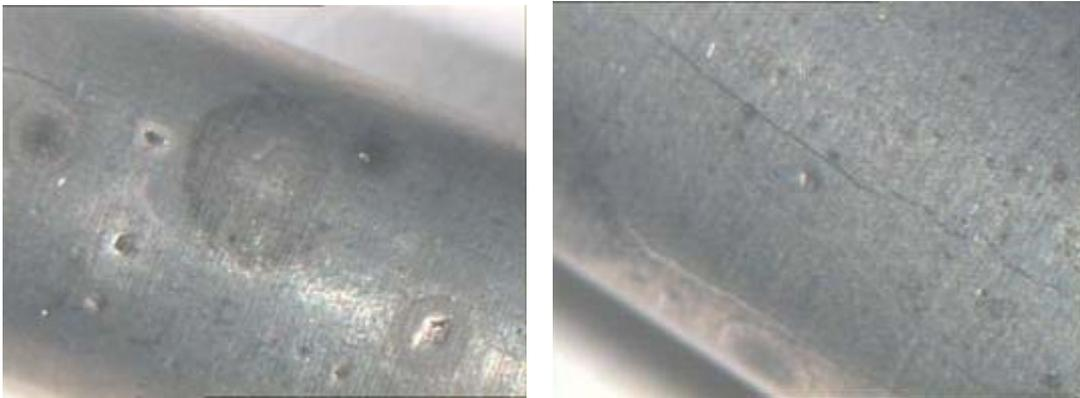
**Figure 2.15** : Observations à la binoculaire de bulles et de fissures.
