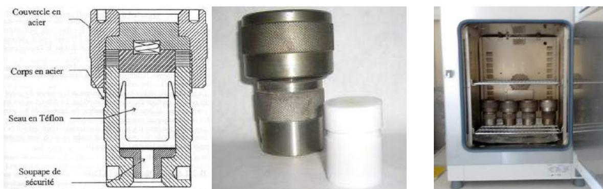
Figure 1 : Autoclave Parr (gauche) et four Heratherm OMH60 (droite).
