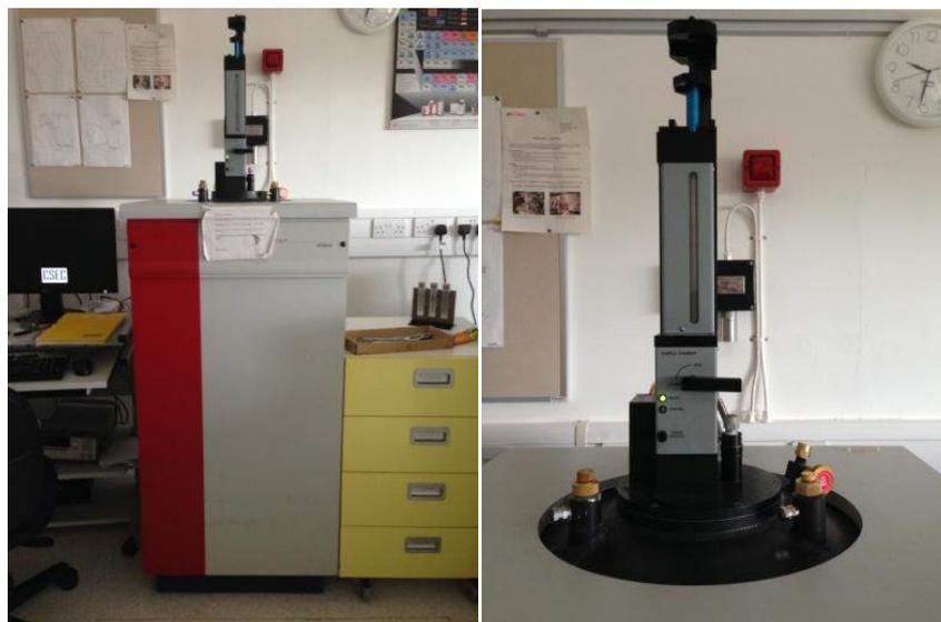
Figure 11 : Magnétomètre SQUID Quantum Design MPMS (gauche); chambre d'introduction de l'échantillon (droite).
