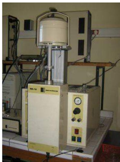
Figure 13 : Schéma et photo d'une ATG de type Setaram TG-DTA 92.
