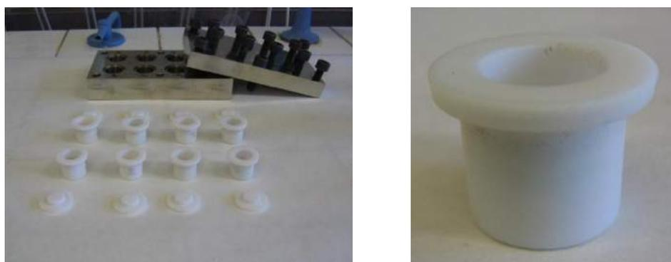
Figure 2 : Système de micro-autoclaves et réacteur de 2 mL.
