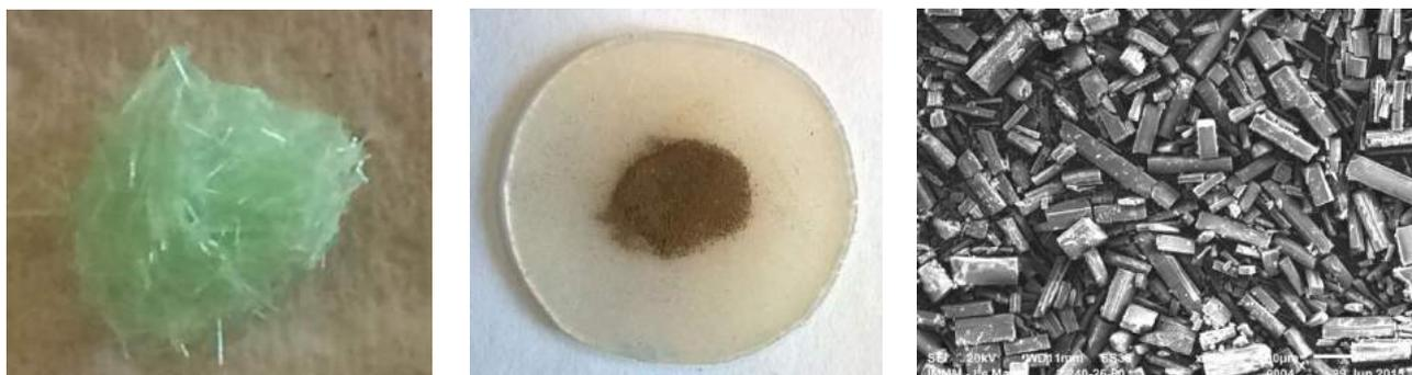
Figure 6 : Photographies avant (gauche) et après vieillissement à l'air (centre) et cliché MEB de  $[Hdma] \cdot (Fe^{II}F(bdt))$  (13a) (droite).
