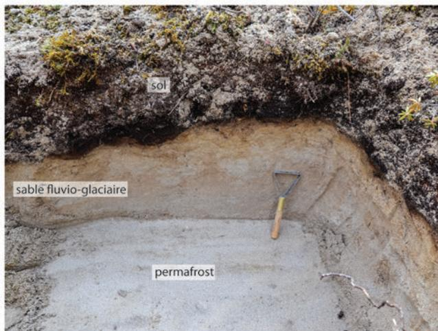
Figure 124 : Exemple d'une tranchée d'échantillonnage au site DEN2. Sous une couche de sol de ~ 30 cm, on trouve une couche de sable de ~ 30 cm avant d'atteindre le permafrost.
