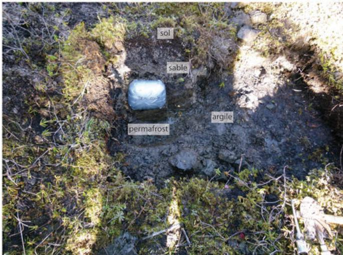
Figure 122 Tranchée d'échantillonnage du site LOWP4. Sous une couche de ~ 20 cm de sol, on trouve une couche de sable de ~ 20 cm puis une couche d'argile prise dans le permafrost.
