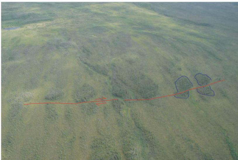
**Figure 72 : Trace de la faille de Denali et monticules décalés utilisés pour l'estimation du taux de glissement au Sud de Denali (Seitz et al., 2008).**
