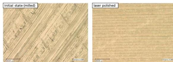
Figure 2.12: topographie initiale fraisée (gauche) et topographie finale polie par laser (droite) selon les paramètres optimaux déterminés expérimentalement
