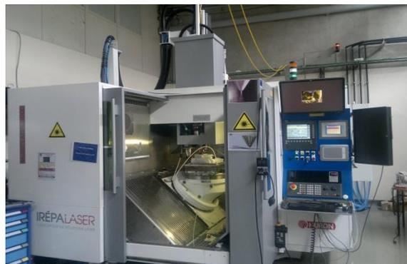
Figure 4.1: machine hybride utilisée lors des expérimentations de polissage et de fabrication additive
