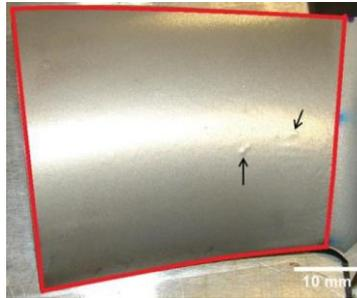
Figure 2.46: pale de turbine polie par laser
