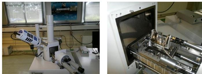
Figure 4.6: Microscope à Balayage Electronique (MEB)
