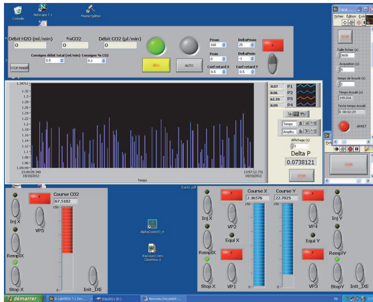
Figure 5.3. Interface du programme de pilotage, Labview : la partie basse indique les positions des trois pompes ; au niveau de la partie haute, on a la zone de consigne concernant le débit Q et la zone de contrôle automatique du système ; et au centre, nous avons un cadran indiquant les graphes de pressions.
