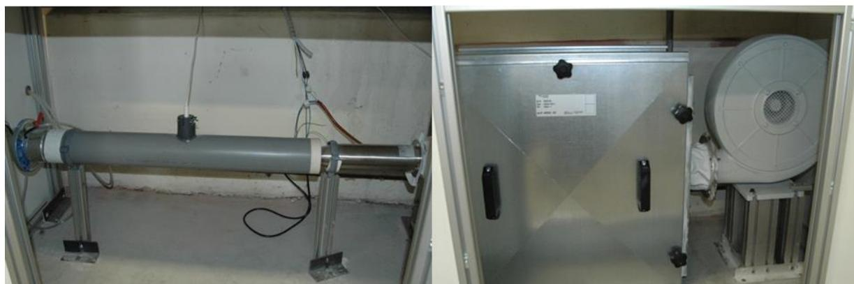
*Figure II-31 : Ventilateur, caisson de filtration amont, réchauffeur, capteur de température et diaphragme*
