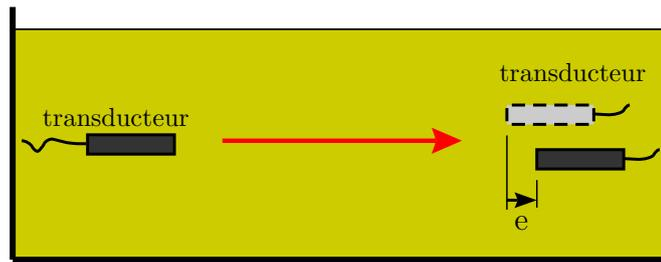
FIGURE 2.19 – Schéma du dispositif expérimental pour la mesure dans l'huile de ricin. Le transducteur récepteur est déplacé d'une distance  $e$  pour créer un matériau de même épaisseur.
