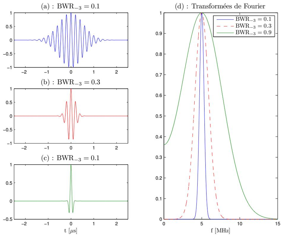
FIGURE B.1 – Exemples de formes d’onde gaussiennes pour trois valeurs de  $\text{BWR}_p$  (a-b-c) avec  $p = -3$  et transformées de Fourier normalisées correspondantes (d). Paramètres :  $A = 1$ ,  $t_0 = 0 \mu\text{s}$ ,  $f_0 = 5 \text{ MHz}$ ,  $\phi = 0$ .
