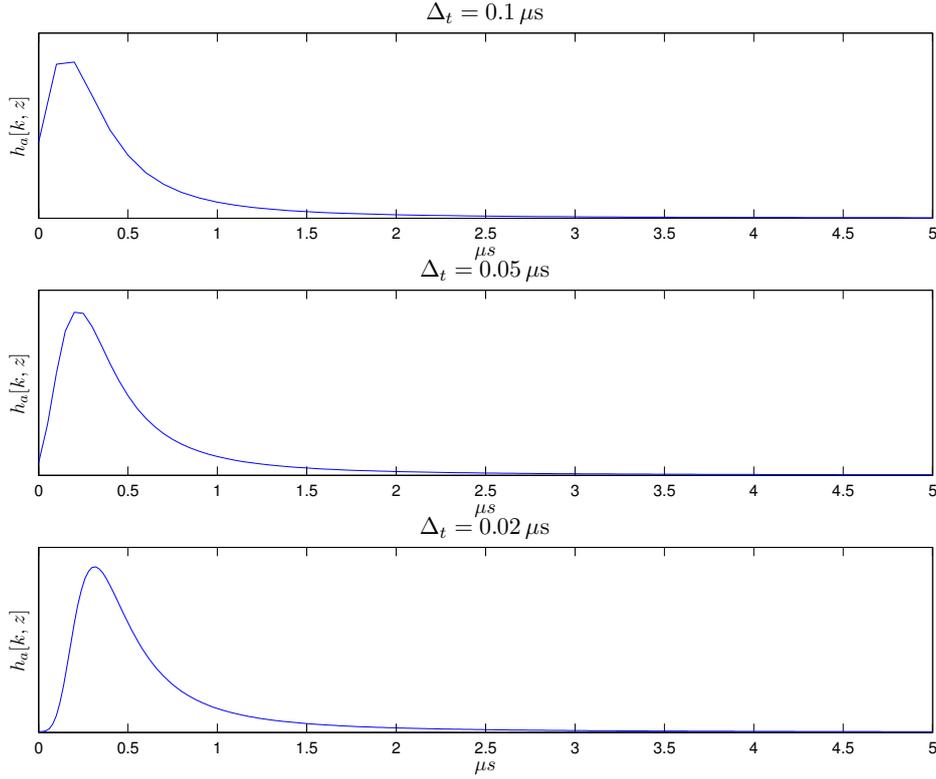
FIGURE 2.10 – Etude de l'influence de  $\Delta_t$  dans le calcul des réponses impulsionnelles  $h_a(z)$  obtenues par transformée de Fourier discrète inverse de  $H_a(f, z)$ . Paramètres :  $\gamma = 1$ ,  $\alpha_0 = 50 \text{ Np.MHz}^{-1}.\text{m}^{-1}$ ,  $z = 20 \text{ mm}$ ,  $N_f = 256$ ,  $\Delta_t = 0.1 \mu\text{s}$ ,  $0.05 \mu\text{s}$ ,  $0.02 \mu\text{s}$ .
