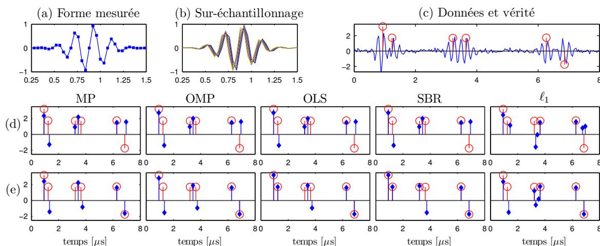
FIGURE 4.7 – Exemple de déconvolution de données synthétiques. (a) : Forme d’onde initiale, (b) : formes d’onde utilisées pour la déconvolution  $K = 6$ , (c) : données (–) et vrais pics ( $\circ$ ), ligne (d) : résultats avec  $K = 1$ , ligne (e) : résultats avec  $K = 6$ . Vrais pics ( $\circ$ ) et pics estimés ( $\blacklozenge$ ).
