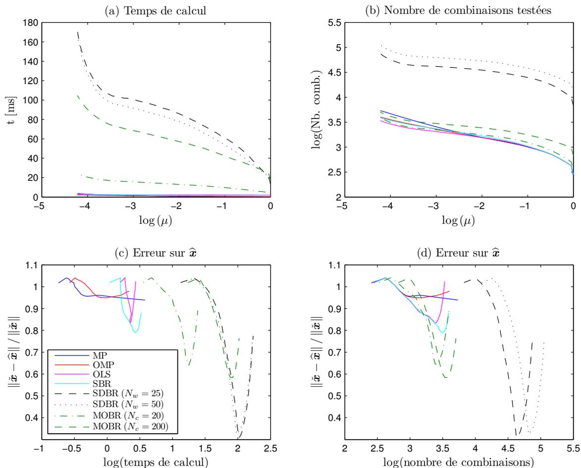
FIGURE 3.14 – Résultats des temps de calcul et du nombre de combinaisons testées issus de simulations de Monte-Carlo pour chaque algorithme. (a) : Temps de calcul est fonction de  $\mu$ , (b) : nombre de combinaisons testées en fonction de  $\mu$ , (c) : Erreur sur  $\hat{x}$  en fonction du temps de calcul, (d) : erreur sur  $\hat{x}$  en fonction du nombre de combinaisons testées.
