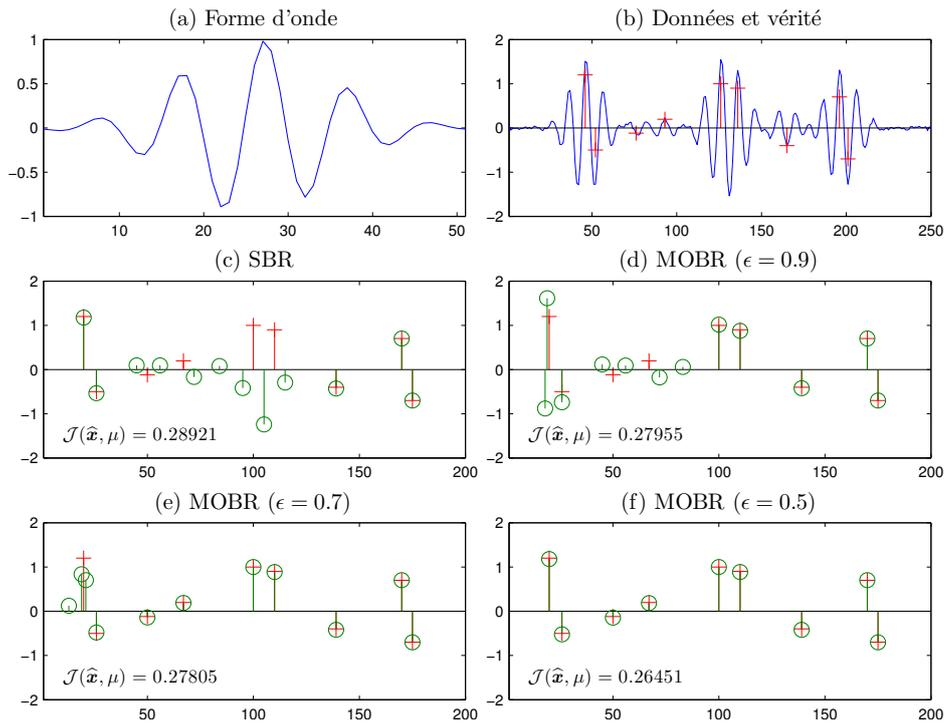
FIGURE 3.12 – Déconvolution par régularisation  $\ell_0$ . (a) : Réponse impulsionnelle instrumentale avec  $f_0 = 5$  MHz,  $BWR_{-3} = 0.3$ ,  $\phi = -\pi/4$ , (b) : données avec  $RSB = 25$  dB (–) et vérité (+), (c) : vérité (+) et estimation par SBR (○), (d) vérité (+) et estimation par MOBR pour  $\epsilon = 0.9$  (○), (e) : vérité (+) et estimation par MOBR pour  $\epsilon = 0.7$  (○), (f) : vérité (+) et estimation par MOBR pour  $\epsilon = 0.5$  (○).
