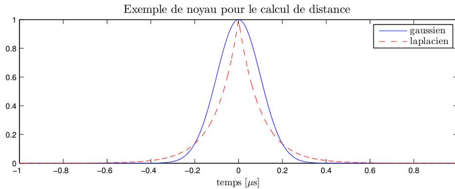
FIGURE 4.5 – Exemple de noyaux gaussien et laplacien pour le calcul de distance ( $\tau = \sigma = 0.1 \mu s$ ).
