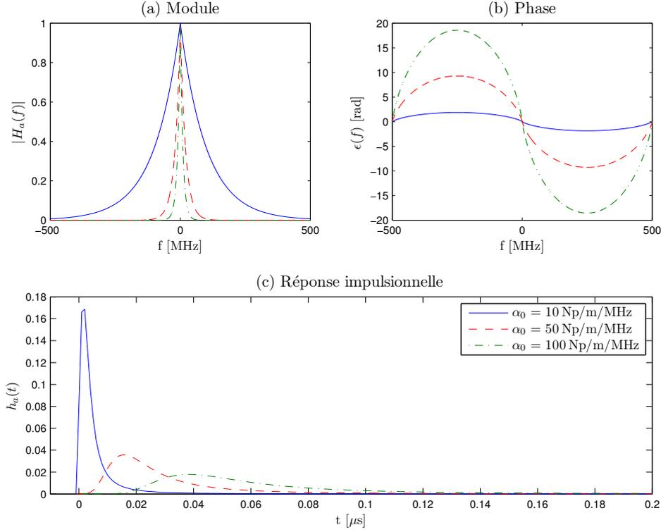
FIGURE 2.6 – Exemples de modèles à atténuation linéaire et phase dispersive pour plusieurs valeurs du coefficient d'atténuation  $\alpha_0 = 10, 50, 100 \text{ Np.MHz}^{-1}.\text{m}^{-1}$  et pour une distance de propagation  $z = 1 \text{ mm}$ . (a) : Modules  $|H_a(f, z)| = e^{-\alpha_0|f|z}$ , (b) : phases  $\epsilon(f)$ , (c) : réponses impulsionnelles  $h_a(t, z)$  obtenues par transformée de Fourier inverse de  $H_a(f, z) = e^{-\alpha_0|f|z} e^{-\epsilon(f)z}$ .
