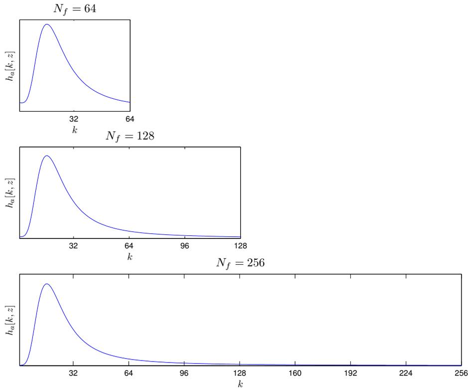
FIGURE 2.11 – Etude de l’influence de  $N_f$  dans le calcul des réponses impulsionnelles  $h_a(z)$  obtenues par transformée de Fourier discrète inverse de  $H_a(f, z)$ . Paramètres :  $\gamma = 1$ ,  $\alpha_0 = 50 \text{ Np.MHz}^{-1}.\text{m}^{-1}$ ,  $z = 20 \text{ mm}$ ,  $f_S = 50 \text{ MHz}$ ,  $N_f = 64, 128, 256$ .
