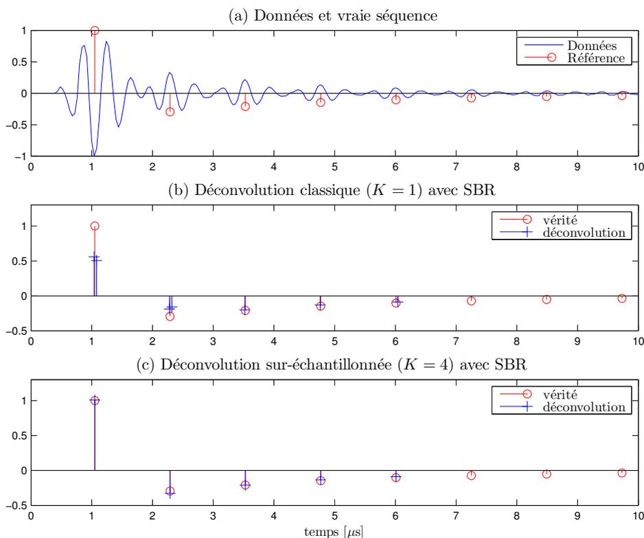
FIGURE 4.10 – Déconvolution classique ( $K = 1$ ) et sur-échantillonnée ( $K = 4$ ) pour des données acquises à partir d’une plaque d’aluminium de 4 mm d’épaisseur. (a) données et vraie séquence, (b) vraie séquence et déconvolution classique, (c) vraie séquence et déconvolution sur-échantillonnée.
