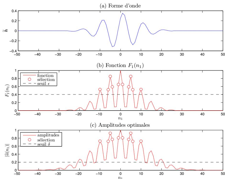
FIGURE 3.9 – Exemple de FACM pour  $K = 1$  avec  $\epsilon = 0.4$  and  $\delta = 0.2$ . (a) : Forme d’onde de référence  $\hat{h}$ , (b) : fonction  $F_1(n_1)$  (—), seuil  $\epsilon$  (- -) et sélection  $F_1(n_1) \geq \epsilon$  ( $\circ$ ), (c) : amplitudes optimales  $\hat{a}(n_1)$ , seuil  $\delta$  (- -) et sélection ( $\circ$ ).
