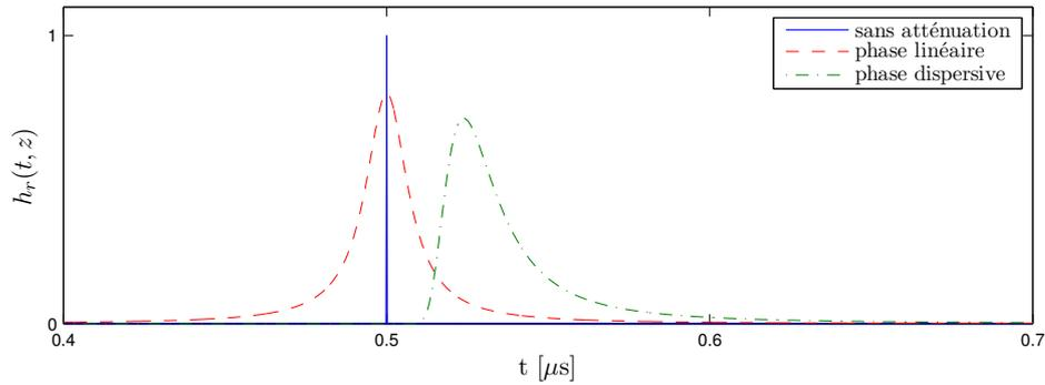
FIGURE 2.7 – Réponses impulsionnelles simulées  $h_r(t, z)$  en utilisant trois modèles : sans atténuation, avec atténuation et phase linéaires, et avec atténuation linéaire et phase dispersive. Paramètres :  $c_0 = c_\infty = 2000 \text{ m.s}^{-1}$ ,  $\gamma = 1$ ,  $\alpha_0 = 50 \text{ Np.MHz}^{-1}.\text{m}^{-1}$ ,  $z = 1 \text{ mm}$  et  $b(z) = 1$ . Le temps de vol minimal est  $t_0 = z/c_\infty = 0.5 \mu\text{s}$ .
