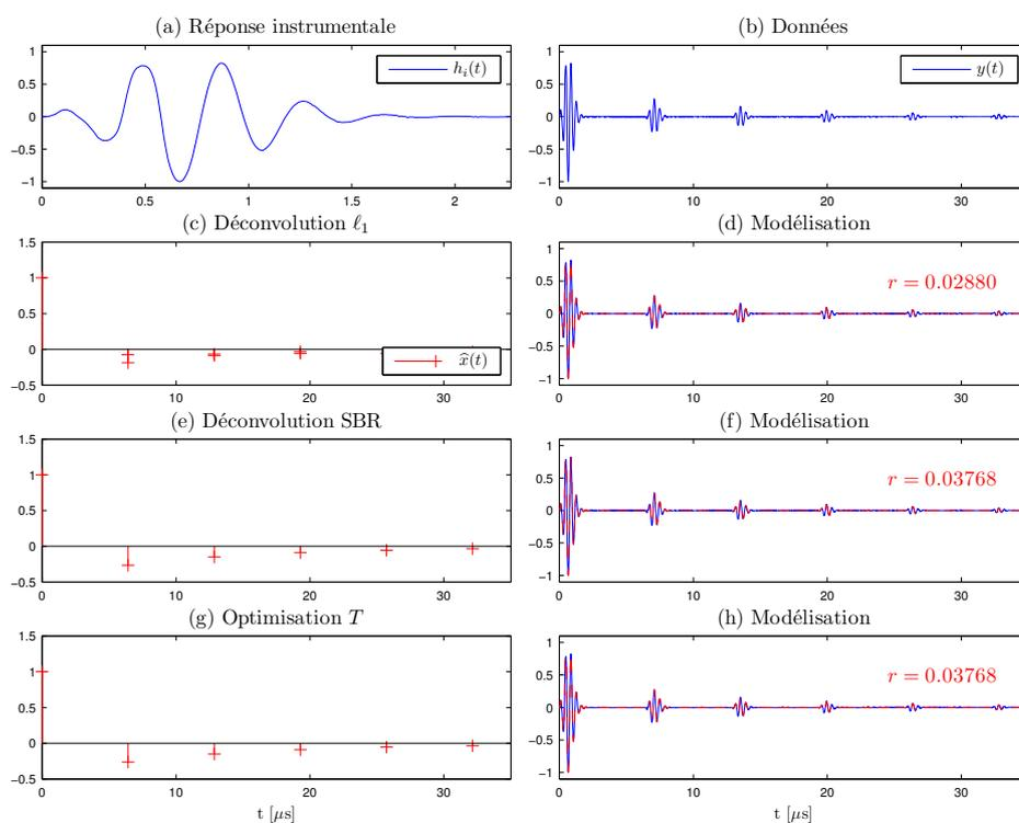
FIGURE 5.4 – Déconvolution pour l'END d'une plaque d'aluminium de 20.5 mm d'épaisseur. (a) réponse instrumentale, (b) données, (c) déconvolution par pénalisation  $\ell_1$  et (d) adéquation aux données, (e) déconvolution par SBR et (f) adéquation aux données, (g) optimisation  $T$  et (h) adéquation aux données.
