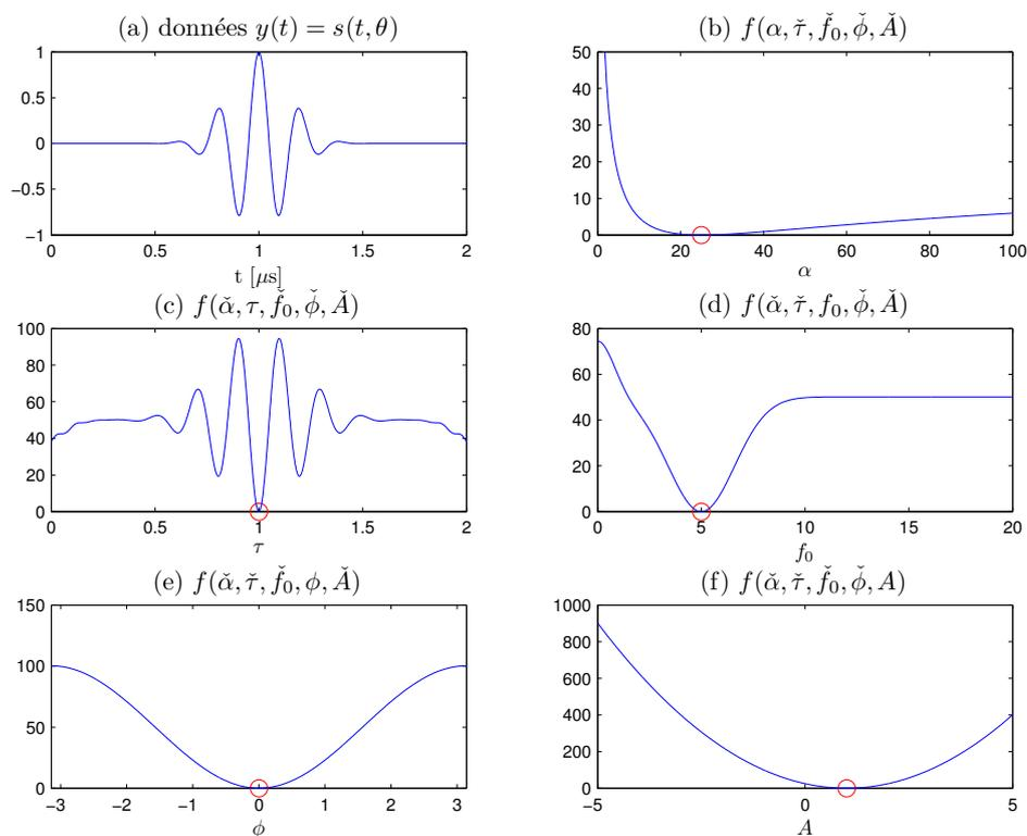
FIGURE 3.1 – Étude de la fonction (3.4) à minimiser par rapport à chaque paramètre (les autres paramètres sont fixés à leur vraie valeur), pour un modèle d'écho gaussien. (a) : Données, (b) :  $f$  en fonction de  $\alpha$ , (c) :  $f$  en fonction de  $\tau$ , (d) :  $f$  en fonction de  $f_0$ , (e) :  $f$  en fonction de  $\phi$ , (f) :  $f$  en fonction de  $A$ . La valeur minimale de la fonction est nulle et les vraies valeurs des paramètres sont représentées par des cercles.
