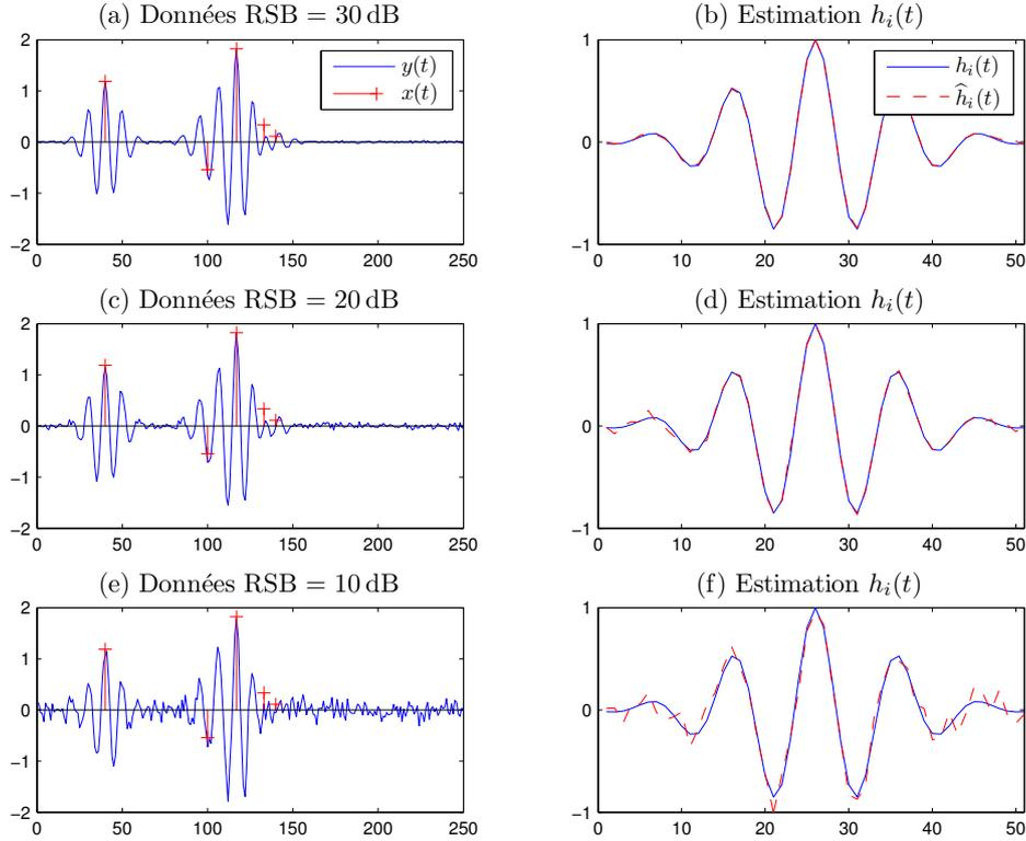
FIGURE 5.1 – Exemple d'estimation de la réponse instrumentale par connaissance de  $x(t)$  pour trois niveaux de bruit. Colonne de gauche : Données  $y(t)$  (–) et séquence  $x(t)$  (+), colonne de droite : vérité  $h_i(t)$  et estimation  $\hat{h}_i(t)$ . Haut : RSB = 30 dB, milieu : RSB = 20 dB, bas : RSB = 10 dB.
