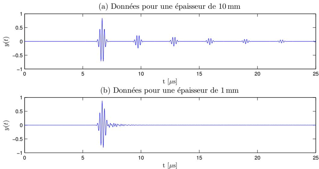
FIGURE 1.6 – Exemple de A-scan simulé correspondant à la figure 1.5 avec (a)  $d = 10 \text{ mm}$  et (b)  $d = 1 \text{ mm}$ . Le matériau 1 est l'eau ( $c_1 = 1500 \text{ m.s}^{-1}$ ,  $\rho_1 = 1000 \text{ kg.m}^{-3}$ ) et le matériau 2 est l'aluminium ( $c_2 = 6500 \text{ m.s}^{-1}$ ,  $\rho_2 = 2660 \text{ kg.m}^{-3}$ ).
