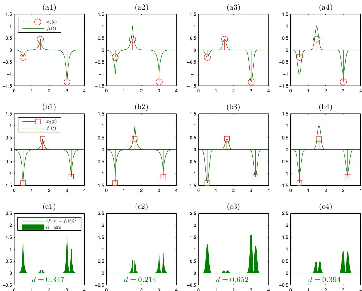
FIGURE 4.6 – Exemple de calcul de distance entre trains d’impulsions. Les lettres indiquent (a) le train  $x_1(t)$  et la fonction  $f_1(t)$  associée, (b) le train  $x_2(t)$  et la fonction  $f_2(t)$  associée et (c) la distance euclidienne. Les indices correspondent à (1) amplitudes inchangées et noyau laplacien, (2) amplitudes binarisées et noyau laplacien, (3) amplitudes inchangées et noyau gaussien et (4) amplitudes binarisées et noyau gaussien.
