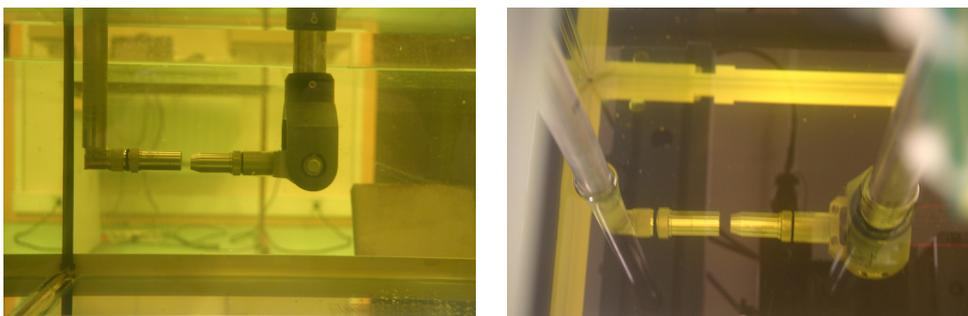
FIGURE 2.18 – Photos de l'expérimentation dans l'huile de ricin. Les transducteurs sont immergés dans l'huile et positionnés face à face pour réaliser une mesure en transmission.
