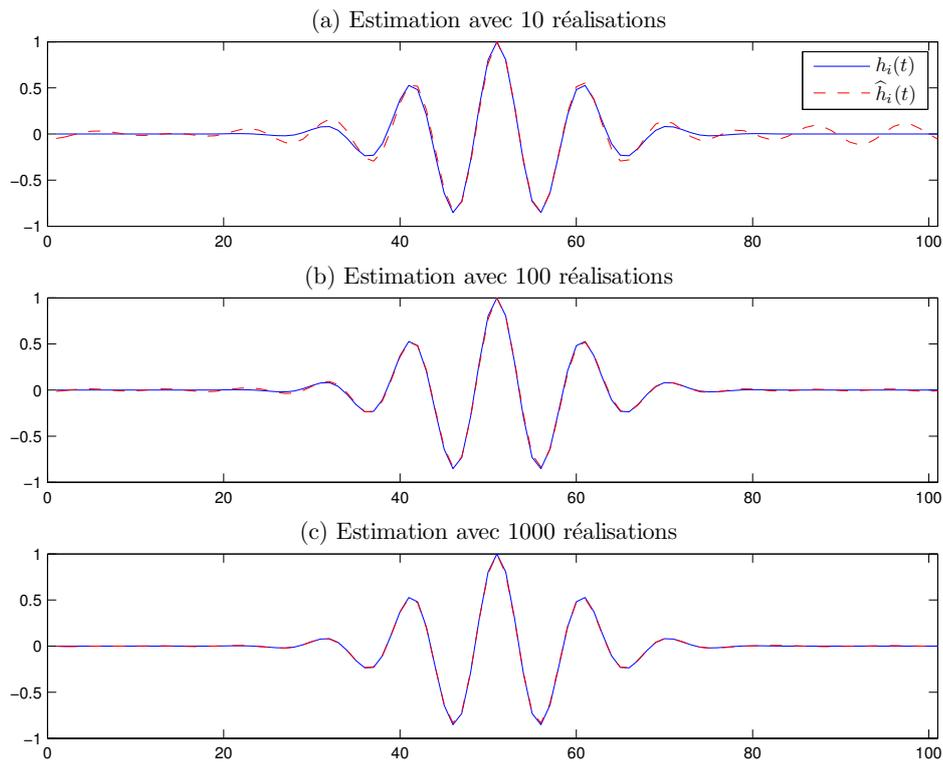
FIGURE 5.2 – Exemple d’estimation de la réponse instrumentale par moyennage dans le domaine homomorphique. (a) : vérité  $h_i(t)$  et estimation  $\hat{h}_i(t)$  pour 10 réalisations, (b) : vérité  $h_i(t)$  et estimation  $\hat{h}_i(t)$  pour 100 réalisations, (c) : vérité  $h_i(t)$  et estimation  $\hat{h}_i(t)$  pour 1000 réalisations.
