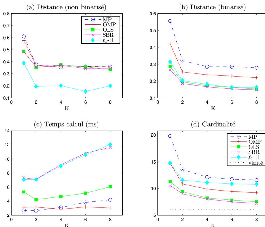
FIGURE 4.8 – Résultats de simulations de Monte-Carlo pour cinq méthodes de déconvolution en fonction du facteur de sur-échantillonnage  $K$ . (a) distance basée sur un noyau laplacien, (b) distance basée sur un noyau laplacien avec amplitudes binaires, (c) temps de calcul, (d) cardinalité.
