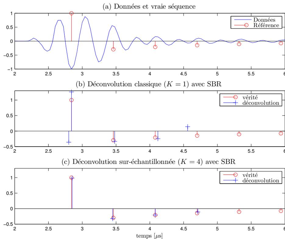
FIGURE 4.11 – Déconvolution classique ( $K = 1$ ) et sur-échantillonnée ( $K = 4$ ) pour des données acquises à partir d'une plaque d'aluminium de 2 mm d'épaisseur. (a) données et vraie séquence, (b) vraie séquence et déconvolution classique, (c) vraie séquence et déconvolution sur-échantillonnée.
