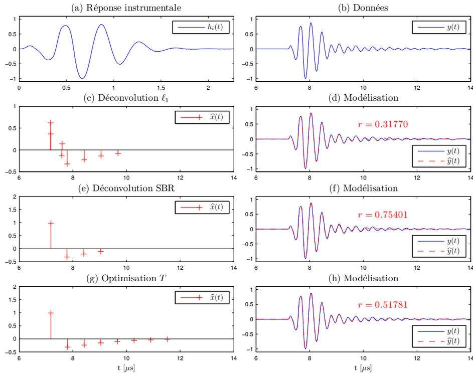
FIGURE 5.5 – Déconvolution pour le CND d’une plaque d’aluminium de 2 mm d’épaisseur. (a) réponse instrumentale, (b) données, (c) déconvolution par pénalisation  $\ell_1$  et (d) adéquation aux données, (e) déconvolution par SBR et (f) adéquation aux données, (g) optimisation  $T$  et (h) adéquation aux données.
