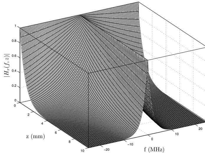
FIGURE 2.3 – Exemple de fonction d'atténuation  $|H_r(f, z)|$  en fonction de la fréquence et de la distance de propagation. L'atténuation est linéaire, telle que  $|H_r(f, z)| = e^{-\alpha_0|f|z}$ , avec  $\alpha_0 = 50 \text{ Np.MHz}^{-1}.\text{m}^{-1}$ .
