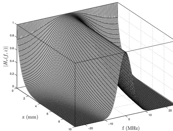
FIGURE 2.13 – Exemple de fonction d’atténuation  $|H_r(f, z)|$  en fonction de la fréquence et de la distance de propagation. Le noyau d’Olofsson (2.64) est défini avec  $a = 0.06$  pour générer le modèle d’atténuation (2.62).
