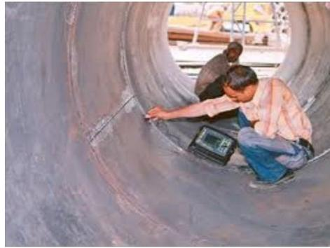
FIGURE 1.1 – Contrôle d'un tube de grand diamètre par ultrasons. La sonde ultrasonore est placée directement en contact avec la pièce par l'opérateur pour l'inspecter (source : IRC Advanced NDT Services, [www.indiamart.com](http://www.indiamart.com)).
