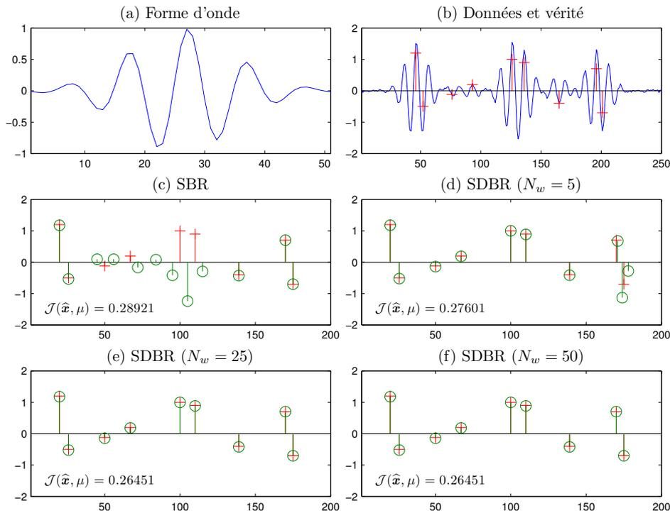
FIGURE 3.8 – Déconvolution par régularisation  $\ell_0$ . (a) : Réponse impulsionnelle instrumentale avec  $f_0 = 5$  MHz,  $\text{BWR}_{-3} = 0.3$ ,  $\phi = -\pi/4$ , (b) : données avec  $\text{RSB} = 25$  dB (–) et vérité (+), (c) : vérité (+) et estimation par SBR (o), (d) vérité (+) et estimation par SDBR (o), (e) : vérité (+) et estimation par SDBR (o), (f) : vérité (+) et estimation par SDBR (o).
