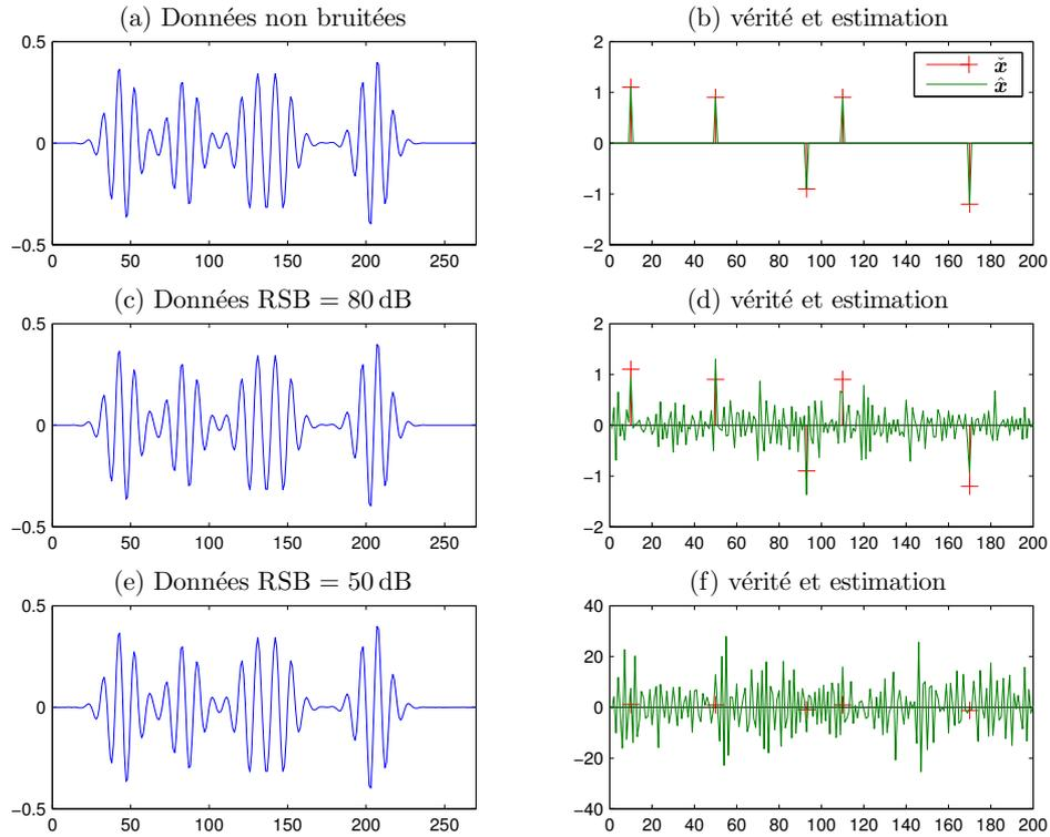
FIGURE 3.3 – Déconvolution par une approche d'inverse généralisée. (a) : Données non bruitées, (b) : vérité (+) et estimation (-), (c) : données avec RSB = 80 dB, (d) : vérité (+) et estimation (-), (e) : données avec RSB = 50 dB, (f) : vérité (+) et estimation (-).
