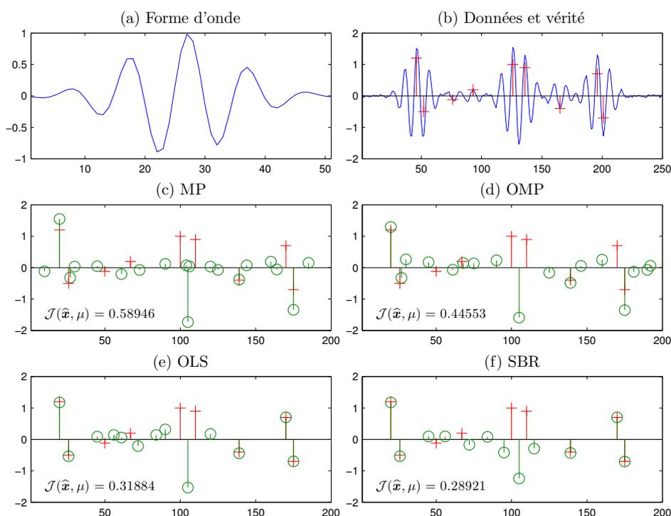
FIGURE 3.6 – Déconvolution par régularisation  $\ell_0$ . (a) : Réponse impulsionnelle instrumentale avec  $f_0 = 5$  MHz,  $BWR_{-3} = 0.3$ ,  $\phi = -\pi/4$ , (b) : données avec  $RSB = 25$  dB (–) et vérité (+), (c) : vérité (+) et estimation par MP (○), (d) vérité (+) et estimation par OMP (○), (e) : vérité (+) et estimation par OLS (○), (f) : vérité (+) et estimation par SBR (○).
