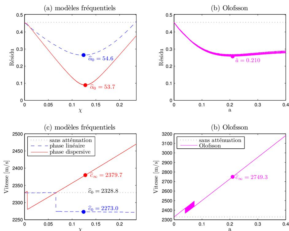
FIGURE 2.25 – Evaluation non destructive d’une plaque de polycarbonate. (a) : Résidu (2.76) en fonction de  $\chi$  (modèles fréquentiels), (b) : résidu en fonction de  $a$  (modèle d’Olofsson), (c) : vitesse en fonction de  $\chi$ , (d) : vitesse en fonction de  $a$ . Les valeurs minimales de résidu (●) permettent l’estimation des coefficients d’atténuation ( $\hat{\alpha}_0$  ou  $\hat{a}$ ) et des vitesses ( $\hat{c}_0$  ou  $\hat{c}_\infty$ ).
