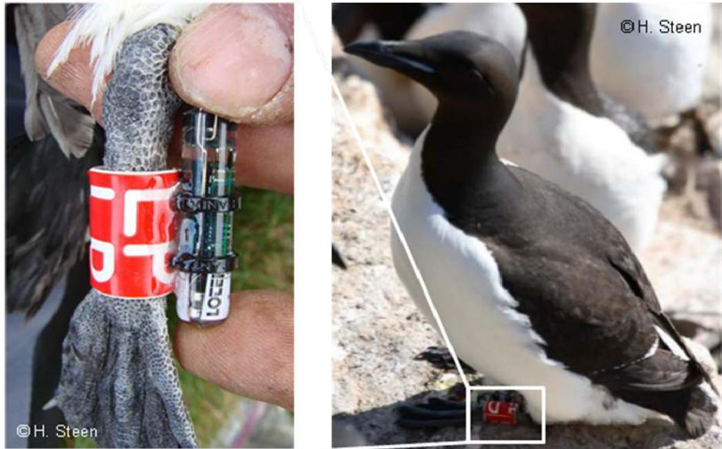
**Fig. 2.5** Exemple d'un enregistreur TDR de pression et température (LTD 2400; Lotek Wireless, St. Johns, NF, Canada) attaché sur la bague d'un guillemot de Brünnich.
