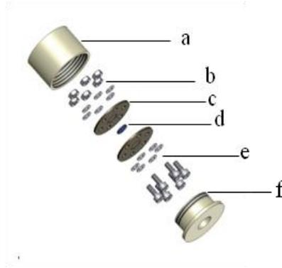
**Figure II.15 :** Schéma de la cellule EXAFS utilisée pour les mesures en transmission à haute température (jusqu'à 1500 °C). a : cylindre en BN – b : écrous et rondelles en acier – c : plaque en PBN (trouée pour introduire la pastille) – d : pastille (sels + poudre BN) – e : rondelles et vis – f : bouchon à vis du cylindre en BN <sup>[36]</sup>
