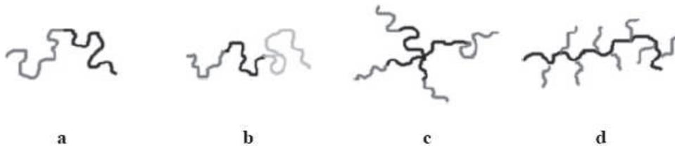
**Figure I-15.** Différentes architectures de bloc copolymères : a) copolymère dibloc, b) copolymère tribloc, c) étoile, d) brosse.
