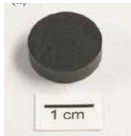
**Figure I-32.** Céramique Si/B/C/N dense (après pyrolyse)<sup>218</sup>.
