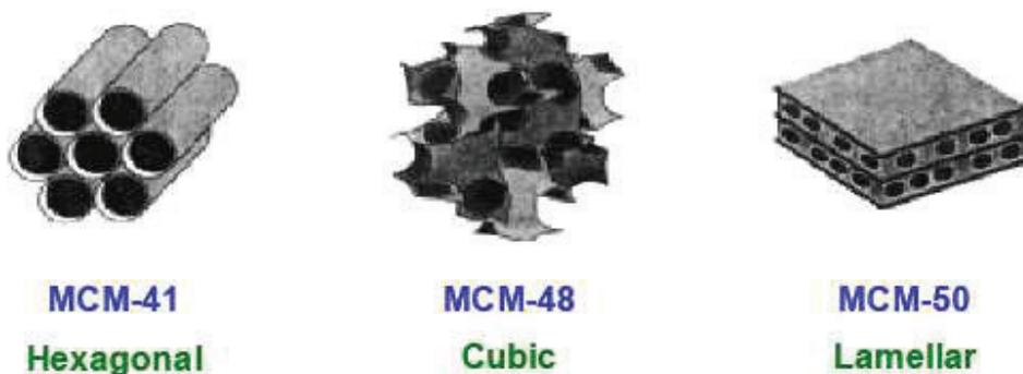
Figure I-3. Silices mésoporeuses ordonnées avec différents ordres de symétries de pores<sup>17,18</sup>.
