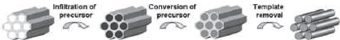
Figure I-11. Schéma illustrant la voie du nanomoulage<sup>126</sup>.
