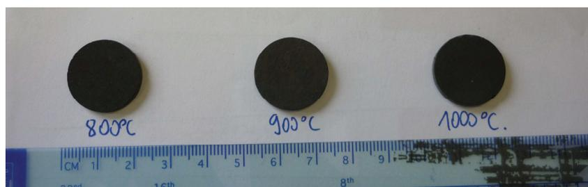
**Figure II-36.** Cliché numérique des pièces élaborées à 800 °C, 900 °C et 1000 °C.
