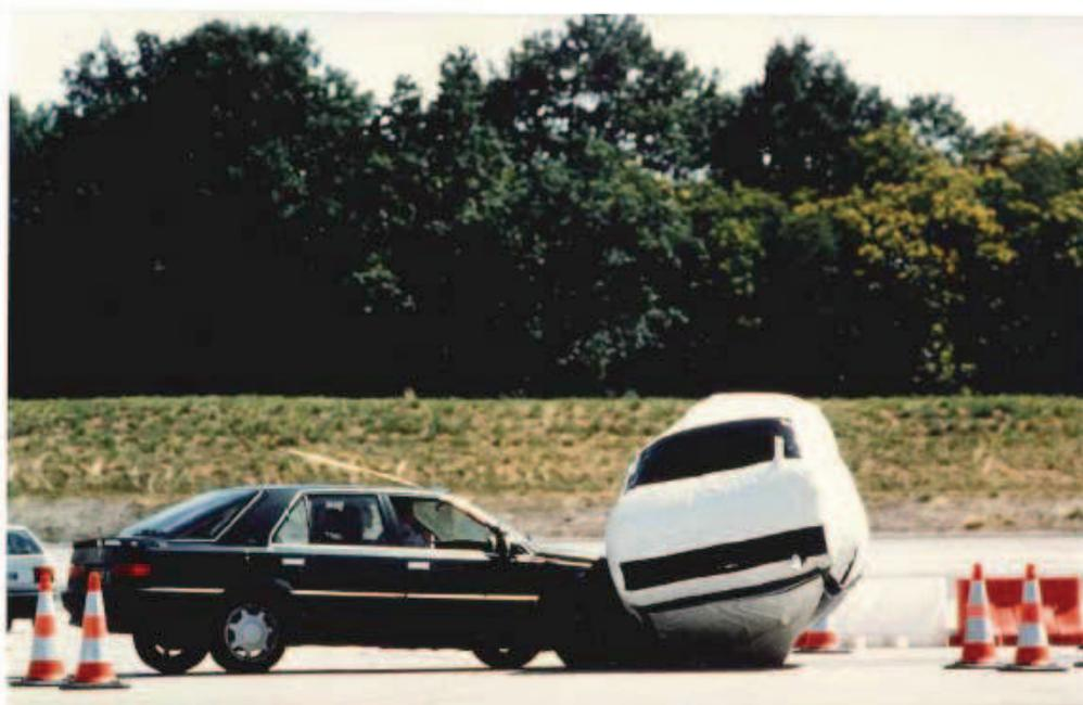
*Figure 32 : exemple de mauvaise manœuvre : le conducteur de la voiture d'essais a peu freiné et n'a pas essayé d'éviter l'obstacle.*
