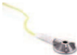
*Figure n°11a : Electrode utilisée pour enregistrer le signal électrodermal.*
