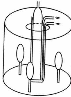
Figure II.2 : Dispositif d'irradiation à 365 nm
