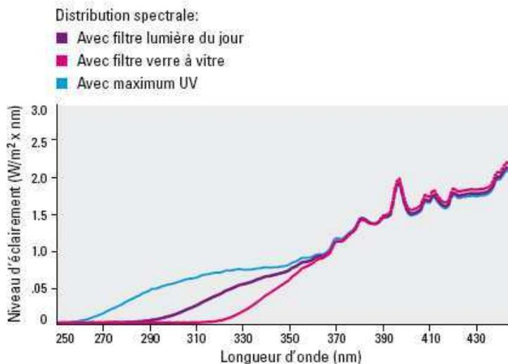
Figure II.5 : Spectre d'émission du Suntest donnée par le constructeur Atlas-MST
