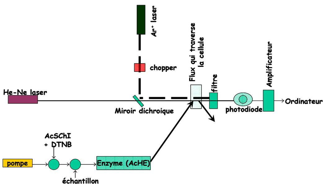
Figure II.19 : Dispositif expérimental avec détection TLS
