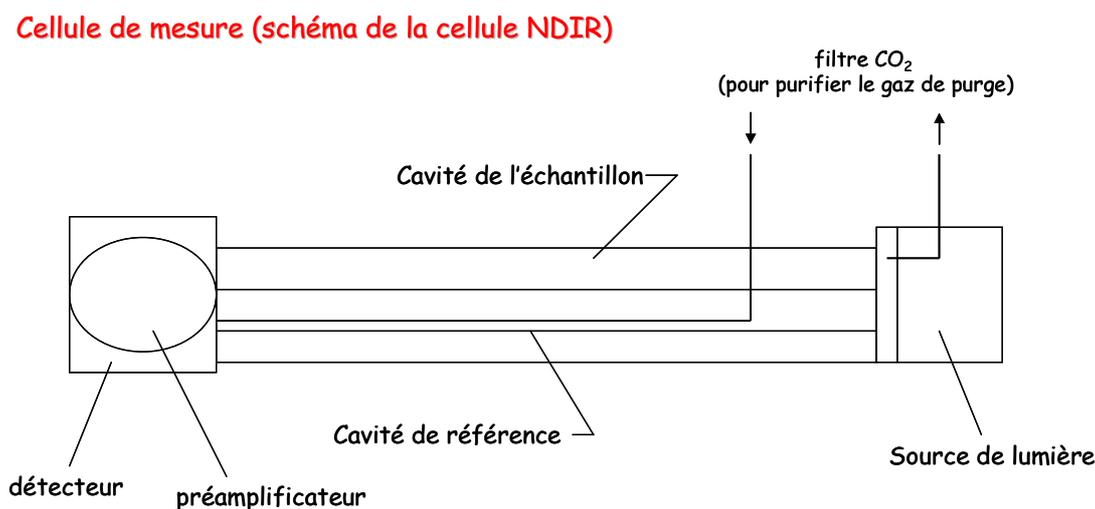
*Figure II.9 : Schéma de la cellule de mesure (NDIR)*
