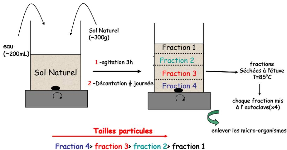
Figure II.1 : Schéma de fractionnement du sol naturel
