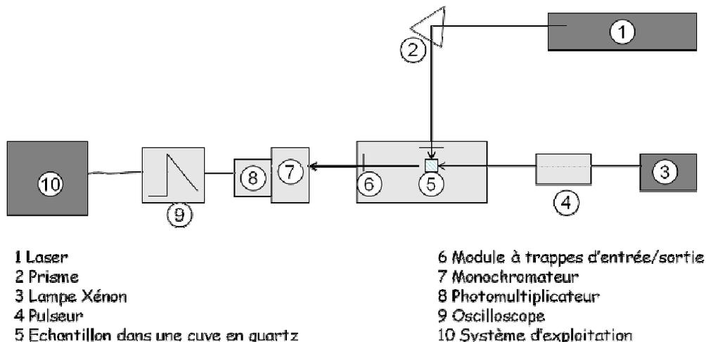
*Figure II.7 : Schéma de principe de l'appareillage de la spectroscopie laser nanoseconde*
