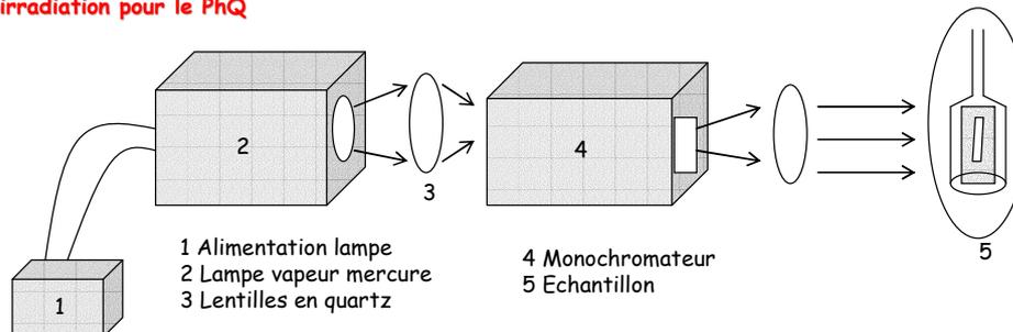
**Figure II.13 : Dispositif d'irradiation pour la phénylbenzoquinone**
