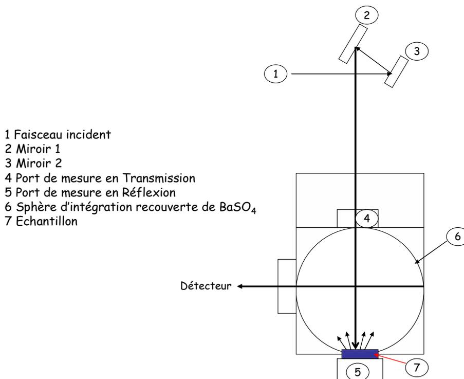
*Figure II.6 : Dispositif de montage de la sphère d'intégration*
