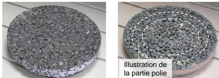
Figure 43. Echantillons pour essais Wehner Schulze : gauche) chaussée ; droite) granulats
