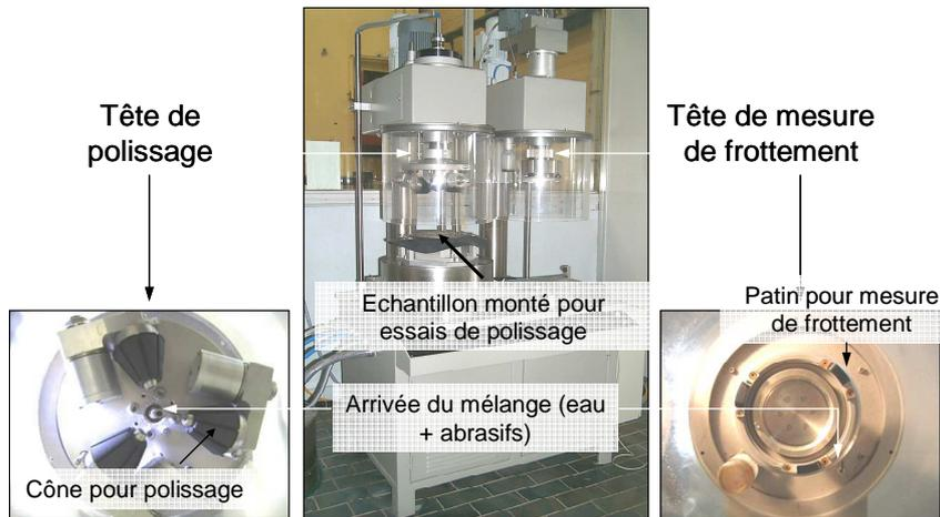
Figure 42. Machine d'essais de Wehner et Schulze
