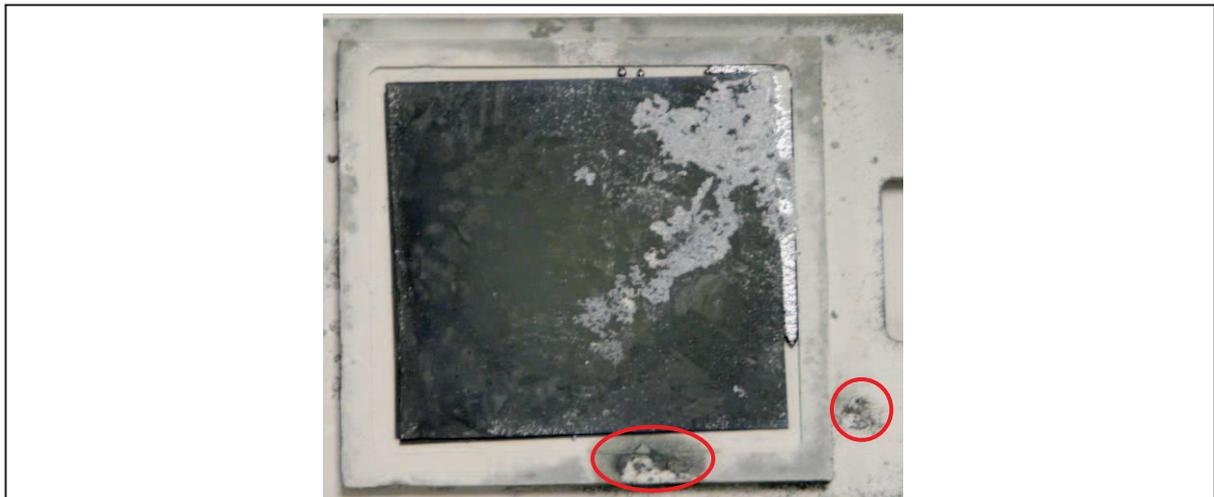
Figure 5.22 : Vue de dessus de la plaque de Si à la sortie du four (dimensions 70 × 70 mm<sup>2</sup>). Les ronds rouges montrent la désoxydation locale du revêtement
