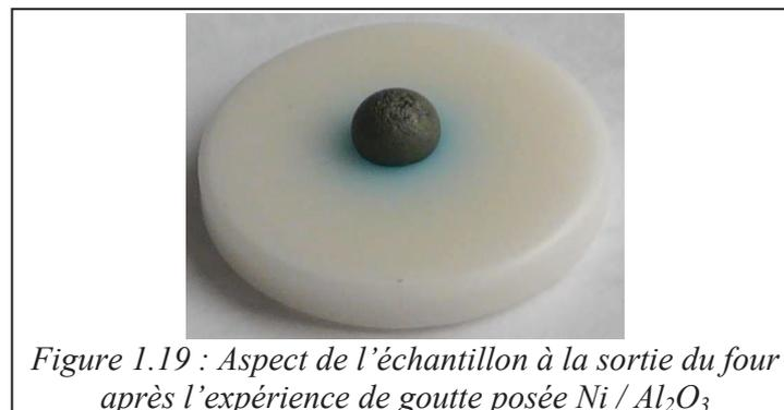
Figure 1.19 : Aspect de l'échantillon à la sortie du four après l'expérience de goutte posée Ni / Al<sub>2</sub>O<sub>3</sub>
