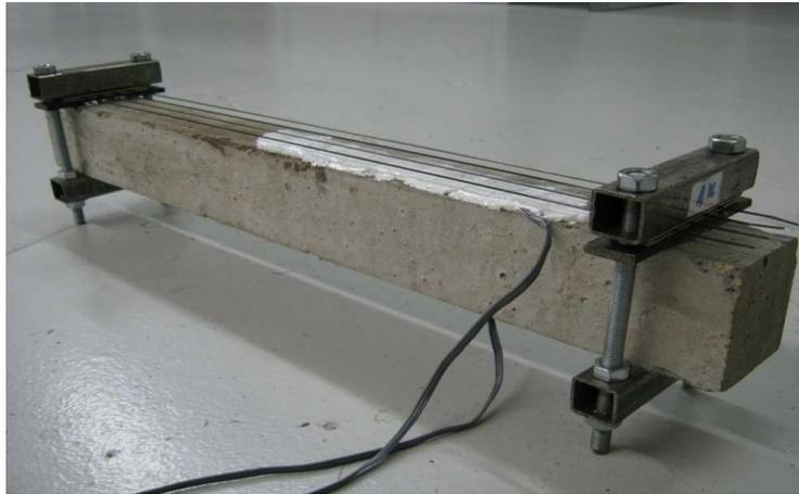
Figure II.20. Vue d'une poutrelle en béton équipée de quatre fils en AMF.
