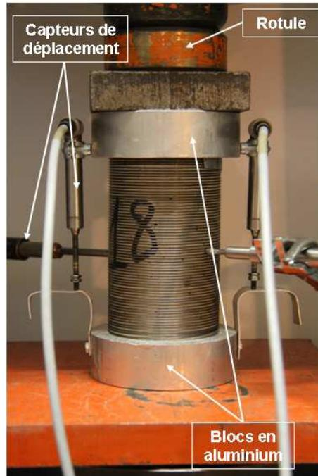
Figure II.36. Vue du cylindre en béton en cours d'essai avec les capteurs de déplacement.
