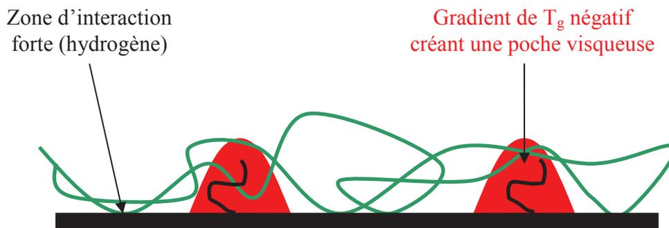
Schéma II.16 : Schématisation de la surface d'une silice greffée C8TES dans un élastomère renforcé, schématisation d'une poche visqueuse
