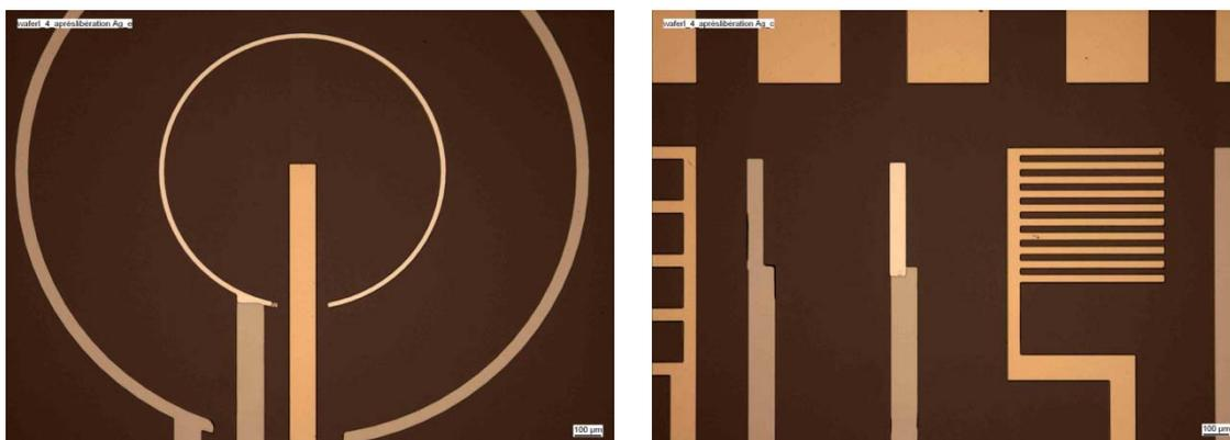
Figure III-5 : Photographies de structures trois microélectrodes réalisées avec une procédure bi-couche (LOR+AZ1529).
