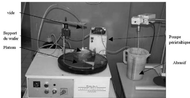
FIGURE 5.4 – Photographie de la rodeuse simple face.
