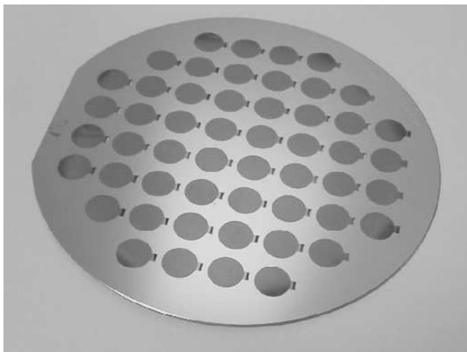
FIGURE 5.8 – Visualisation du substrat de silicium après micro-usinage.
