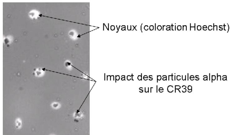
FIGURE 1.9 – Position relative des impacts des particules  $\alpha$  sur un plastic CR39 comparativement à la position des noyaux.
