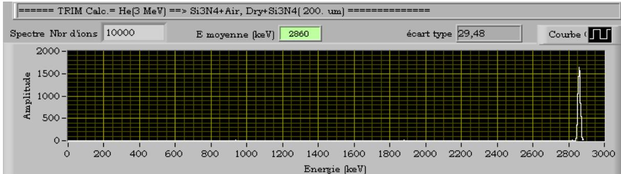
(a) Simulation Monte Carlo déterminant l'énergie résiduelle de particules alpha de 3 MeV après avoir traversé successivement la membrane en  $\text{Si}_3\text{N}_4$  de  $150 \mu\text{m}$  d'épaisseur, la couche d'air de  $200 \mu\text{m}$  puis la membrane en  $\text{Si}_3\text{N}_4$  de  $200 \mu\text{m}$ .
