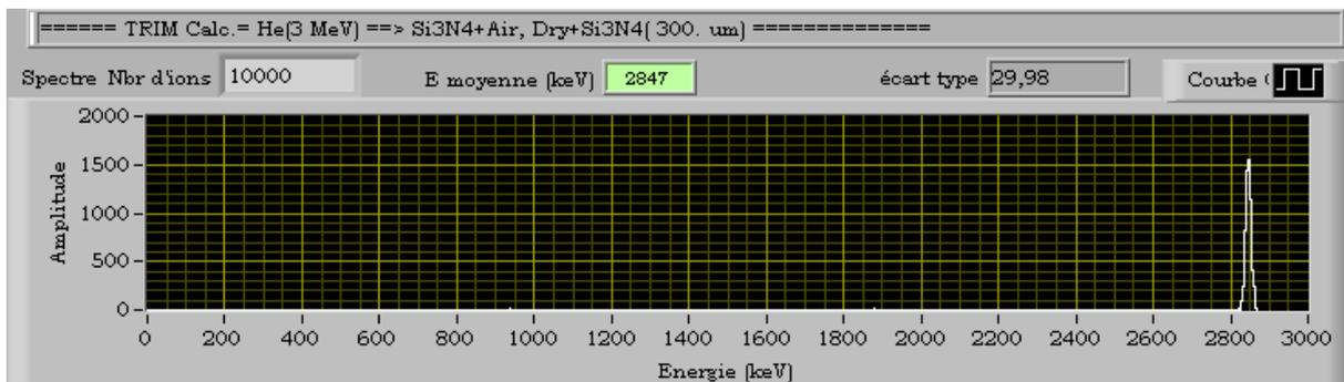
(b) Simulation Monte Carlo déterminant l'énergie résiduelle de particules alpha de 3 MeV après avoir traversé successivement la membrane en  $\text{Si}_3\text{N}_4$  de  $150 \mu\text{m}$  d'épaisseur, la couche d'air de  $300 \mu\text{m}$  puis la membrane en  $\text{Si}_3\text{N}_4$  de  $200 \mu\text{m}$ .
