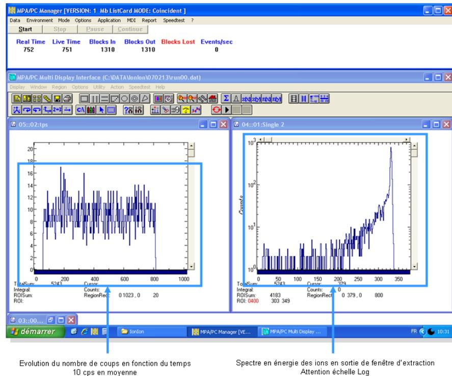
FIGURE 4 – Étalonnage du système d'irradiation. Mesure du flux de particules (à gauche) et de l'énergie des particules (à droite).
