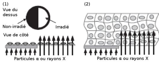
(a) Masque d'irradiation en ligne. La ligne d'irradiation a une largeur de  $120\ \mu\text{m}$ , l'impact des particules alpha peut être révélé par utilisation d'un détecteur CR39 (1) et dans le cas de rayons X, le détecteur en film Gafchromic HD-810 permet de révéler l'emplacement de l'irradiation (2).
