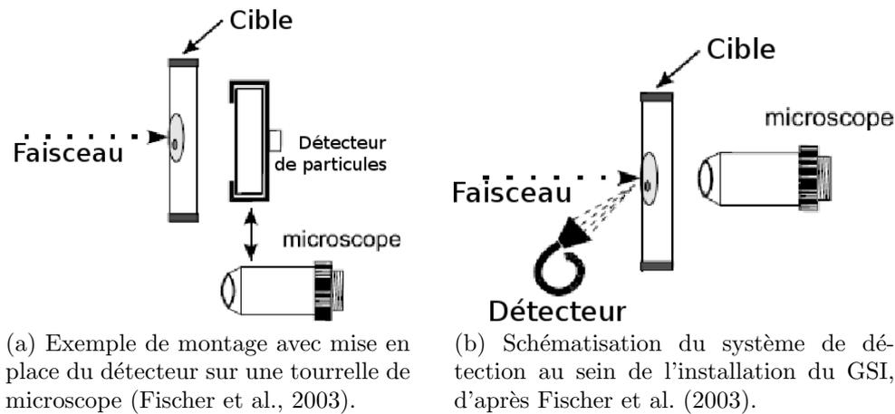
FIGURE 3.7 – Exemples de systèmes de détection.
