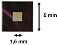
FIGURE 1.1 – Fenêtre en  $\text{Si}_3\text{N}_4$ , support de culture cellulaire (Silson). Le cadre de la fenêtre maintenant la membrane de  $\text{Si}_3\text{N}_4$  est de 5 mm de côté et une épaisseur de 200  $\mu\text{m}$ . La membrane en  $\text{Si}_3\text{N}_4$  a une dimension de 1,5 mm de côté et une épaisseur de 200 nm. La surface de la fenêtre d'irradiation est donc de 2,25  $\text{mm}^2$ .
