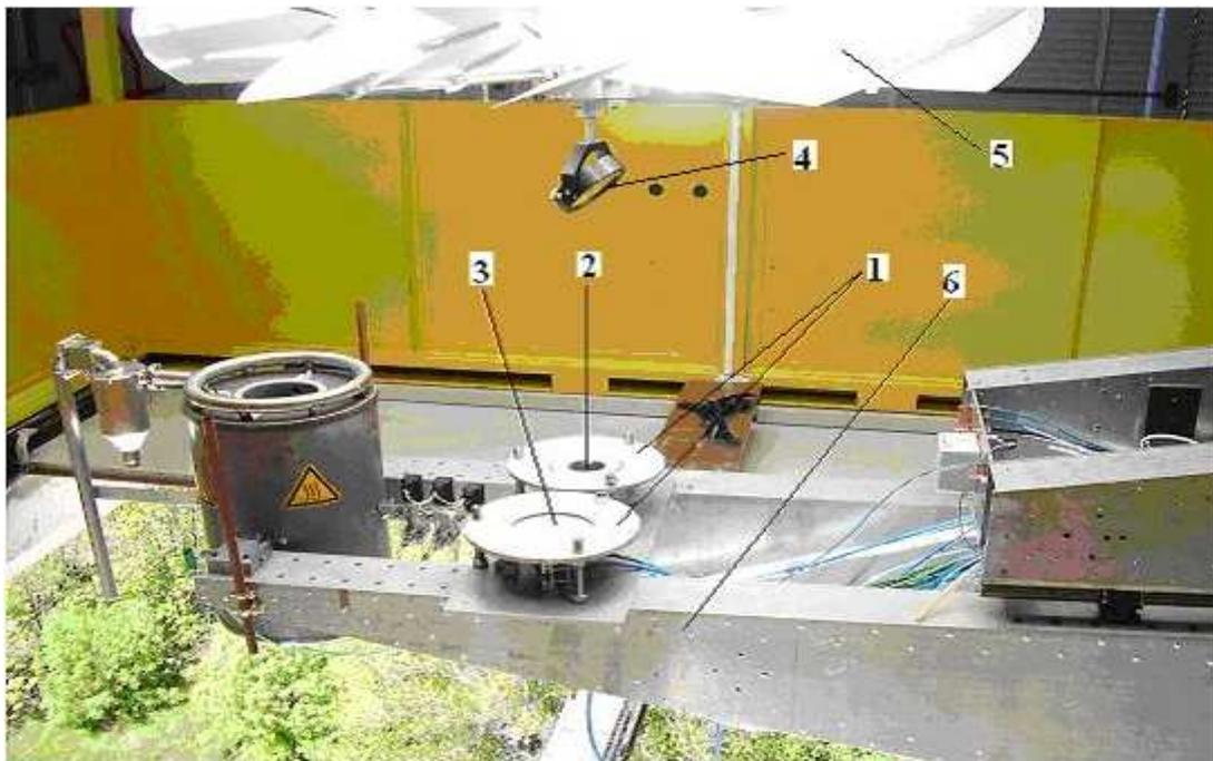
**Figure 72- Dispositif de mesure du flux solaire incident**
