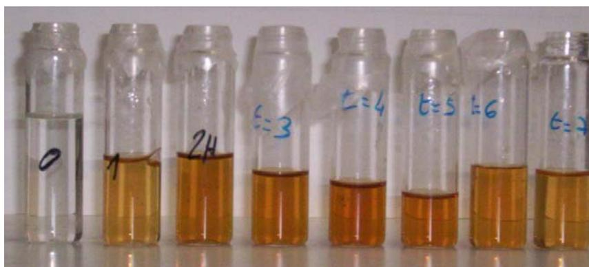
Figure III-2. Variation de la couleur des échantillons prélevés lors de l'électrolyse de 1 L de solution de H<sub>2</sub>SO<sub>4</sub> 0,1 M contenant 0,02 M de phénol dans une cellule sans séparateur. Débit = 200 L h<sup>-1</sup> ; Anode : PbO<sub>2</sub> (63,6 cm<sup>2</sup>) et cathode : Zr ;  $i = 47 \text{ mA cm}^{-2}$  ;  $i_{\text{lim}}^{\circ} = 108 \text{ mA cm}^{-2}$ .
