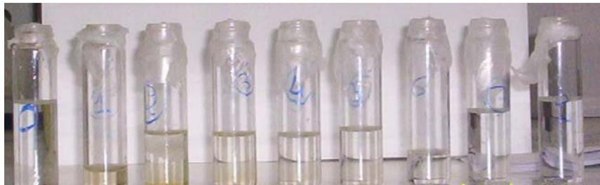
Figure III-5. Variation de la couleur des échantillons prélevés lors de l'électrolyse de 1 L de solution de  $H_2SO_4$  0,1 M contenant 0,02 M de phénol dans une cellule sans séparateur. Débit = 200 L h<sup>-1</sup>; Anode : DDB (63,6 cm<sup>2</sup>) et cathode : Zr ;  $i = 47 \text{ mA cm}^{-2}$ ;  $i_{lim}^o = 108 \text{ mA cm}^{-2}$ .
