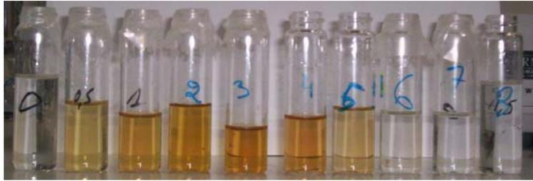
Figure III-7. Variation de la couleur des échantillons prélevés lors de l'électrolyse de 1 L de solution de H<sub>2</sub>SO<sub>4</sub> 0,1 M contenant 0,02 M de phénol dans une cellule sans séparateur. Débit = 200 L h<sup>-1</sup>; Anode : PbO<sub>2</sub> (63,6 cm<sup>2</sup>) et cathode : Zr ;  $i = 142 \text{ mA cm}^{-2}$ ;  $i_{\text{lim}}^{\circ} = 108 \text{ mA cm}^{-2}$ .
