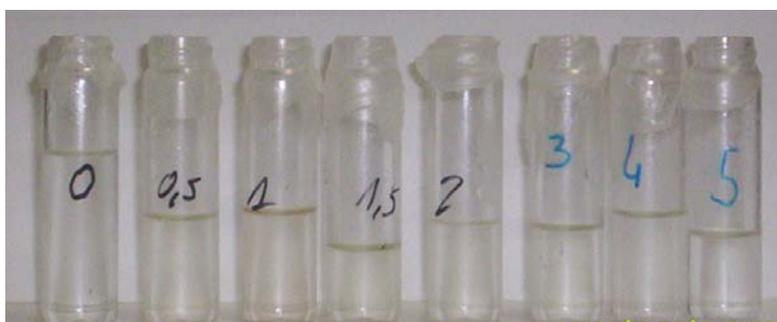
Figure III-10. Variation de la couleur des échantillons prélevés lors de l'électrolyse de  $1 \text{ L}$  de solution de  $\text{H}_2\text{SO}_4$   $0,1 \text{ M}$  contenant  $0,02 \text{ M}$  de phénol dans une cellule sans séparateur. Débit =  $200 \text{ L h}^{-1}$ ; Anode : DDB ( $63,6 \text{ cm}^2$ ) et cathode : Zr ;  $i = 142 \text{ mA cm}^{-2}$ ;  $i_{\text{lim}}^{\circ} = 108 \text{ mA cm}^{-2}$ .
